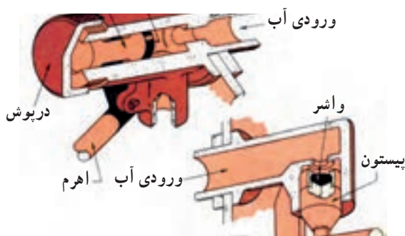
شکل ۱۱۳-۲ اجزای شیر شناور
