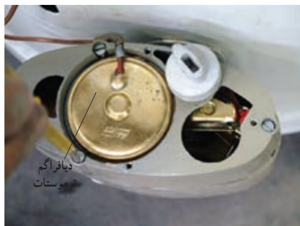
شکل ۵۵-۱- ب - دیافراگم ترموستات
