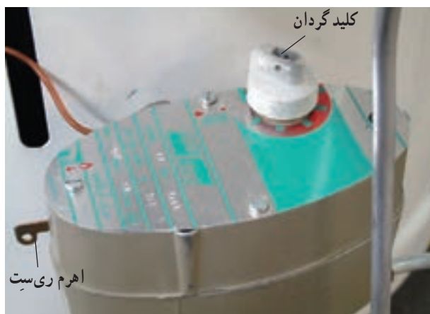
شکل ۱-۳۸- کاربراتور آب گرمکن نفت سوز
