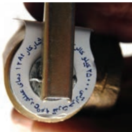
شکل ۲-۱۰۸- شیر اطمینان فشاری و حرارتی
