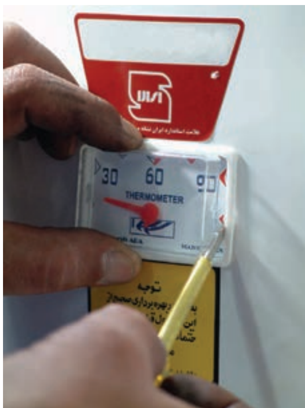
شکل ۱۱۶-۱ جدا کردن ترمومتر
