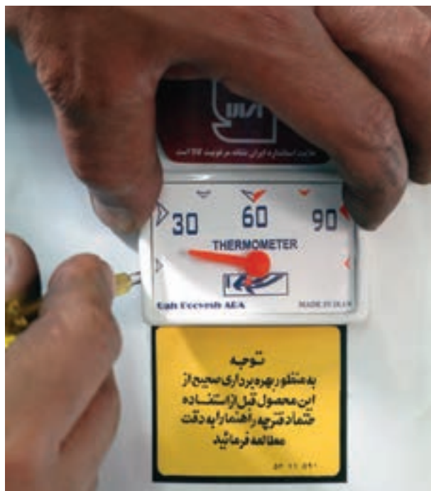
شکل ۱-۱۱۷ جدا کردن ترمومتر از روپوش
