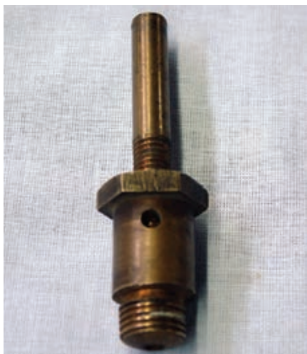
شکل ۱-۳۲- شیر قطع و وصل مخزن سوخت
