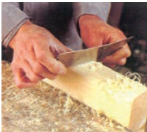
شکل ۲۹-۲. برای لیسه کاری، لیسه را کمی خم کرده روی سطح چوب هدایت کنید.
