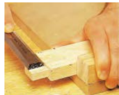
شکل ۹-۹۸- اندازه کردن زبانه با مغار.
