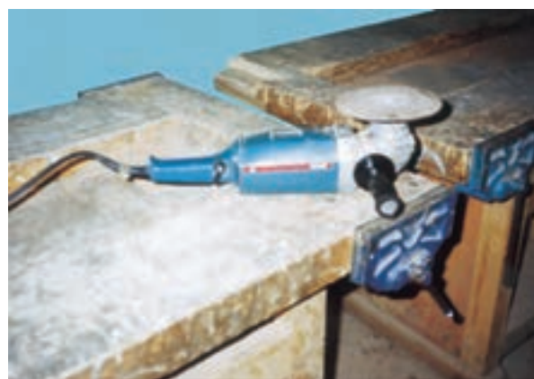
شکل ۷-۴۲- چگونگی قرار ایمنی دستگاه سنباده بشقاب‌بی روی میز کار.
