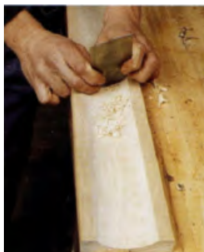
شکل ۲-۵- کاربرد لیسه با لبه‌ی نیم گرد.
