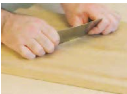
شکل ۲-۱۳- جهت حرکت لیسه، هنگام پُرزگیری.
