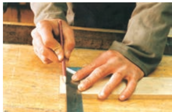
شکل ۹-۶۳. فم کشی ممل اتصال با گونیا.
