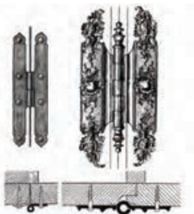
شکل ۱۰-۲۲- یک نوع لولای پروانه ای تزئینی؛ با مقطع نصب شده.
