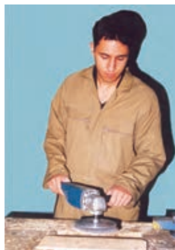
شکل ۷-۴۰- هدایت و کنترل صمیع دستگاه سنباده.
