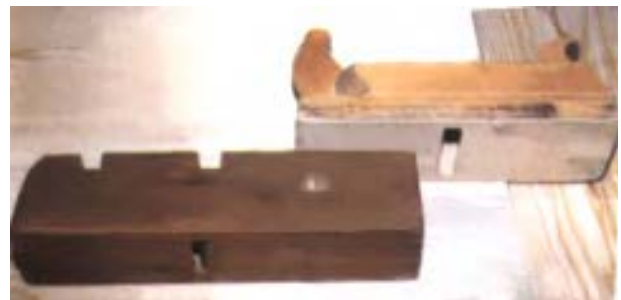
شکل ۲-۱۷- پس از پایان کار، رنده ها به پهلو خوابانده شود.
