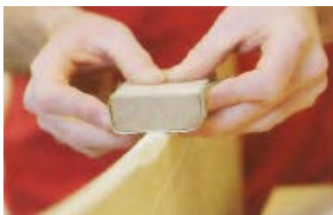
شکل ۳-۲۱. طریقه‌ی سنباده‌کاری نر قطعات با دو دست.
