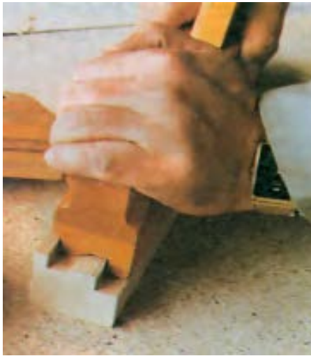
شکل ۴-۱۰- رنده دستی افزار (پروفیلی)، برای تهیه‌ی زهوار تزئینی.
