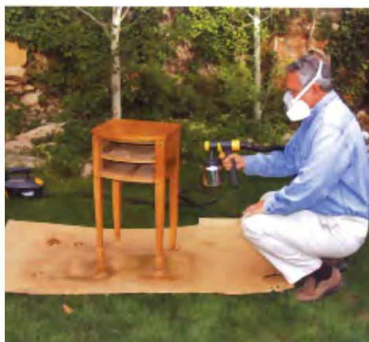
شکل ۲۳-۴. رنگ‌کاری با پیستوله (رنگ پوششی).
