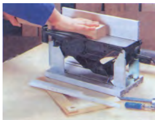
شکل ۱۱-۲۱- یک رو و یک نر کردن چوب کلاف در.
