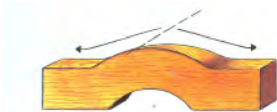
شکل ۲-۳۳. رندیدن در جهت الیاف.
