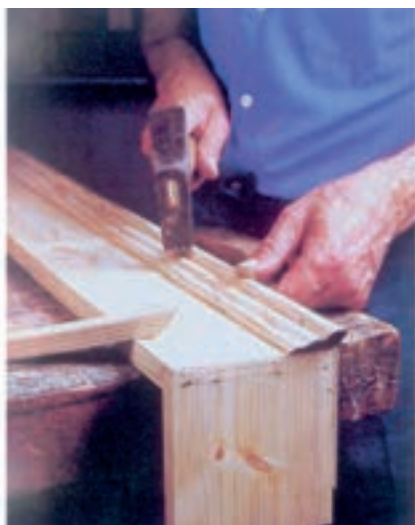
شکل ۱۰-۱۳- نصب زهوار با میخ.
