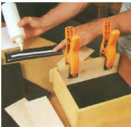
شکل ۱-۴۱. برای بستن قطعات ناژک، باید از گیره‌ی انبری استفاده نمود.
