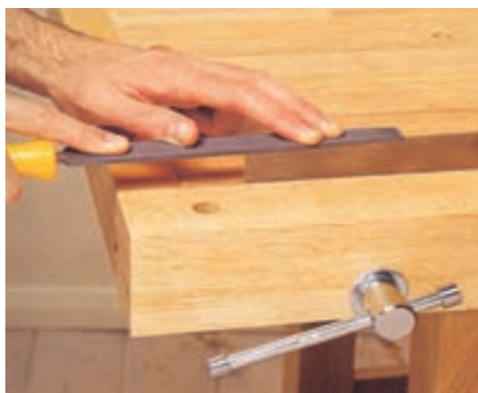
شکل ۲-۷- نمونه‌ی سوهان زدن ضخامت لیسه.
