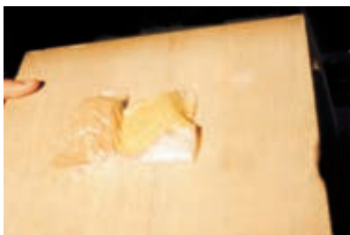
شکل ۴-۱۰- بتونه را می توان داخل نایلون نگه داری نمود تا ماندگاری بیشتری داشته و خشک نشود.
