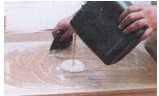
شکل ۶-۴. پخش کردن چسب به وسیله‌ی شانه‌ی چسب‌زنی.
