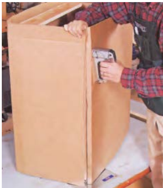
شکل ۸-۲۲- کاربرد منگنه‌ی دستی در بسته‌بندی کالاها.
