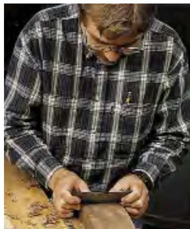
شکل ۲-۳۰. پرداخت سطوح قوس دار به وسیله لیسه.
