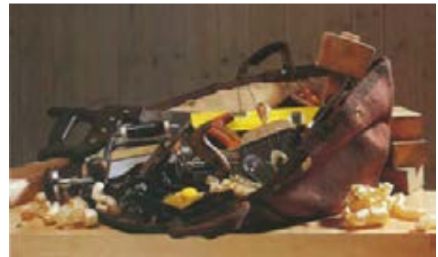
شکل ۲-۱۶- ریختن ابزارها روی هم، علاوه بر کاهش تیزی، از دقت آنها نیز می کاهد.
