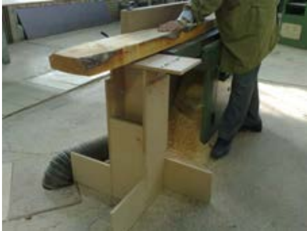
شکل ۹-۱۴- کاربرد میز کمکی برای ماشین کفرند.
