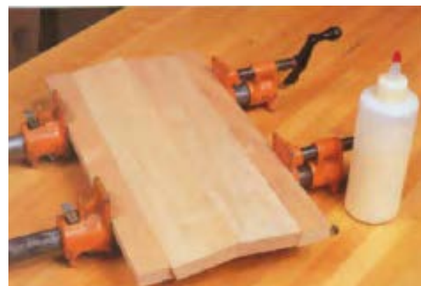
شکل ۱-۴۵- هنگام چسباندن تفت‌های درز شده به وسیله‌ی تنگ، نباید فشار تنگ، بیش از حد باشد، زیرا تفت‌ها قوس بر می‌دارد.
