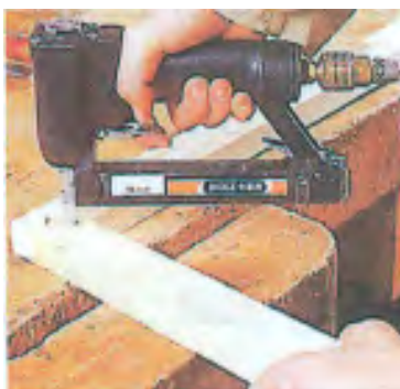
شکل ۸-۳- منگنه زدن گوشه های فارسی با منگنه زن بادی.
