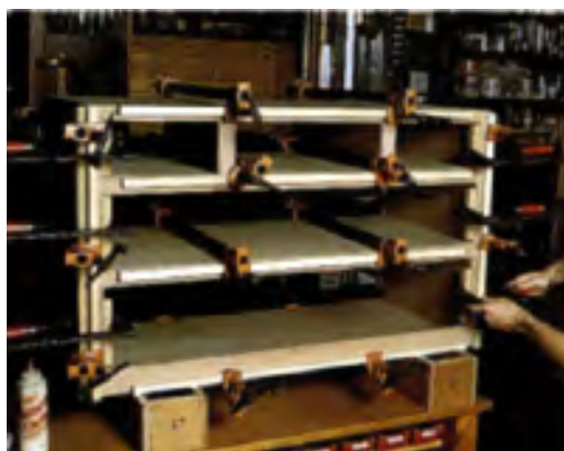
شکل ۱-۵۰- هنگام مونتاژ کابینت‌ها می‌توان برای محکم کردن و گرفتن دوئیدگی، از تنگ و پیچ‌دستی در جهات افقی و عمودی استفاده نمود.
