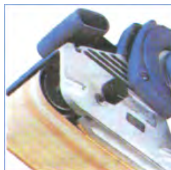
شکل ۷-۶- با این پیچ می‌توان غلتک جلو را حرکت داد.
