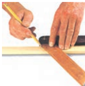
شکل ۱۰-۱۰- فم‌کشی زهوار، با زاویه‌ی ۴۵ درجه.
