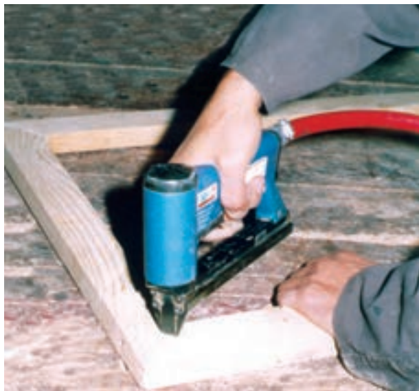
شکل ۸-۱۶- منگنه زدن روی درزهای ۴۵ درجه شده.
