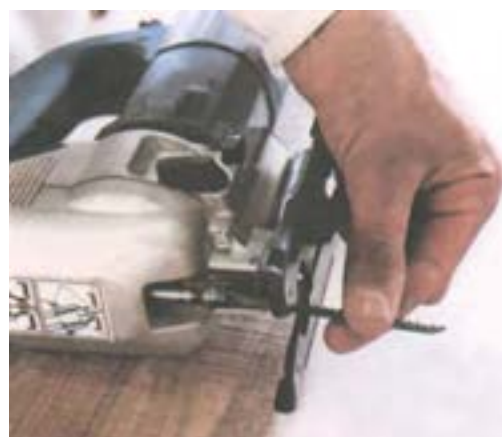
شکل ۱۵-۴۱ تعویض تیغه اره.
