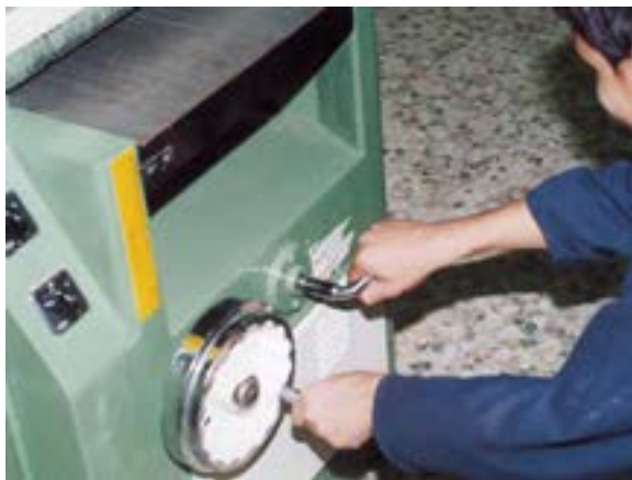
شکل ۷-۳۴ تنظیم مقدار بار گندگی.
