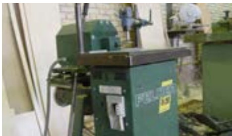
شکل ۹-۹ - گیره، برای ممکن کردن چوب (روی صفحه).
