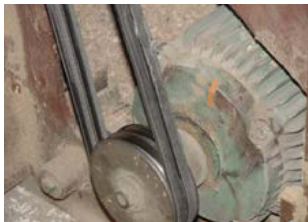
شکل ۱۰-۴- الکتروموتور ماشین کفرنده.
