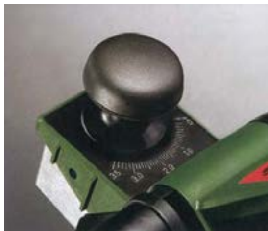
شکل ۴- ۱۴- پیچ تنظیم صفحه برای پوشالبرداری
