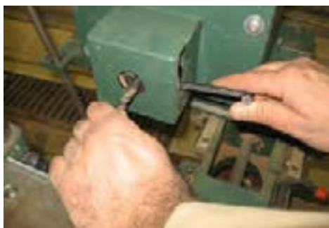
شکل ۹-۱۷- ممکم کردن مته داخل سه‌نظام.
