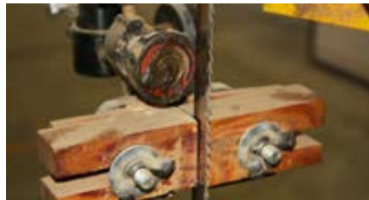
شکل ۳-۲. گریس‌کاری بلبرینگ تیغه اهره.
