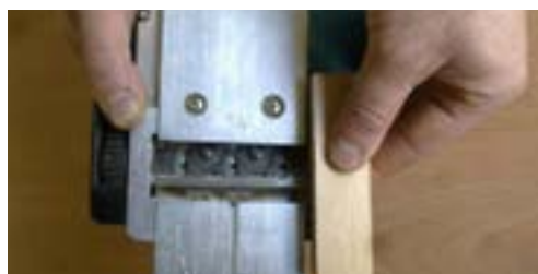
شکل ۱۴-۲۵- استقرار تیغه در شیار.
