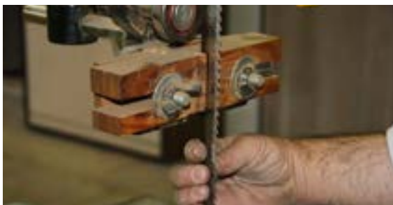
شکل ۳۴-۱- کنترل‌های لازم تیغه قبل از کار.
