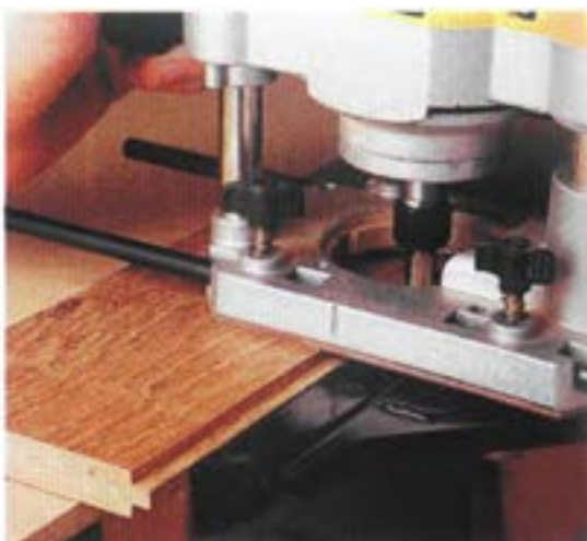
شکل ۱۶-۴ - دوراهاه زدن، با دستگاه اورفرز.
