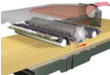
شکل ۸- ۷- غلتک آبدار، توپی تیغه‌ها و غلطک صاف.
