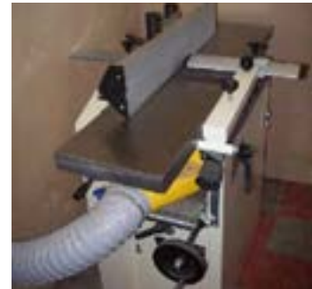
شکل ۴-۲۲ - مکنده‌ی قابل اتصال به ماشین کفرند.
