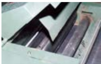
شکل ۲۲-۷- برداشتن درپوش تیغه‌ها.
