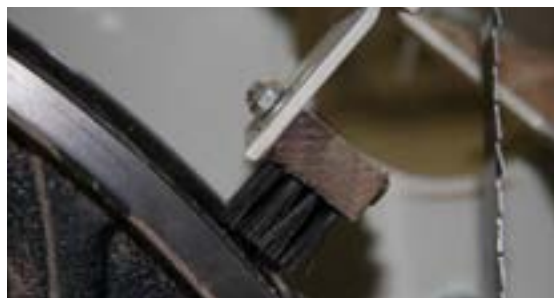
شکل ۸-۱- برس غبارگیری روی بانداژ فلک‌ها.
