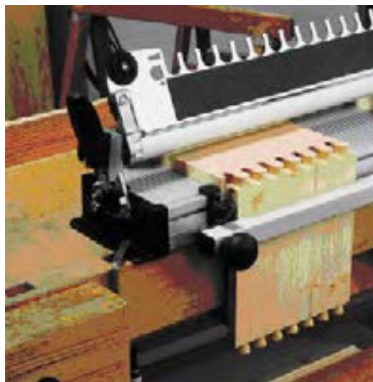
شکل ۱۶-۵. اتصال دم چلچله و انگشتی.
