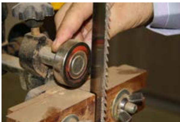
شکل ۳۰- ۱- کنترل بلبرینگ پشت تیغه.
