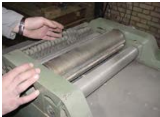
شکل ۷-۲۹- کنترل تمیزی شانه‌ها.
