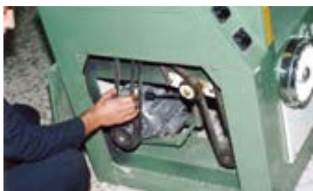
شکل ۲۶-۷- کنترل سفتی تسمه‌ی انتقال نیرو.
