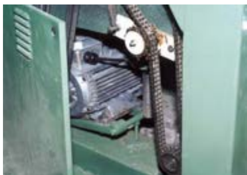
شکل ۸-۱۴- باز کردن درپوش برای (روغن کاری).
