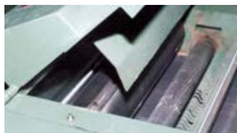
شکل ۷-۱۲. حفاظ توپی تیغه‌ها و غلتک‌ها
