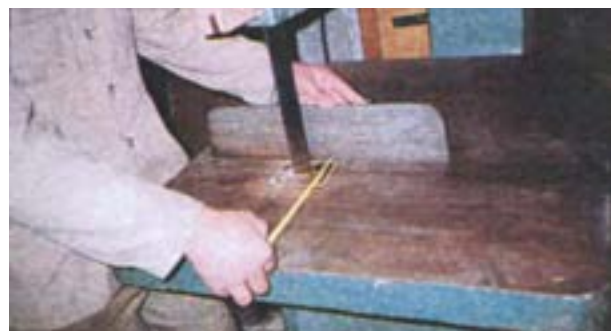
شکل ۱۴۳-۱- اندازه‌گیری فاصله‌ی تیغه با گونیا.
