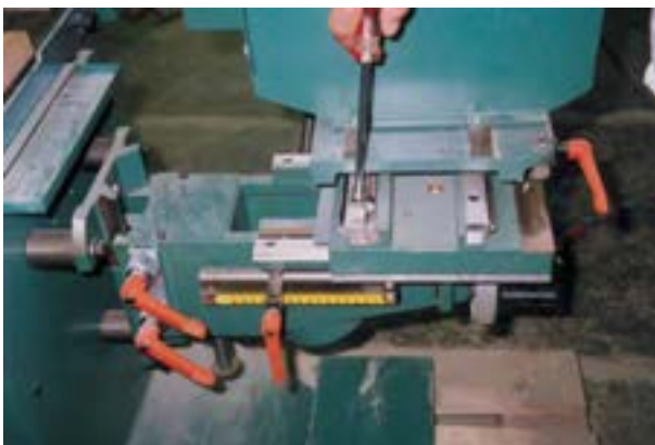
شکل ۱۴-۱۰. کنترل پیچ‌های دستگاه هدایت.
