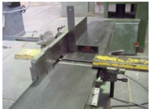
شکل ۳۰-۴. کنترل گونیای ماشین.
