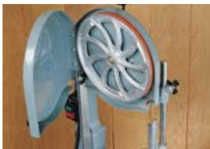
شکل ۴-۲. حفاظ باز شده‌ی روی فلکه و تیغه.
