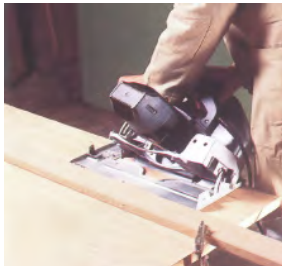
شکل ۱۳-۱۶ صفحه‌ی دستگاه تمت زاویه تنظیم شده است.
