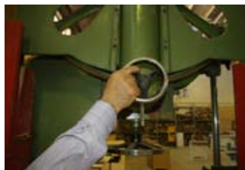
شکل ۷-۲- تنظیم لبه‌ی تیغه اره با لبه‌ی فلک توسط فرمان مربوطه.
