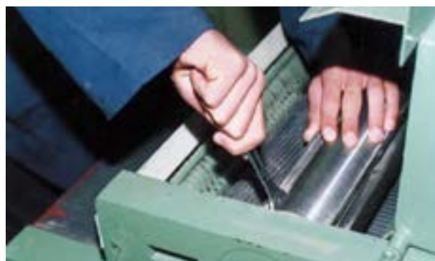
شکل ۲۴-۷- نمونه‌ی بستن تیغه‌ها به توپی.
