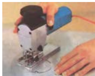
شکل ۱۵-۲۵- دایره‌بُری بدون گونیا (ممل دایره قبلاً با پرگار مشخص شده است).
