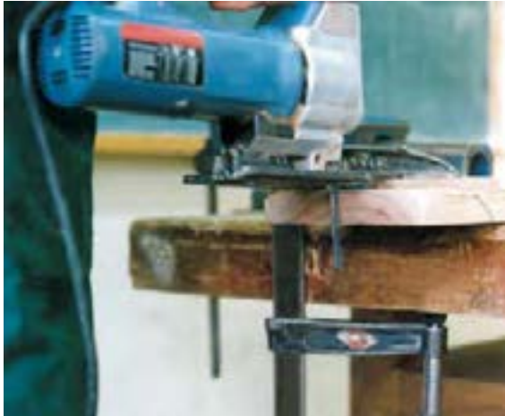
شکل ۱۵-۳۵. صفحه، کاملاً روی چوب قرار نگرفته است.
