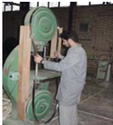
شکل ۶-۲- نمونه‌ی جا انداختن تیغه اره.
