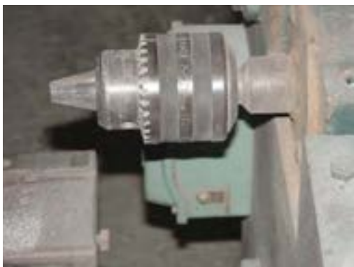
شکل ۹-۵ - سه نظام در ماشین گُم‌کنی.
