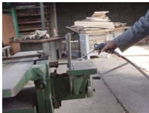
شکل ۱۰-۱۹ - غبارگیری ماشین کُمن‌کنی.
