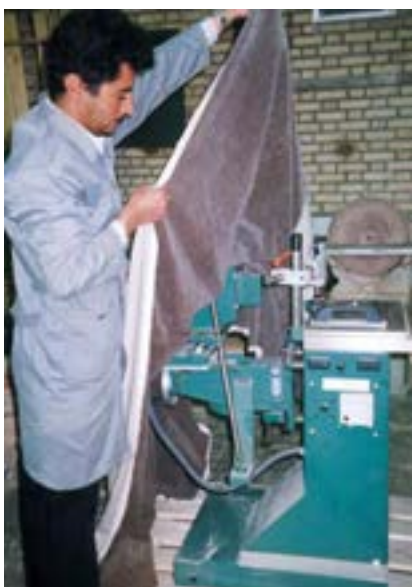
شکل ۱۸-۱۰- نمونه‌ای پوشاندن ماشین از نفوذ گرد و غبار.
