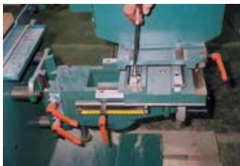
شکل ۱۰-۲۱ - سفت کردن پیچ‌های شُل شده.
