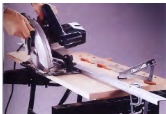
شکل ۱۳-۱۴ برش با استفاده از تکیه‌گاه.
