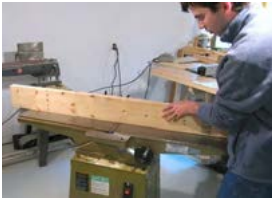
شکل ۴-۲۴ - پس از (ندیدنِ نر)، باید نرِ چوب را نیز رنده کرد.
