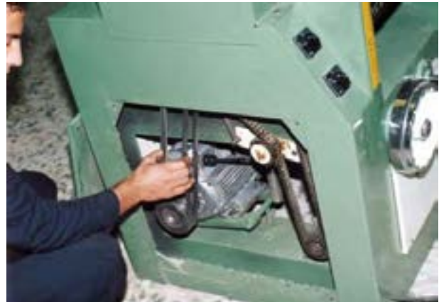
شکل ۸-۸- کنترل مقدار کشش تسمه‌ها.
