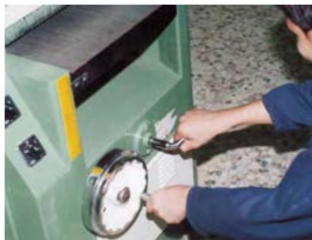
شکل ۱۹-۷- تنظیم صفحه و ممک نمودن اهرم مربوطه.
