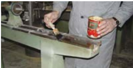
شکل ۱۱-۴۵- تمیزکاری قسمت‌های ضروری و بدون رنگ ماشین.
