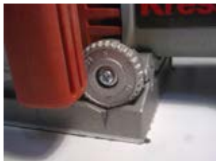
شکل ۱۷-۵- پیچ تنظیم عمق شیار.
