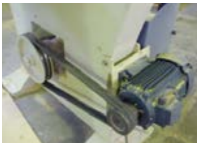
شکل ۳-۴. انتقال نیرو توسط تسمه.
