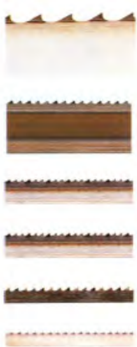
شکل ۱-۴۸. فرم‌های مختلف دندانه‌ی اره‌نواری.
