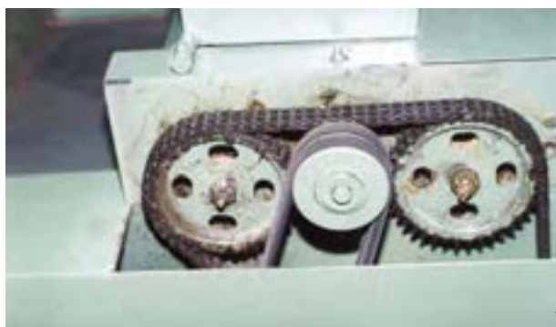
شکل ۱۸-۷- زنجیر انتقال نیرو و قدرت به غلتک‌ها.
