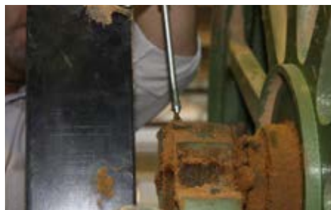
شکل ۳-۱۳. گریس کاری یاتاقان فلکه اره.
