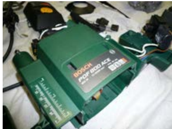
شکل ۱۶-۹- بدنه یا جلد دستگاه اورفرز.
