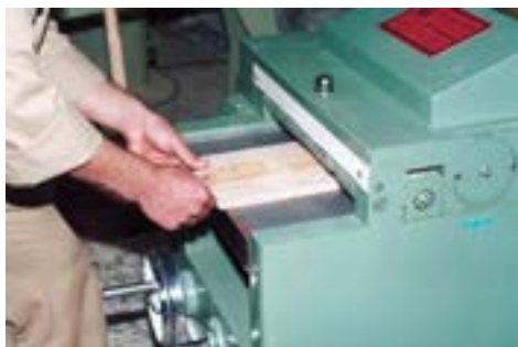
شکل ۳۷-۷. نمونه‌ی رندیدن چوب نازک.
