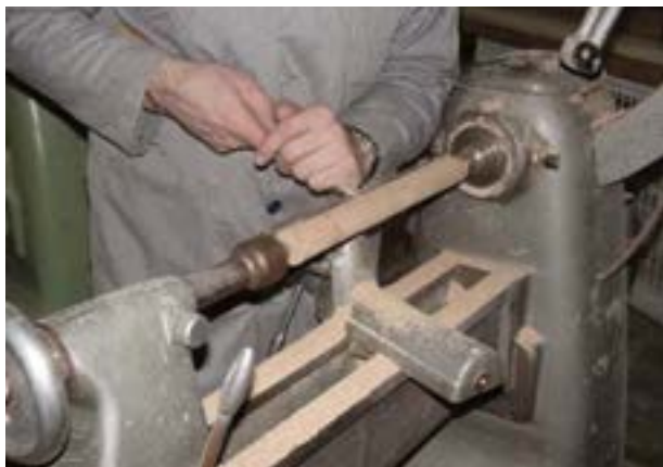
شکل ۱۱-۲۷- نمونه‌ی قرار گرفتن مغار گلویی هنگام فراطی.
