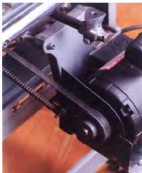
شکل ۱۲-۳۳- تسمه‌ی انتقال نیرو و حرکت.
