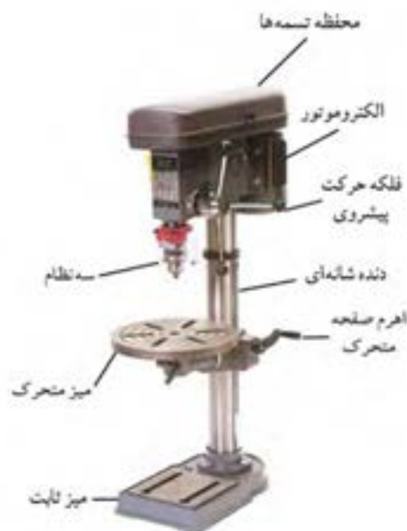
شکل ۱۹-۴- دریل ستونی پایه دار و قسمت های آن.
