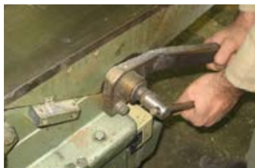
شکل ۱۳-۵- تنظیم مقدار بار.
