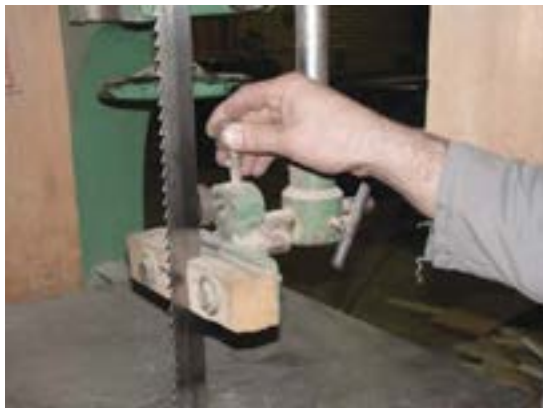
شکل ۵۲-۱- نمونه‌ی تنظیم فاصله‌ی بلبرینگ با پشت تیغه.
