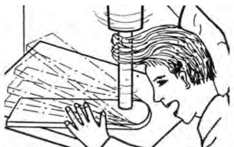
شکل ۱۹-۲۶- درگیر شدن مته با موی سر.
