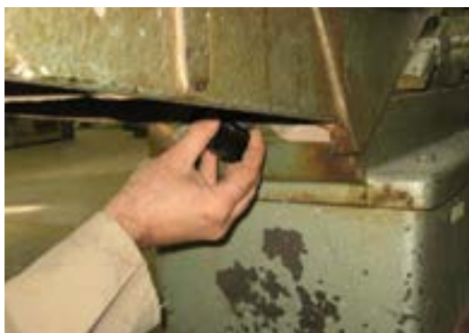
شکل ۹-۴- اهرم ثابت کننده‌ی صفحه.
