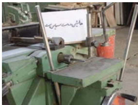
شکل ۱۰-۸- تابلوی هشدار سرویس‌کاری.
