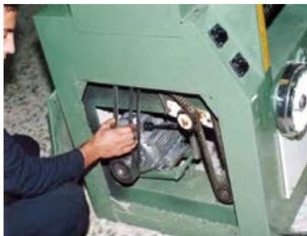
شکل ۸-۱۶- کنترل تسمه‌های انتقال نیرو
