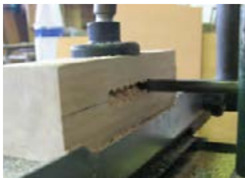
شکل ۹-۳۸ - برداشتن فاصله‌ی دو سوراخ.
