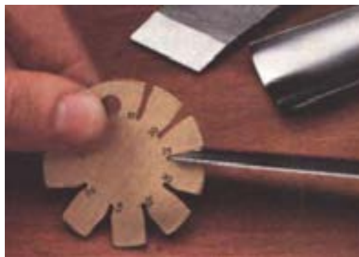
شکل ۵-۴- شابلن مخصوص کنترل زاویه‌ی رنده.
