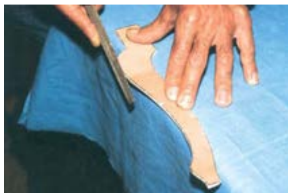
شکل ۱۸-۲۲ نمونه‌ی پرداخت کردن مسیر برش.
