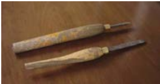
شکل ۱۱-۲۰- نمونه‌ای از مغارهای با دسته‌ی معیوب.
