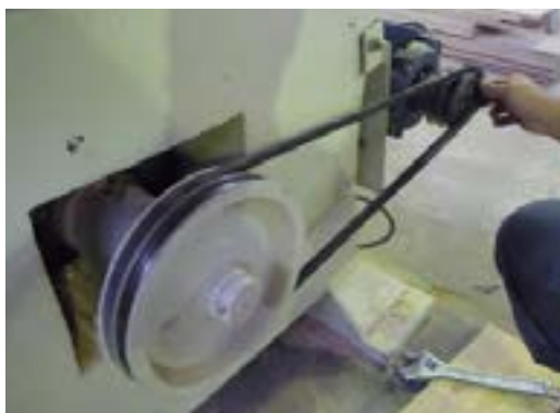
شکل ۳-۱۶. تعویض تسمه فرسوده.
