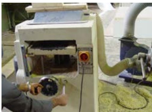
شکل ۷-۴۶- تنظیم بار تیغه به اندازه‌ی مورد نیاز.
