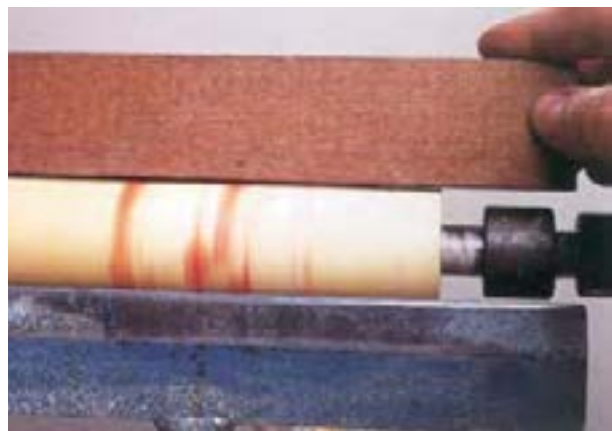
شکل ۱۱-۵۱- کنترل صافی قطعه چوب گرد شده.
