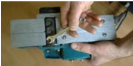
شکل ۱۴-۲۳- خارج کردن تیغه‌ها از جایگاه.
