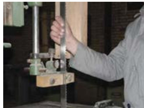
شکل ۵۱-۱- کنترل سفتی تیغه به کمک دست.
