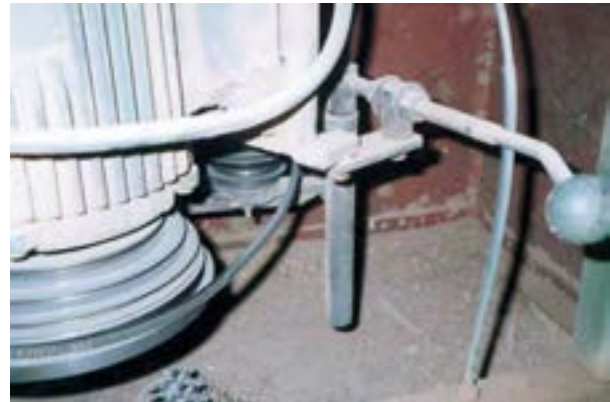
شکل ۱۱-۴- فارغ کردن تسمه از پولی.
