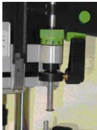
شکل ۱۶-۱۳- درمهی تعیین ارتفاع تیغه.
