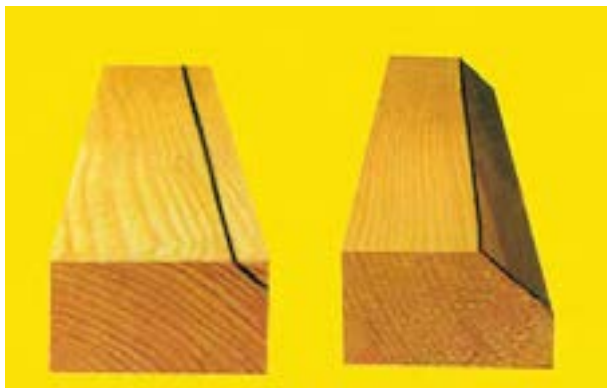
شکل ۳۰-۱۴. چوب فطاکشی شده و پغ فورده. فط ترسیمی، تا آفرین لمظه باقی می‌ماند.
