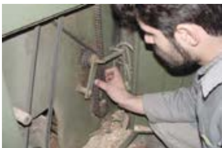
شکل ۲۷-۷- تنظیم و آزمایش سفتی (زنجیر انتقال نیرو).
