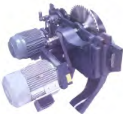
شکل ۱۲-۷. الکتروموتور و سیستم انتقال نیرو.
