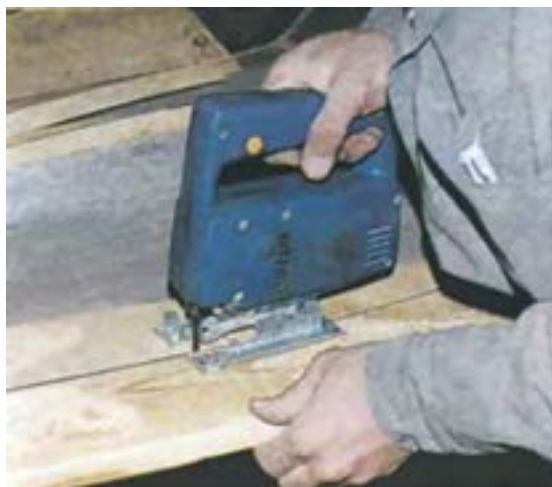
شکل ۱۵-۱۹- برش طولی چوب بدون استفاده از گونیا.
