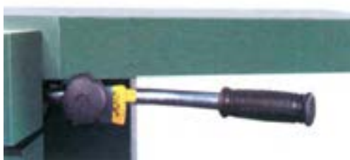
شکل ۸-۴- اهرم تنظیم بار صفحه‌ی کفرند.
