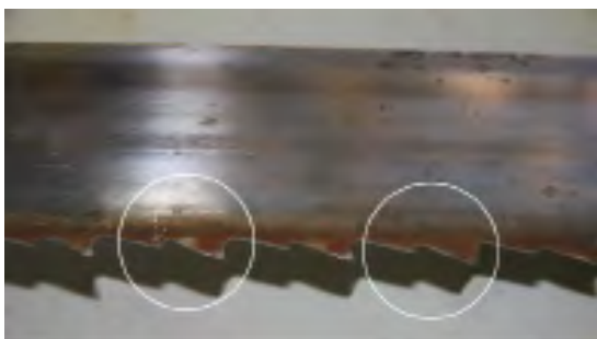
شکل ۱-۶۷- فاصله (گام) دندانه‌ها کم و زیاد شده است.
