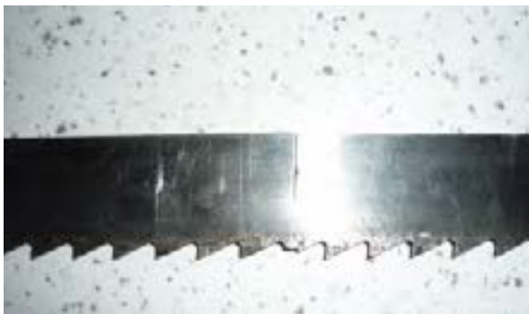
شکل ۷۰-ا- ترک تیغه اره از محل جوش.
