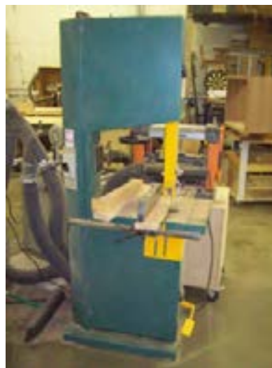
شکل ۹-۱. یک ماشین اره‌نواری، با حفاظ کامل.
