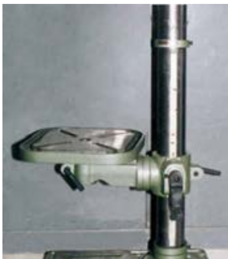
شکل ۱۹-۱۴. صفحه‌ی متحرک دریل ستونی.
