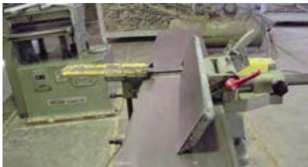
شکل ۴-۳۴. تنظیم زاویه ۴۵ درجه گونیای رنده.
