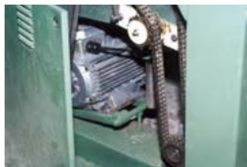
شکل ۷-۱۳. حفاظ تسمه، زنجیر، الکتروموتور و ...
