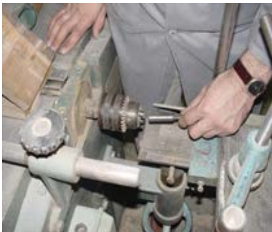
شکل ۷-۱۰- خارج کردن مته از سه‌نظام.
