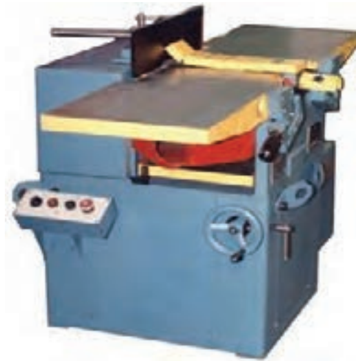
شکل ۴-۳۲. ماشین رنده با حفاظ.
