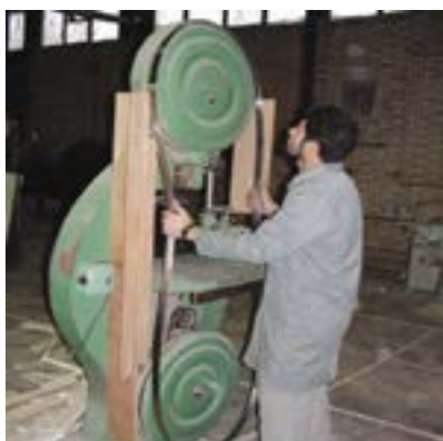
شکل ۵-۲. خارج کردن تیغه اره از (روی فلکه‌ها).
