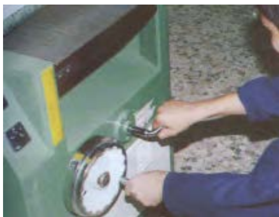
شکل ۵۱-۷. تثبیت بالابر، پس از تعیین اندازه.
