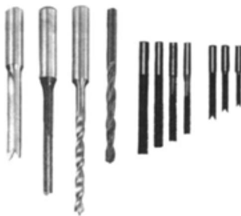
شکل ۹-۱۱ - انواع مته‌های مخصوص کُم کنی.
