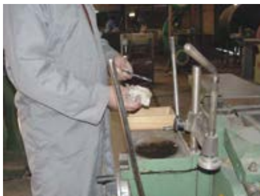
شکل ۵-۱۰- (روغن‌کاری و تمیز کردن مته‌ها).
