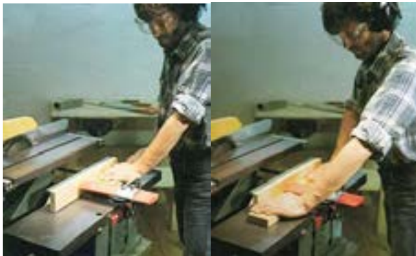
شکل ۱۴۴-۱- گونیایی کردن پوچ قبل از برش.
