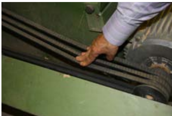
شکل ۱-۲۲-۱ تنظیم سفتی تسمه
