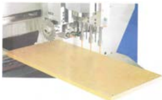
شکل ۵- CNC سوراغ‌کاری و برش‌کاری MDF.
