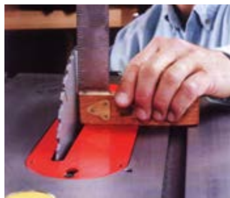
شکل ۱۲-۲۲. کنترل و تنظیم گونیایی بودن تیغه.
