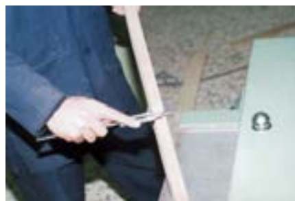
شکل ۴۸-۷. کنترل ضخامت چوب گندگی شده، با کولیس.
