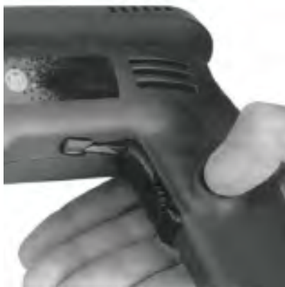
شکل ۱۹-۴۳- رها کردن کلید و کار دائم دریل.
