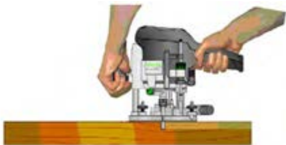
شکل ۱۶-۲۶. دوراهاه زدن قطعه کار با دستگاه اورفرز.
