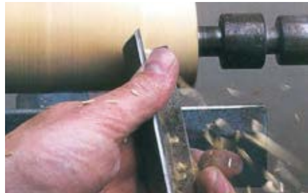
شکل ۱۱-۵۰- گرد کردن نهایی چوب با مغار گلولی.
