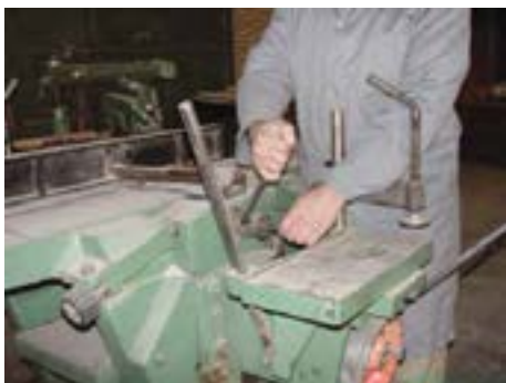
شکل ۹-۱۲ - قراردادن مته در سه نظام.
