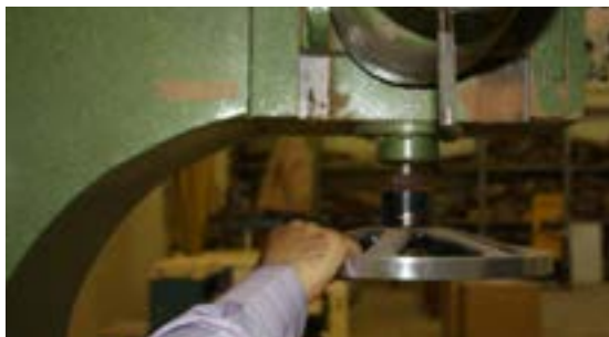
شکل ۳۳-۱- شل کردن تیغه اره.
