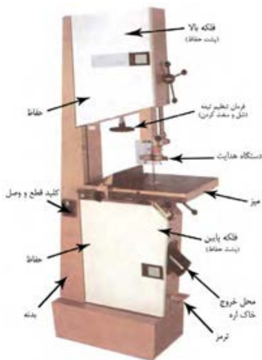
شکل ۴۱-۱. قسمت‌های مختلف یک ماشین اره‌نواری.
