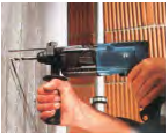
شکل ۱۹-۵۱- دریل با میله‌ی عمق‌سنج.
