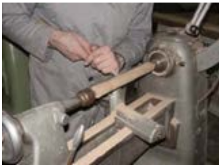
شکل ۱۱-۶۱- گرد کردن کامل قطعه چوب هشت ضلعی.
