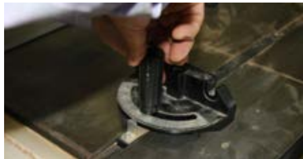
شکل ۱-۵۸-۱ برش عرضی چوب به وسیله‌ی گونیای متمرک (عرضی).
