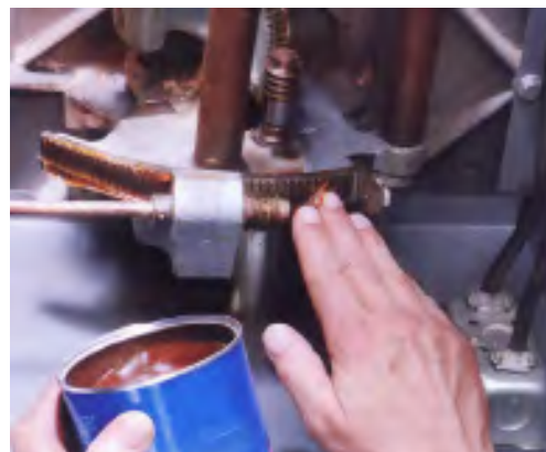
شکل ۱۲-۳۹. گریس‌کاری پرف دنده‌ها.
