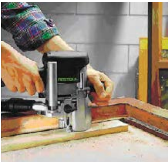
شکل ۱۶-۷. برداشتن قسمت اضافی سه لایه.
