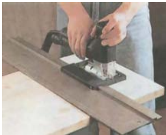
شکل ۱۵-۲۰- برش عرضی چوب به کمک ریل راهنما.
