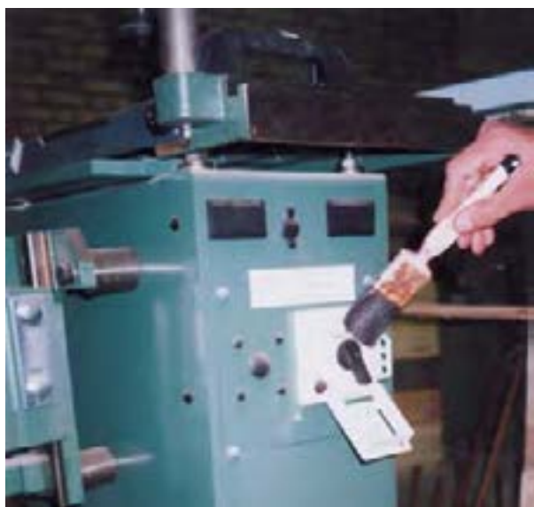
شکل ۱۵-۱۰. گردگیری و تمیز کردن کلید برق.
