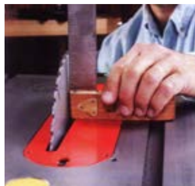
شکل ۱۶-۱۲. کنترل زاویه‌ی تیغه.
