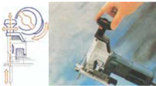
شکل ۱۵-۴۲ تعویض تیغه اره.
