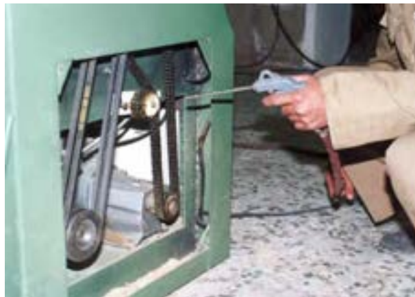
شکل ۸-۱۵- بادگیری دافل قسمت انتقال نیرو.
