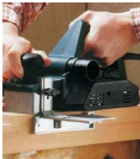
شکل ۱۴-۳۲. تنظیم گونبای سمت چپ رنده
