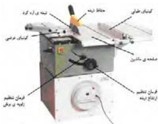
شکل ۱۲-۱ ماشین اره گرد میزی یا مجمعه‌ای.
