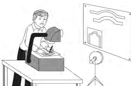
شکل ۱۷-۱۸. نمونه‌ی بزرگنمایی تصویرها با پروژکتور آورهد.
