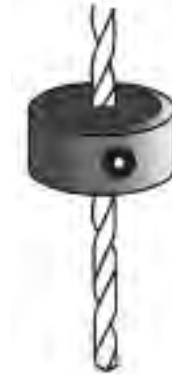
شکل ۱۹-۵۳- قطعه به جای میله‌ی عمق سنج.
