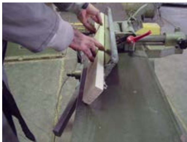
شکل ۳۵-۴- رنده کردن نر چوب با زاویه ۴۵ درجه.
