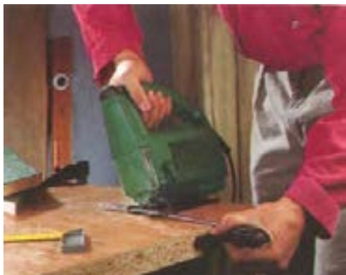
شکل ۱۵-۲۲- نمونه‌ی برش تحت زاویه به کمک گونیای اره پکشی.
