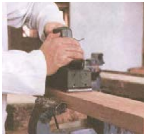
شکل ۱۷-۱۴- نمونه‌ی بستن چوب دافل گیره
