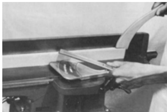
شکل ۱۷-۴ الف - رنده کردن انتهای چوب‌های باریک.
