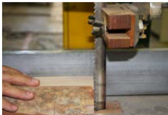
شکل ۳۲-۱- شرایط ایمنی دست، هنگام کار با اره.
