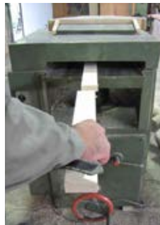
شکل ۷-۳۲ روش صحیح وارد کردن چوب.
