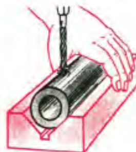
شکل ۱۹-۳۸- سوراخ‌کاری جسم استوانه‌ای.
