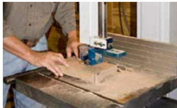
شکل ۱-۳۵-۱. فاصله‌ی ارتفاع سطح چوب با دستگاه هدایت.
