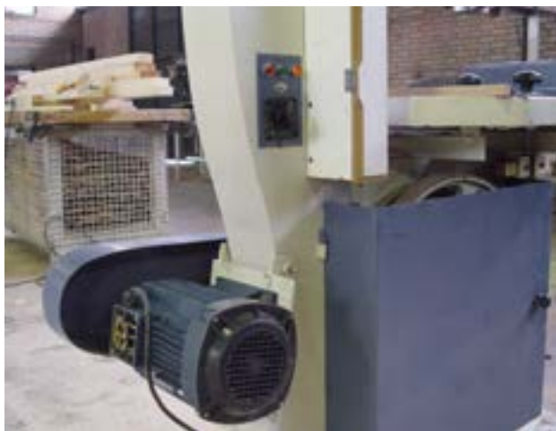
شکل ۲۷- ۱- الکتروموتور تک فاز با فازن راه انداز.
