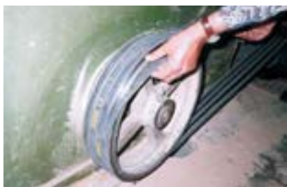
شکل ۹-۳. چگونگی تعویض تسمه.
