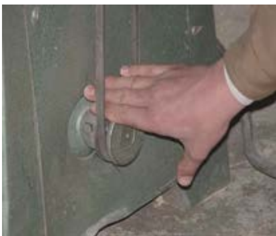
شکل ۶-۱۰- مراقبت از انگشتان به هنگام تعویض تسمه.
