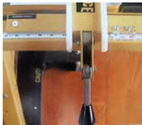
شکل ۱۲-۲۳. تنظیم اندازه‌ی برش.
