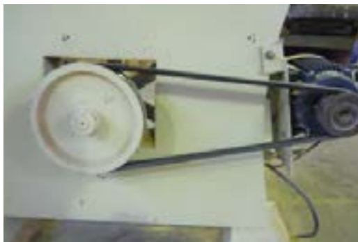
شکل ۳-۱۷. استقرار تسمه در دافل پرف تسمه.
