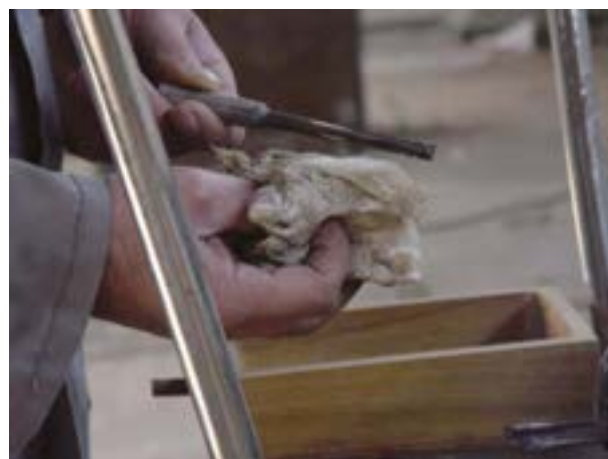
شکل ۱۶-۱۰- تمیز کردن مته‌های خارج شده از ماشین.
