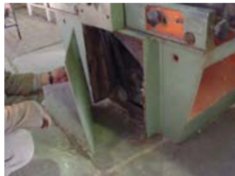
شکل ۹-۶ حفاظ تسمه در جای خود قرار گیرد.
