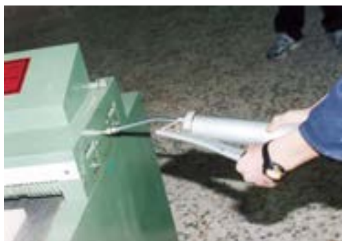
شکل ۸-۱۳- گریس کاری یاتاقان های ماشین.
