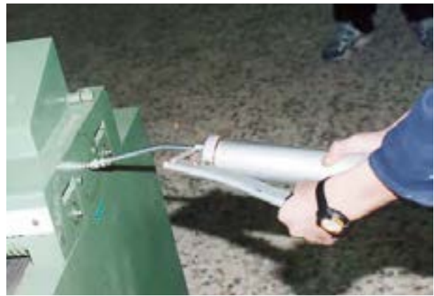
شکل ۸-۱. گریس کاری بلبرینگ یاتاقان ها.
