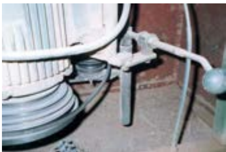
شکل ۳-۱۵. اهرم الکتروموتور، آزاد است.
