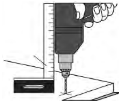
شکل ۱۹-۵۵- سوراخ کاری عمودی.
