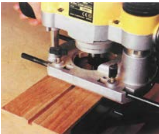
شکل ۱۶-۳- کنشکاف زدن، با دستگاه اور فرز.
