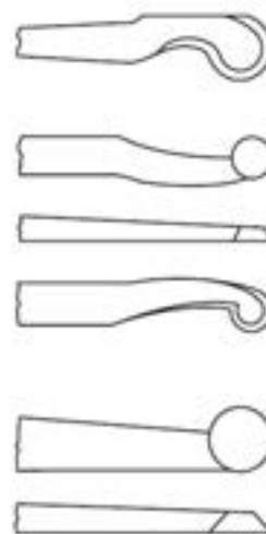
شکل ۱۱-۱۷- مغارهای مخصوص سطوح مقعر و فضاهای داخلی.
