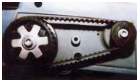
شکل ۹-۱۴- وضعیت قرار گرفتن تسمه روی پیرغ‌دنده.
