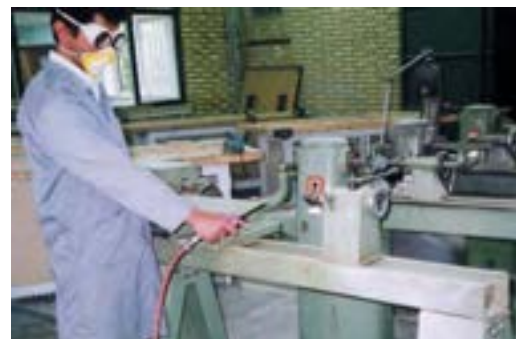
شکل ۱۱-۴۴- گردگیری و نظافت ماشین فراطی.
