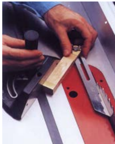
شکل ۱۲-۲۰- تنظیم زاویه‌ی تیغه
