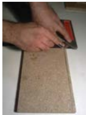
شکل‌های ۱۴-۱۷- ابتدا باید یک خط طولی ترسیم کرد و سپس در محل قرار هر زبانه، یک خط عمودی کشید.
