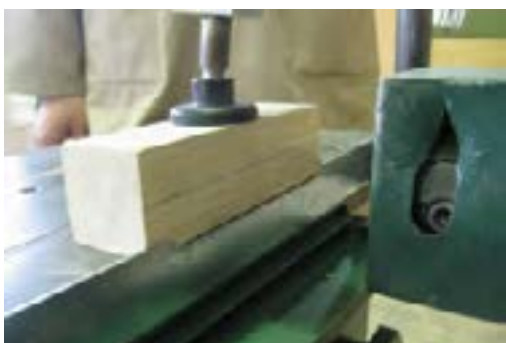
شکل ۹-۱۶- نمونه‌ی قرار دادن چوب (روی صفحه).
