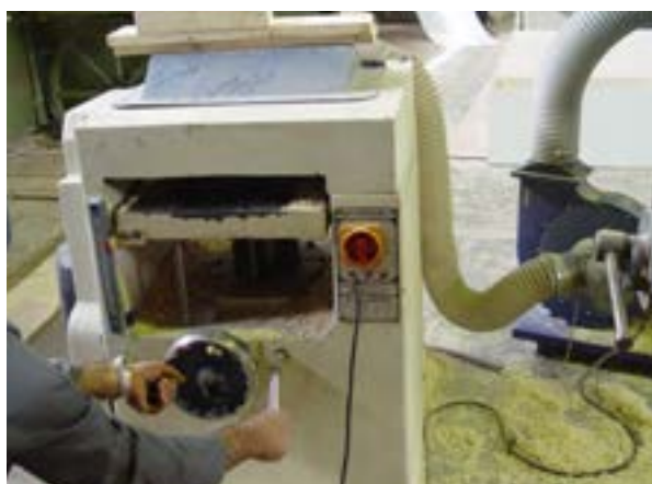
شکل ۷-۴۰- تنظیم دهانه‌ی گندگی.
