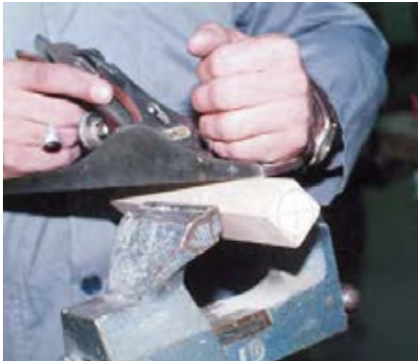
شکل ۱۱-۲۴- پخ زدن گوشه‌های تیز چوب.
