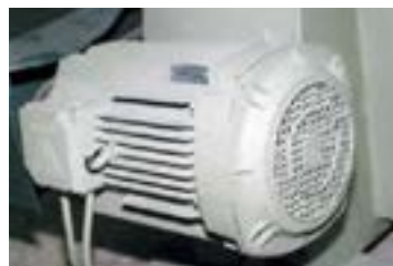
شکل ۵-۱۱- الکتروموتور سه فاز یک ماشین خراطی.
