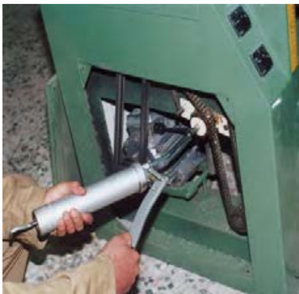
شکل ۸-۷- گریس‌کاری ممورهاى انتقال نیرو.
