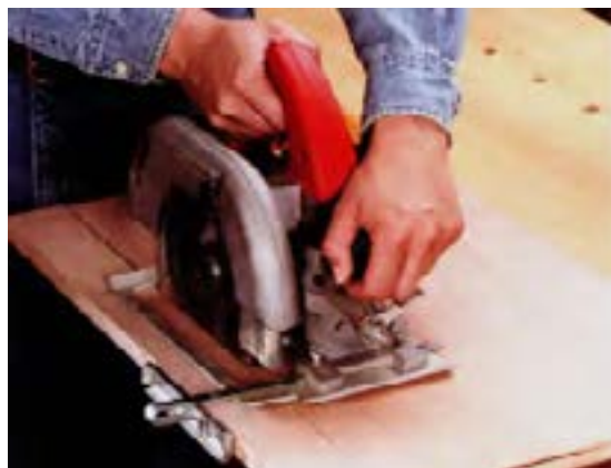
شکل ۱۳-۱۶ برش با استفاده از گونیای ماشین.
