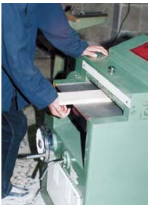
شکل ۷-۴۲- روش ایمنی هدایت چوب به داخل ماشین.
