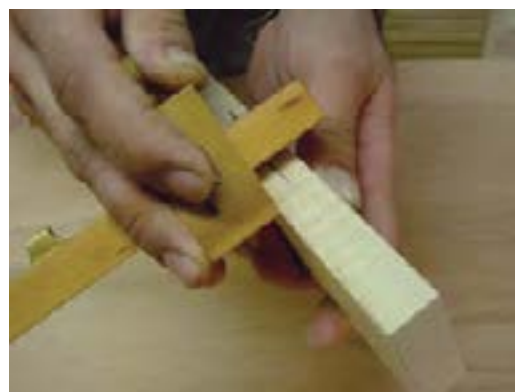
شکل ۹-۱۵- تعیین وسط نر چوب به‌وسیله‌ی فک‌کش تیره‌دار.
