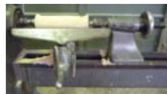
شکل ۱۱-۳۰. تبدیل چوب چهارتراش به استوانه به کمک مغار گلولی.
