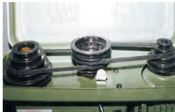
شکل ۱۹-۱۳. تغییر دور پله‌ای در دستگاه دریل ستونی.
