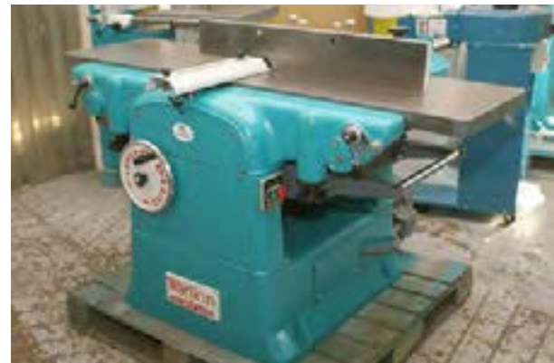
شکل ۴-۴- ماشین کفرند با بدنه چدنی.
