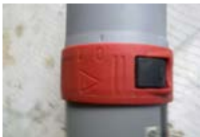
شکل ۱۷-۷ - کلید قطع و وصل دستگاه فرز بیسکوییتی
