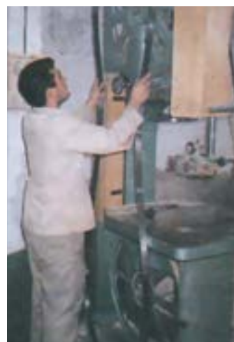
شکل ۱۰-۲- نمونه‌ی فارچ کردن تیغه اره.
