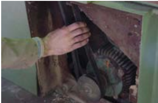
شکل ۱۳-۴- سفتی تسمه را بررسی کنید.
