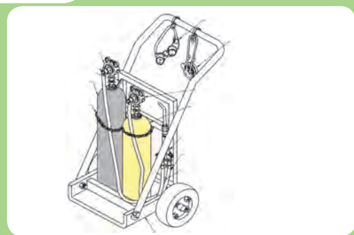
گاری مخصوص حمل کپسول‌های گاز در کارگاه
