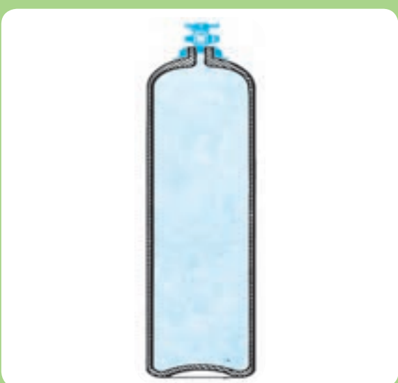
کپسول فولادی مخصوص برای ذخیره اکسیژن
