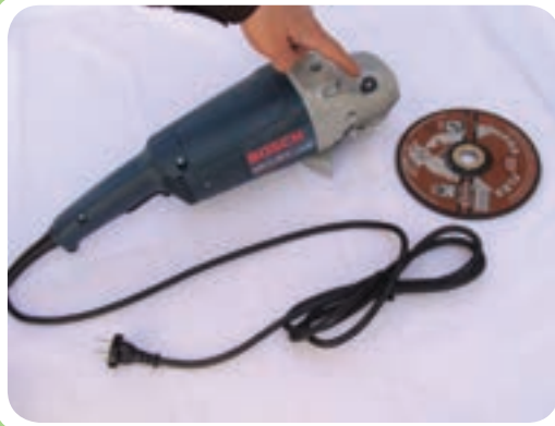
کلید مخصوص قفل کردن محور سنگ
