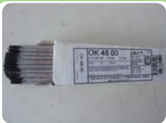
نمونه‌ای از الکترودها با روپوش قلیایی
