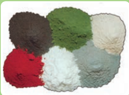
مواد پودری تشکیل دهنده روپوش الکترود
