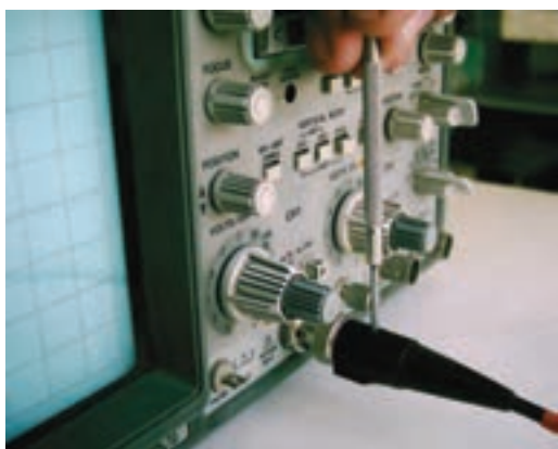
شکل ۸-۶ نحوه‌ی تنظیم پروب
