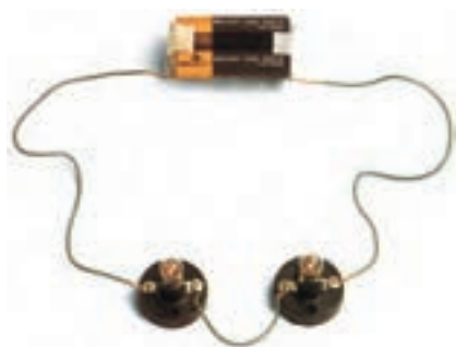
شکل ۲-۲۹ مدار واقعی دو لامپ به صورت سری
