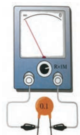
شکل ۷-۵۱ خازن قطع است
