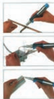
شکل ۳-۴۱ هویه‌ی گازی با نوک قابل تعویض
