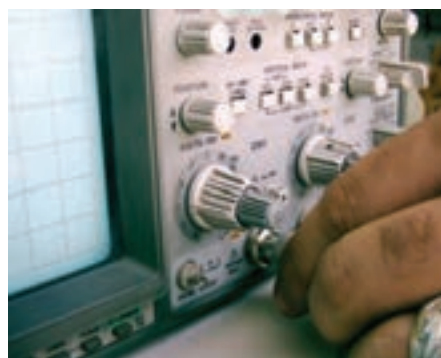
شکل ۶-۶ نحوه‌ی اتصال BNC به اسیلوسکوپ
