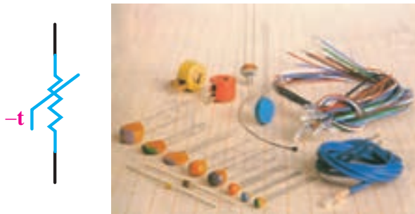
شکل ۱۱-۲ چند نمونه از مقاومت های NTC و علامت اختصاری آن
