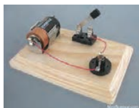
شکل ۱-۳۰ یک مدار الکتریکی ساده
