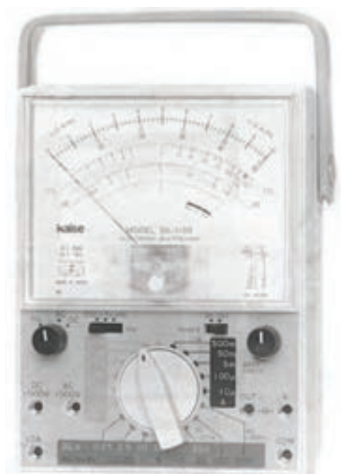
شکل ۲۲-۲ یک نمونه مولتی متر عقربه‌ای (آنالوگ)
