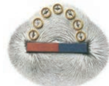
شکل ۳-۸ اثر میدان مغناطیسی روی قطب نما و براده‌های آهن
