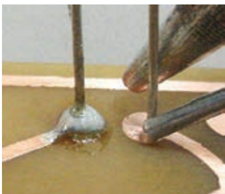
شکل ۷-۱۰ مونتاژ قطعات روی فیبر
