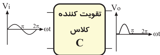
شکل ۳-۶ تقویت کننده کلاس C
