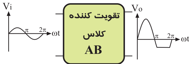
شکل ۳-۵ تقویت کننده کلاس AB
