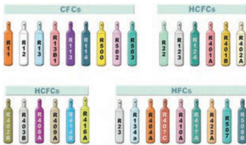
شکل ۱۸-۸- رنگ سیلندرهای سرمازاها مصنوعی
