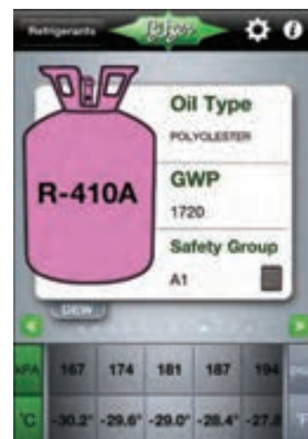
شکل ۱۷-۸- نمونه نرم افزار مربوط به یک سرمازا که بر روی گوشی تلفن همراه نصب می‌شود.
