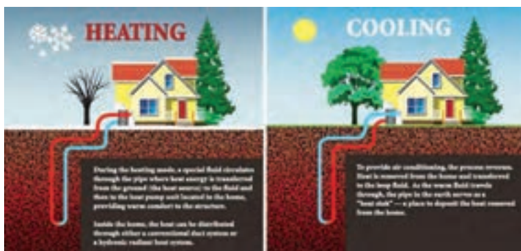
شکل ۱۱-۱۱ - پمپ گرمایی دو فصلی در یک ساختمان
