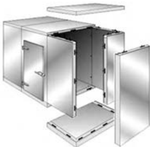
شکل ۲۲-۱ اجزاء پیش ساخته سردخانه
