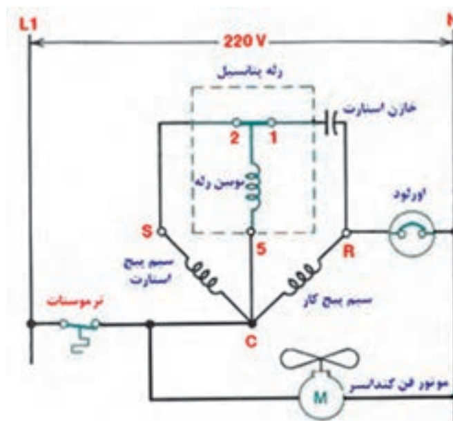
شکل ۱۸-۱۰ مدار الکتریکی آب سردکن
