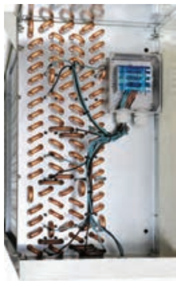
شکل ۶-۱۱- محل نصب هیترهای مورد نیاز
