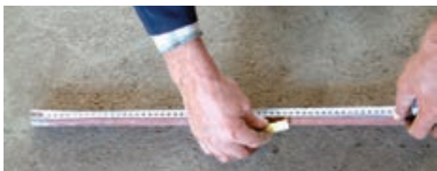
شکل ۳-۵۴ خط کشی لوله و تعیین محل‌های خم
