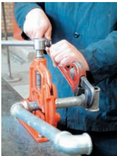
شکل ۵-۱۰۳- نحوه ی صحیح سفت کردن فیتینگ به لوله
