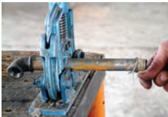
شکل ۵-۱۵۳- خمیر و کنف کردن سردنده‌ی بعدی
