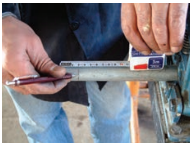
شکل ۷-۱- علامت‌گذاری کردن لوله با متر و مداد
