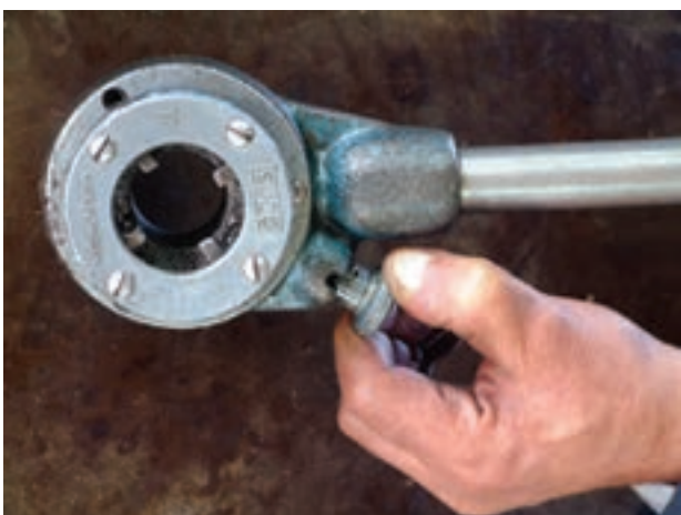
شکل ۴-۴۳- خارج کردن ضامن از شيار
