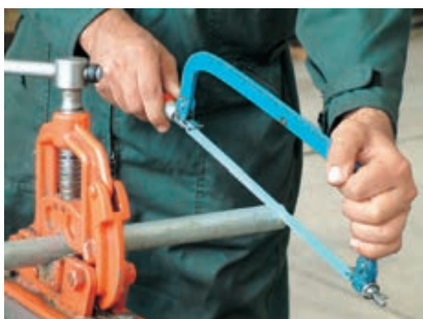
شکل ۵۰-۱- عدم رعایت فاصله‌ی مناسب از لب گیره
