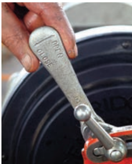
شکل ۴-۹۷ — کشیدن ضامن تنظیم به عقب
