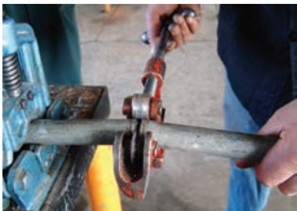
شکل ۳-۵۲ بریدن لوله‌ی محاسبه شده
