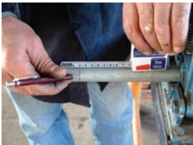
شکل ۱-۵۳- مشخص کردن محل برش
