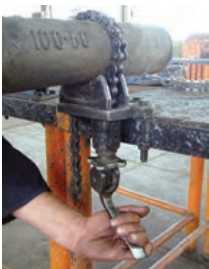
شکل ۱-۳۳- کشیدن اهرم قفل‌کننده
