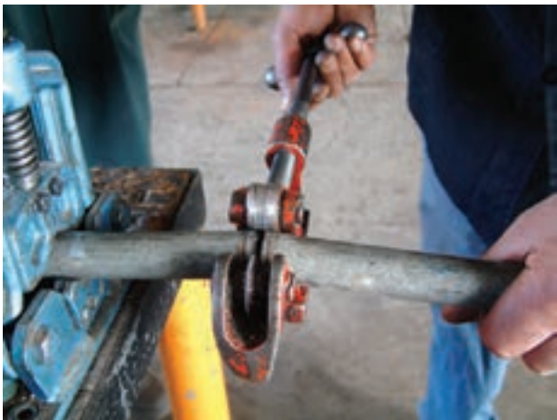
شکل ۱-۵۹- انتهای عمل بُرش‌کاری
