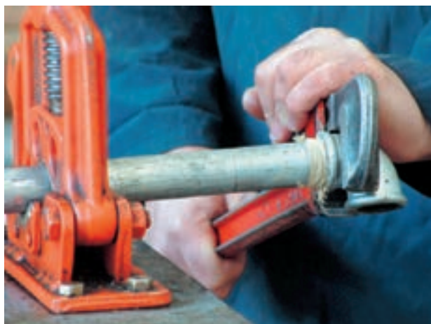
شکل ۵-۹۲- سفت کردن فیتینگ به وسیله‌ی آچار لوله‌گیر
