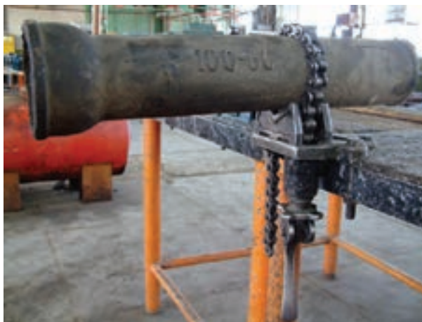
شکل ۱-۳۴- بستن لوله به گیره‌ی زنجیری
