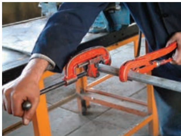
شکل ۱۱۶-۵- ادامه‌ی برش‌کاری لوله
