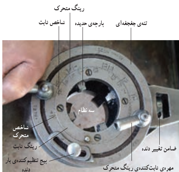
شکل ۴-۵۵- اجزای حدیده‌ی دستی چهارپارچه
