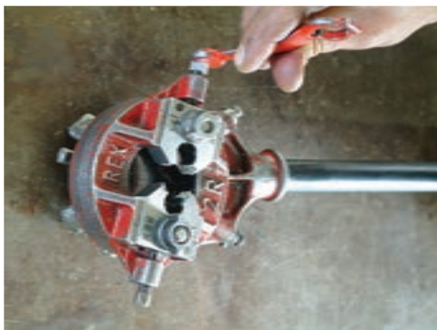
شکل ۲۰-۴- اجزای حیدیه دستی دو پارچه
