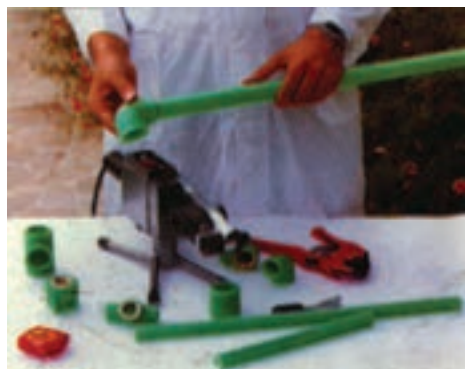
شکل ۵-۲۹- اتصال لوله و فیتینگ پلی‌پروپیلنی پس از خنک شدن
