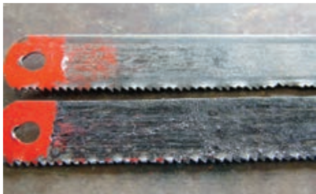
شکل ۱-۴۷- تیغه اره‌های دندان‌ها شکسته شده
