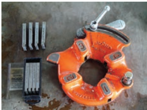
شکل ۸۸-۴- تنه‌ی حدیده و پارچه‌های آن
