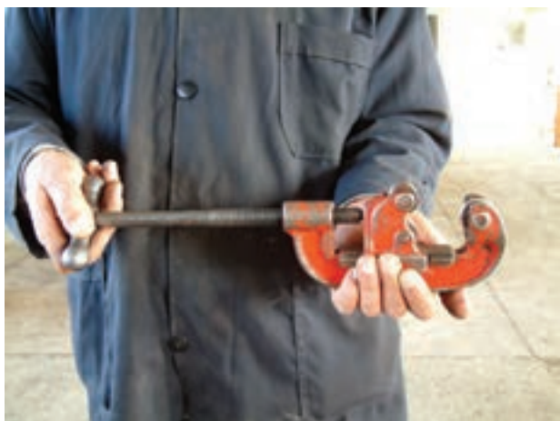
شکل ۱-۵۴- باز کردن دهانه ی لوله بُر
