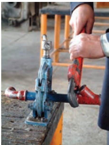
شکل ۵-۱۳۹- بستن فیتینگ‌ها به لوله‌های حدیده شده
