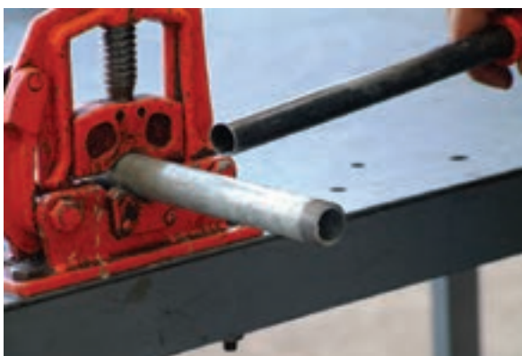
شکل ۴-۱۱۷- جداسازی پلیسه از سر دنده
