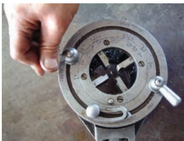
شکل ۴-۶۲- سفت کردن مهره‌های ثابت کننده‌ی رینگ متحرک
