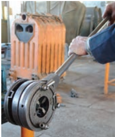
شکل ۴-۶۷- دنده کردن لوله
