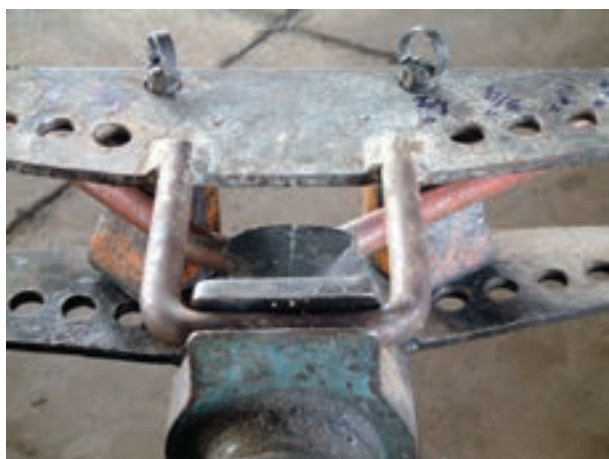
ب- باز کردن خم لوله‌ی خم شده
