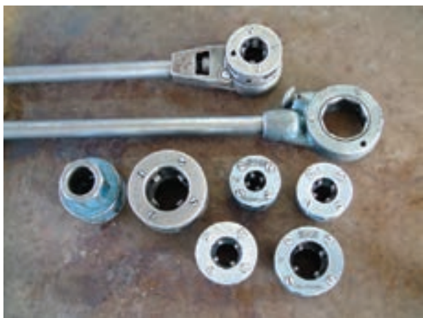
شکل ۴-۴۲- حديدى چهارپارچه‌ى غير قابل تنظيم
