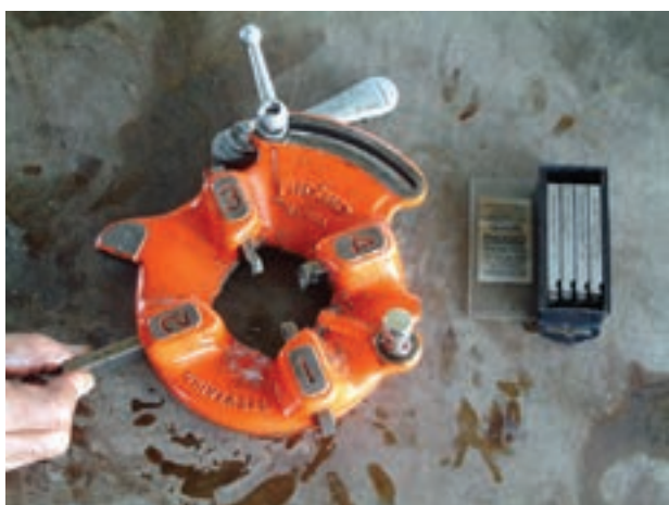
شکل ۴-۹۲ جا زدن پارچه‌ها در شیارهای تنه‌ی حدیده
