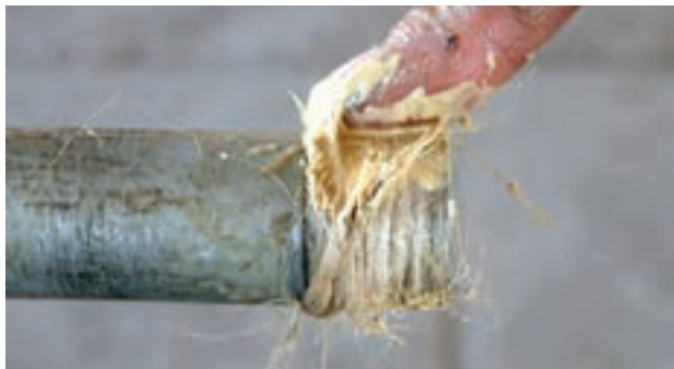
شکل ۵-۱۰۰- استفاده از مواد آب‌بندی
