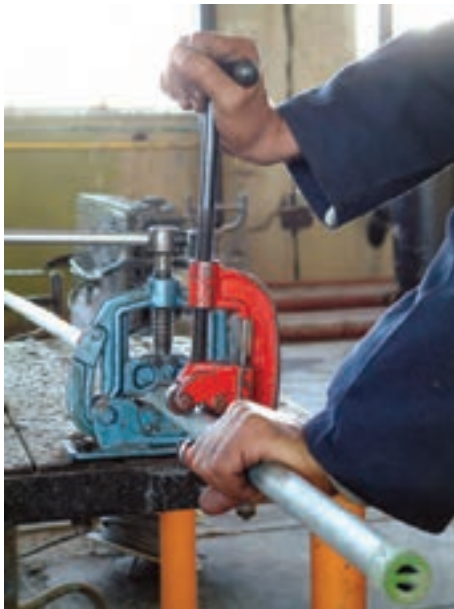
شکل ۱-۵۸- ادامه‌ی عمل بُرش‌کاری
