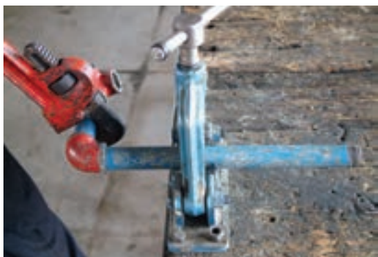
شکل ۵-۱۵۴- بستن لوله‌ی ضلع دوم مدار
