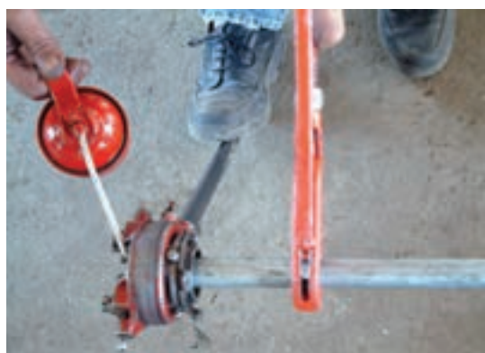
شکل ۱۲۱-۵- استفاده از روغن در جریان حدیده کاری
