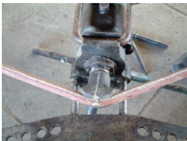
شکل ۳-۲۵- پایان عمل خم‌کاری
