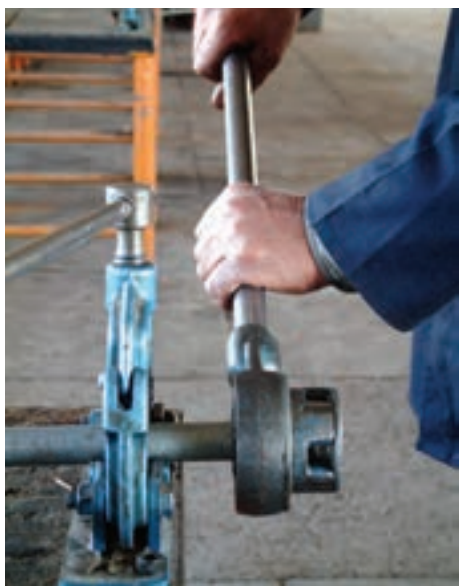
شکل ۴۸- عمل حدیده کاری
