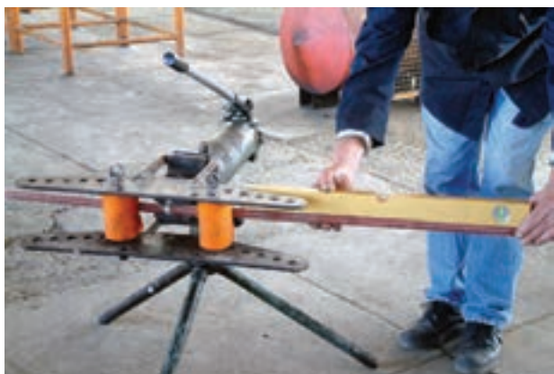
شکل ۳-۴۳- کنترل افقی بودن لوله در خم کاری
