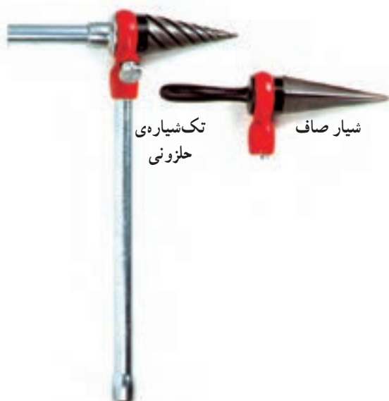
شکل ۲-۵- بُرقو با لبه‌های بُرنده‌ی مختلف
