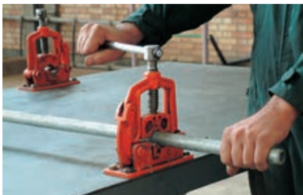
شکل ۳-۵۳ باز کردن شاخه‌ی لوله از گیره‌ی لوله
