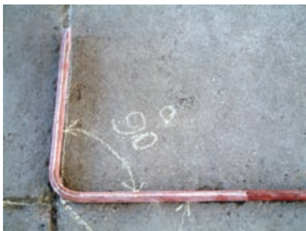
شکل ۳-۵۷- لوله‌ی خم کاری شده
