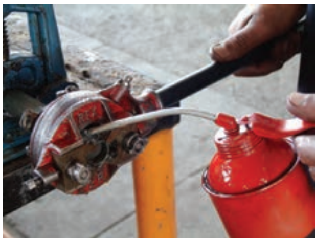
شکل ۴-۳۵- روغن کاری
