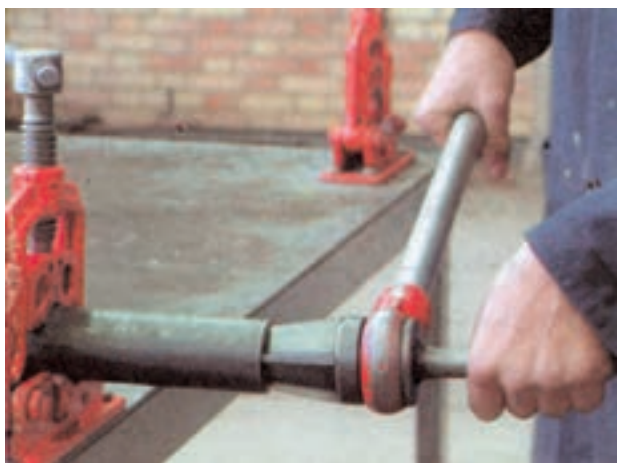
شکل ۱۲-۲- عمل بُرقوکاری
