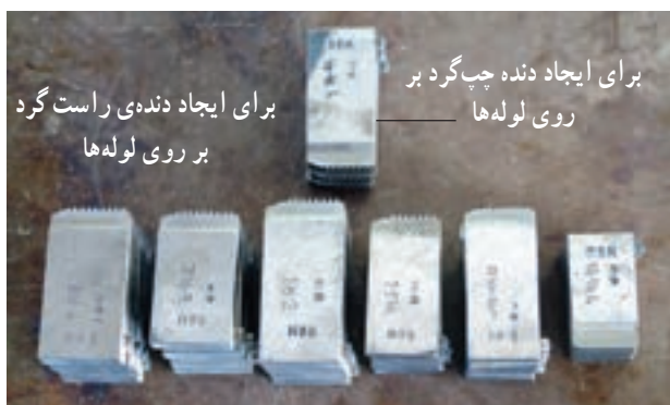
الف - چند دست پارچهى حديدده، حديددهاى چهارپارچه
