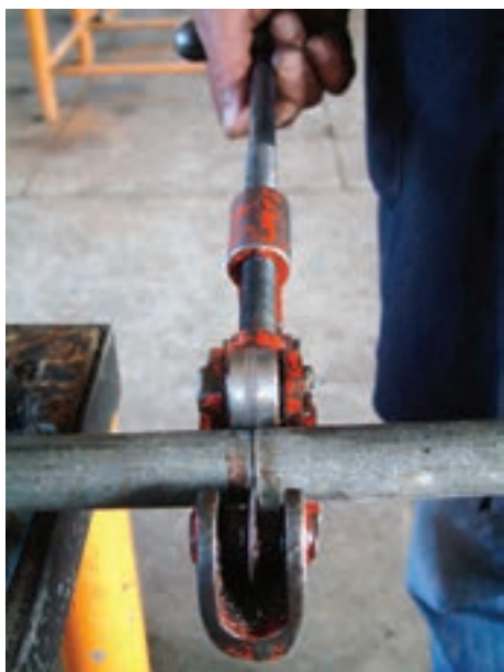
شکل ۱-۵۵ - بریدن لوله
