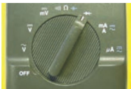
شکل ۱۷-۱- وضعیت آزمایش دیود با مولتی‌متر دیجیتالی
