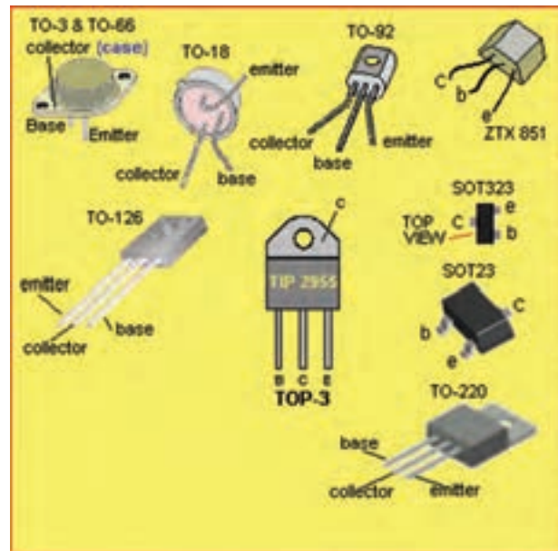
شکل ۱۴-۲- انواع ترانزیستور
