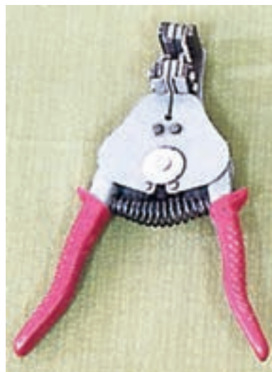
شکل (۱-۲۹) سیم لخت کن اتوماتیک
