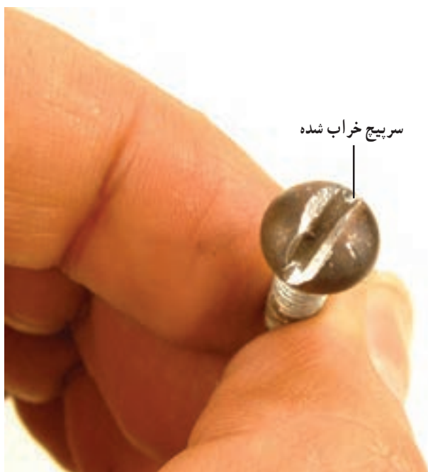
شکل ۹-۱- اثرات استفاده نامناسب از ابزار
