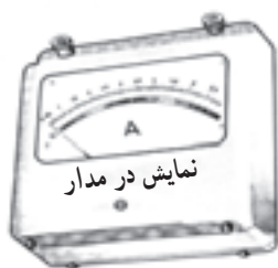
شکل ۵-۲۹ - شکل ظاهری آمپر متر
