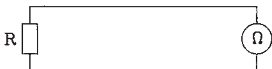
شکل ۵۴-۵- مدار اتصال اهم متر به مقاومت
