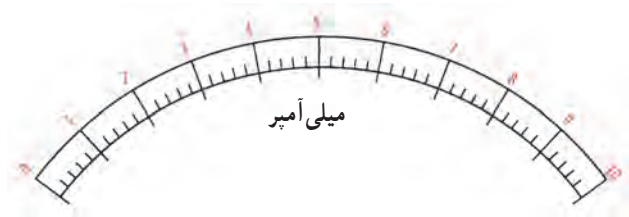
شکل ۵-۷ — درجه بندی میلی آمپر متر
