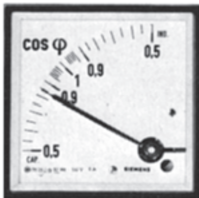
شکل ۵-۳۹- شمای ظاهری کسینوس فی متر
