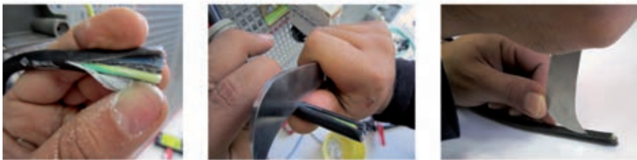
شکل ۲-۲۲ - بریدن و لخت کردن کابل
