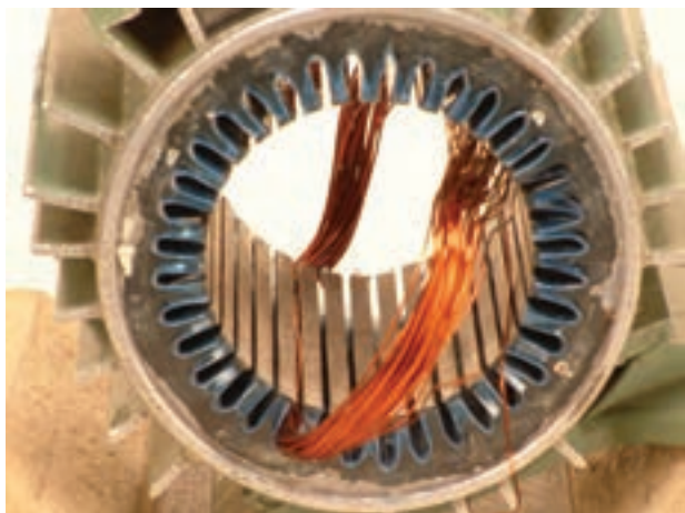
شکل ۲-۷- قرارگرفتن یک بازو در داخل یک شیار
