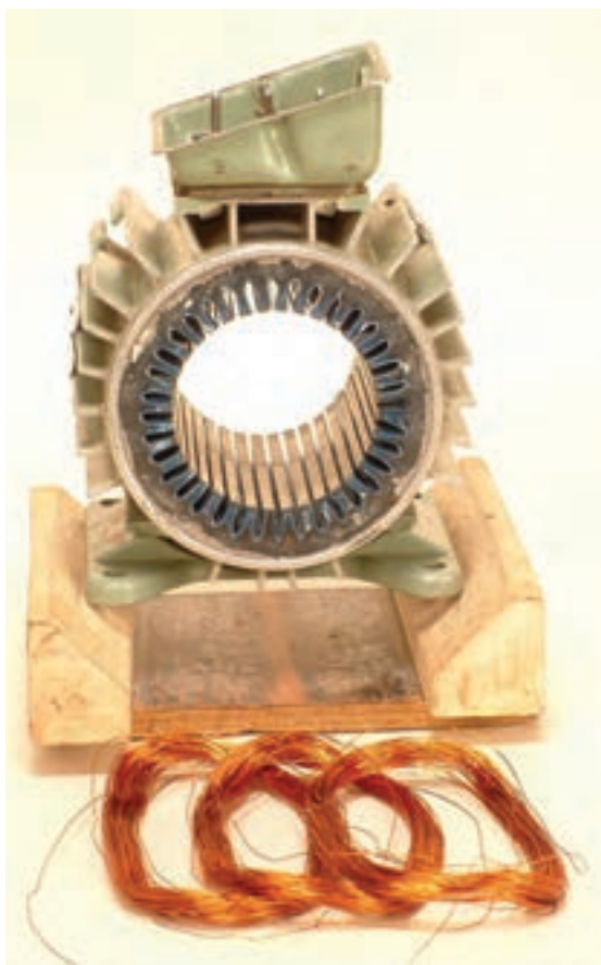
شکل ۱۴-۲ تعیین محل قرار گرفتن کلاف‌ها
