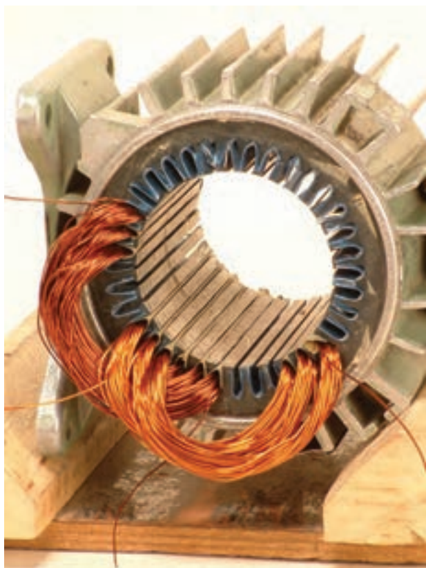
شکل ۲-۲۲- شروع گروه کلاف سوم از شیار شماره ۱۳
