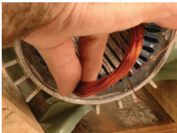
شکل ۱۵-۲ قراردادن بازوی شماره یک در شیار شماره ۱
