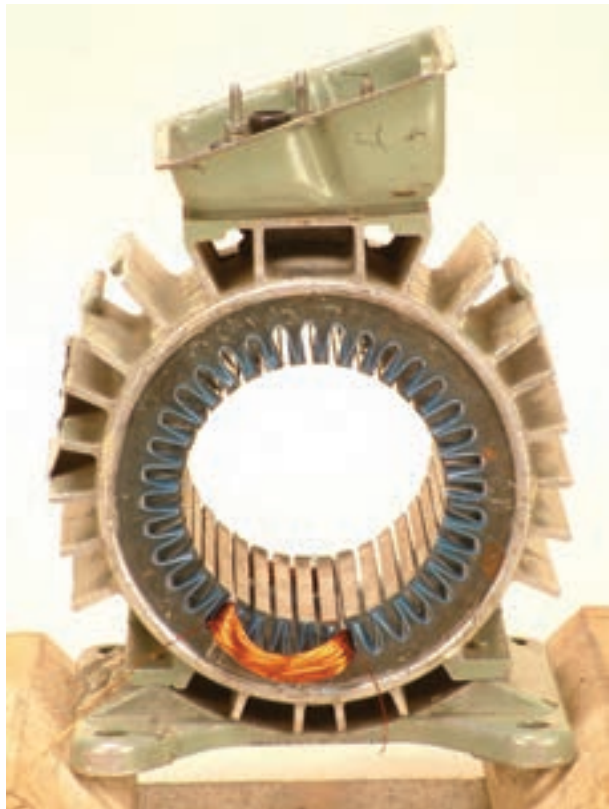
شکل ۲۹-۲-ج - قراردادن کلاف شماره ۱
