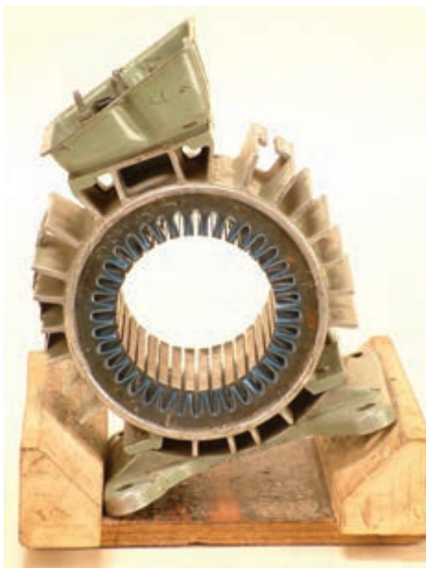
شکل ۲۹-۲-ب - انتخاب شیار شروع سیم‌بندی
