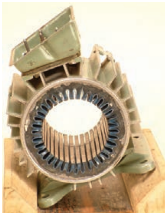
شکل ۲-۱۳- انتخاب شیار شروع و مسیر کلاف‌گذاری
