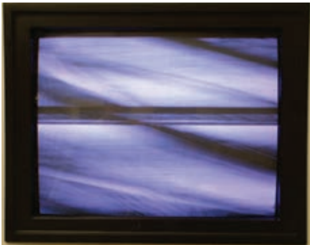
شکل ۱-۴۹ عدم تنظیم فرکانس نوسان ساز افقی
