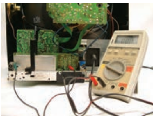
شکل ۱-۶۱°- اتصال ولت‌متر به پایه‌ی ۱۰
