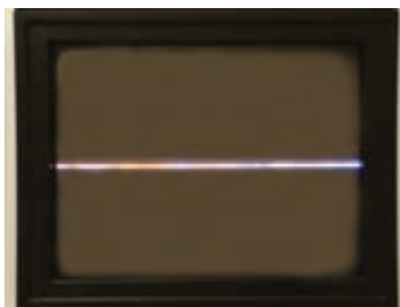
شکل ۲-۴۰- نوسان ساز عمودی از کار افتاده است.
