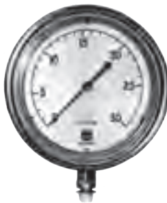
شکل ۱۰-۱۰- یک نمونه خلاسنج بر حسب اینچ جیوه
