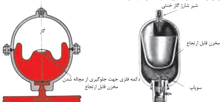
شکل ۴-۱- آکومولاتور گازی نوع دیافراگمی
