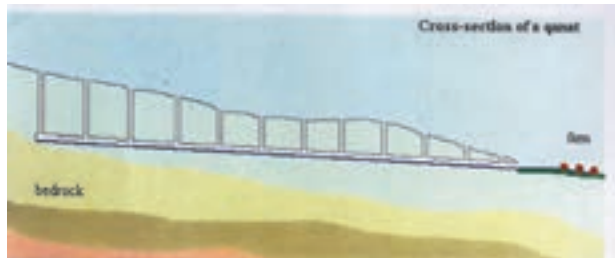
شکل (۱-۱) - سطح مقطع قنات و کانال آن
