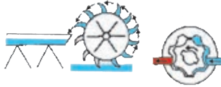
پمپ با حجم جابه‌جایی مثبت پمپ با حجم جابه‌جایی غیرمثبت
