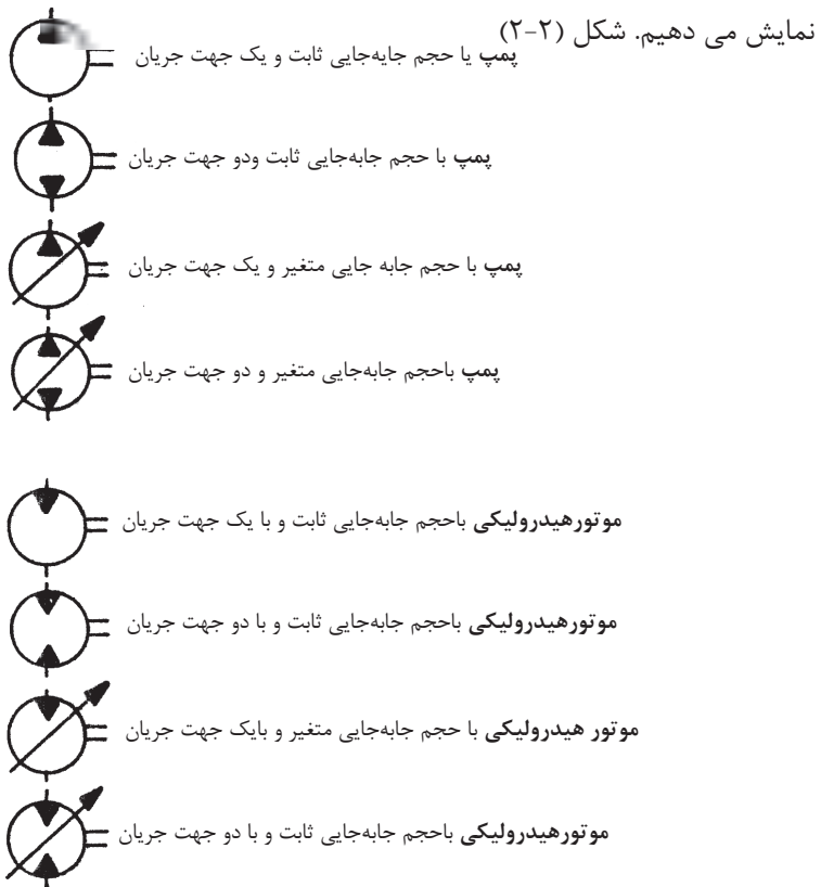
شکل ۲-۲- نمادگرافیکی هیدروپمپ‌ها و هیدروموتورها
