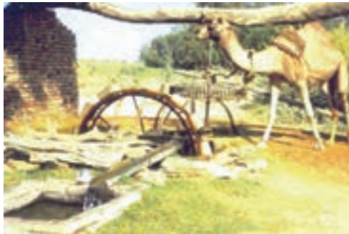
شکل ج-۹- نمونه‌ی دیگری از پمپاژ آب به سطح با بهره‌گیری از انرژی عضلانی
