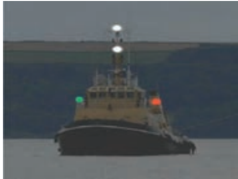
شکل ۱۲-۴- چراغ‌های راه دریانوردی یک یدک کش
