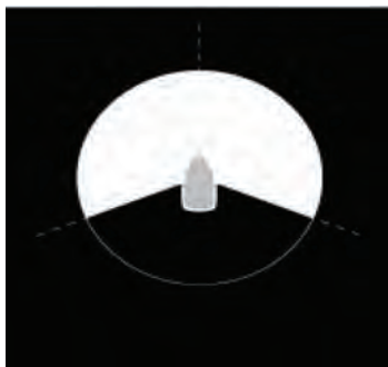
شکل ۱-۴- زاویه دید چراغ دکل اصلی شناور
