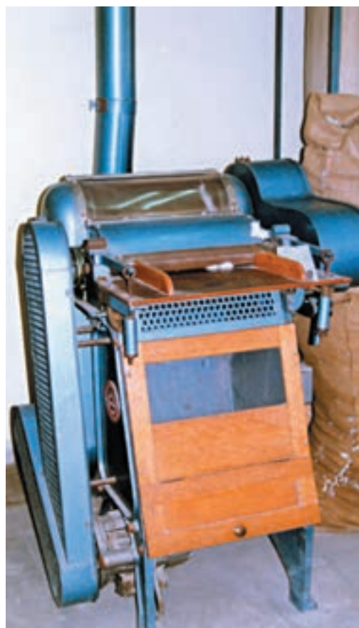
شکل ۱۸-۱-ب - دستگاه اندازه گیری خلوص الیاف پنبه
