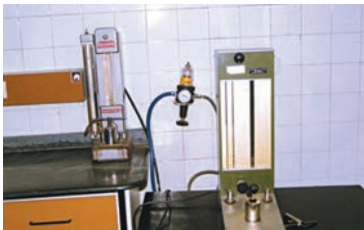
شکل ۱۸-۱ الف - دستگاه اندازه‌گیری ظرافت الیاف پنبه
