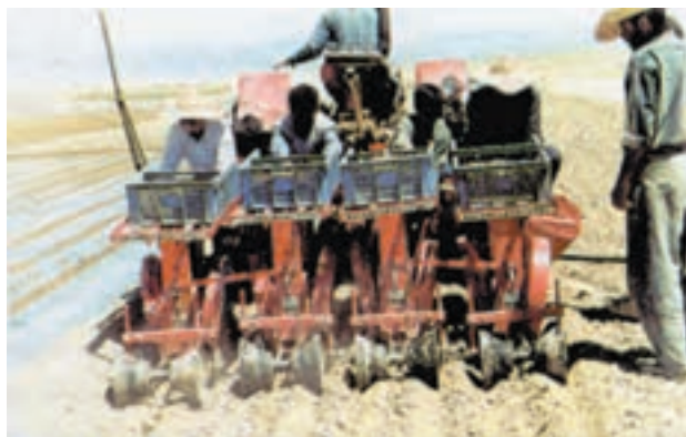
شکل ۳-۱۲- کاشت نشاها با ماشین نشاکار
