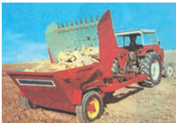
شکل ۱-۲- جمع کردن سنگ با تراکتور
