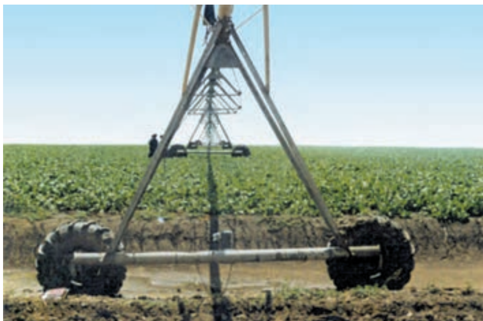
شکل ۳-۴- دستگاه آبپاری بارانی در مزرعه چغندر
