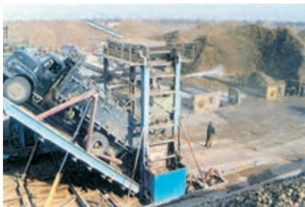
شکل ۱-۶- تخلیه چغندر در ابتدای خط کارخانه
