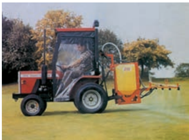
شکل ۲-۲- سمپاش سوار در وضعیت کار
