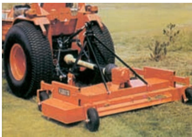
شکل ۲-۳- دروگر سوار در حال کار
