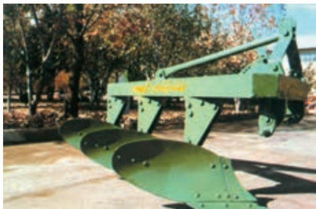
شکل ۲-۳۶- گاوآهن سوار سه خیش
