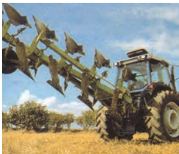
شکل ۲-۱- گاواهن سوار در وضعیت حمل و نقل
