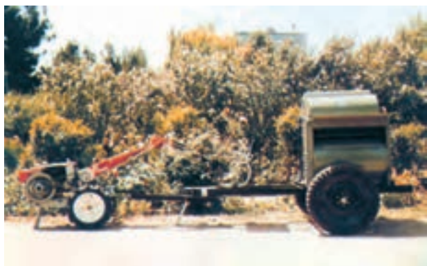
شکل ۱-۵۳- خرمنکوب کششی متصل به تراکتور دوچرخ
