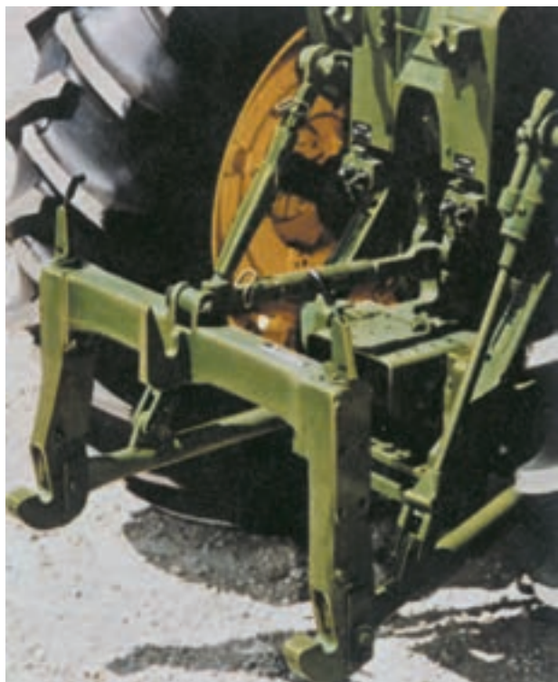
شکل ۲-۶۵ مالبند اتصال سریع
