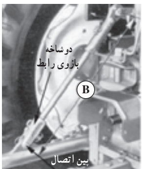
در تراکتور جاندیر ۳۱۴۰ طول بازوها (B) باید بین ۷۶۰-۹۰۷ میلیمتر باشد.
