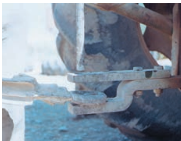
شکل ۳۶-۱ باز کردن پی نورد از تراکتور
