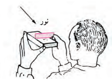
شکل ۱-۲۳- کنترل زاویه قائمه با گونیا
