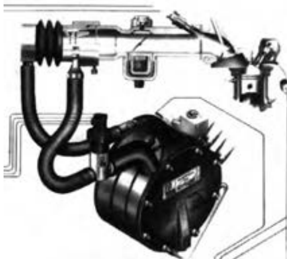
شکل ۱۵-۱. سیستم مخلوط کننده سوخت گاز با هوا
