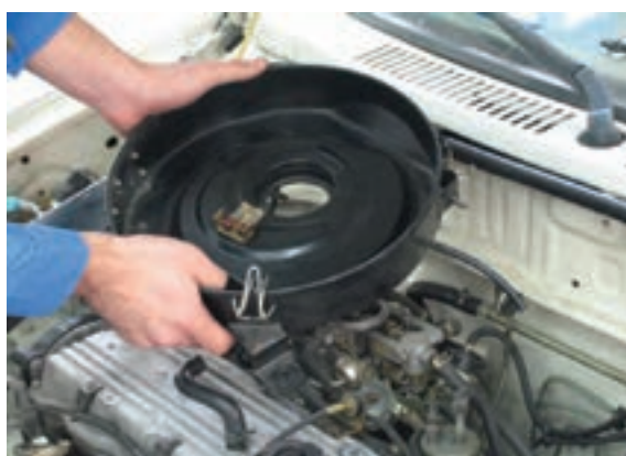
شکل ۱۰۰-۱ پیاده کردن مجموعه هواکش
