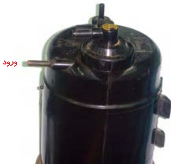
شکل ۱-۹۶ شیر ورودی سوخت‌های تبخیر شده به کنیستر
