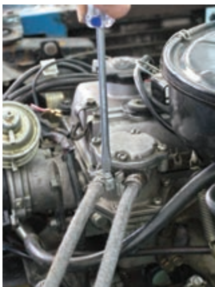
شکل ۱-۳۲ اتصال لوله سوخت به پمپ
