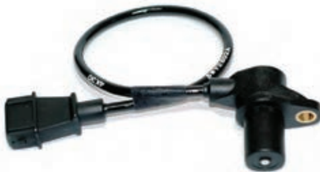
شکل ۲-۳۸- سنسور دور موتور
