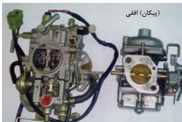
شکل ۱-۶۴ کاربراتورها از نظر حرکت سوخت (نزولی - افقی)
