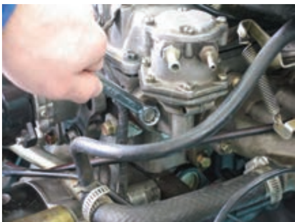
شکل ۱-۴۲ پیاده کردن پمپ
