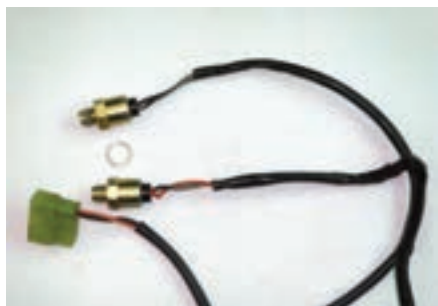
شکل ۱-۹۱ اجزای الکتریکی در یک نوع کاربراتور
