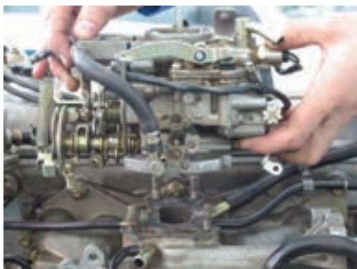
شکل ۱-۱۱۱ پیاده کردن کاربراتور
