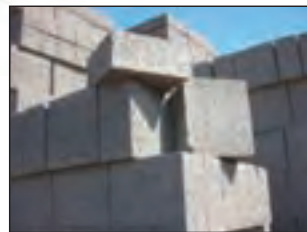
شکل ۷۹-۱ انواع بلوک بتنی سبک
