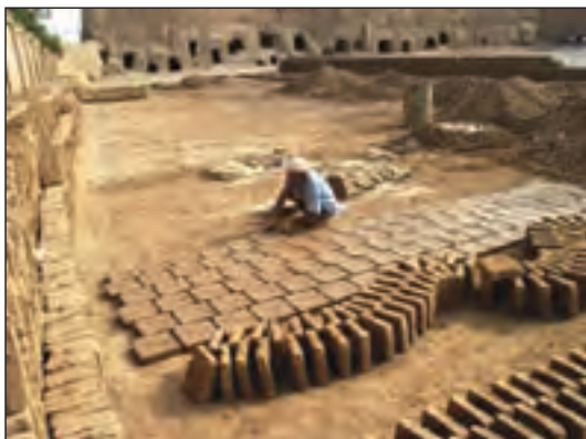
شکل ۵۴-۱ خشت خام (ساخت آجر به روش دستی)
