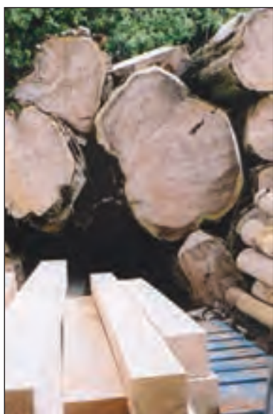
شکل ۱-۱۵۹ بالای تصویر گرده بینه - پایین تصویر الوار
