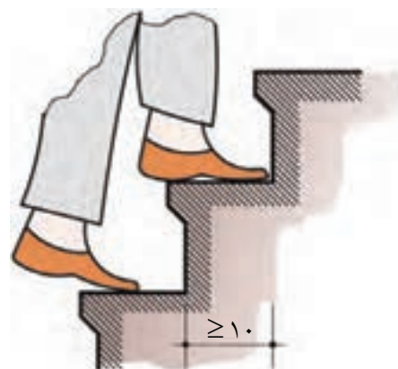
شکل ۱۶-۳ کوچک‌ترین اندازه‌ی کف پله در پله‌های پیچ
