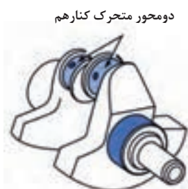
دو شاتون روی یک محور
