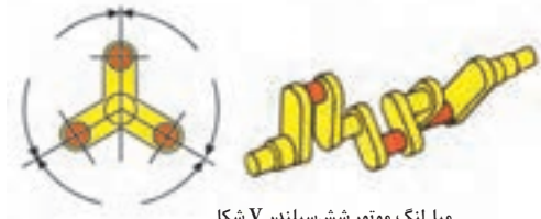
میل لنگ موتور شش سیلندر V شکل
