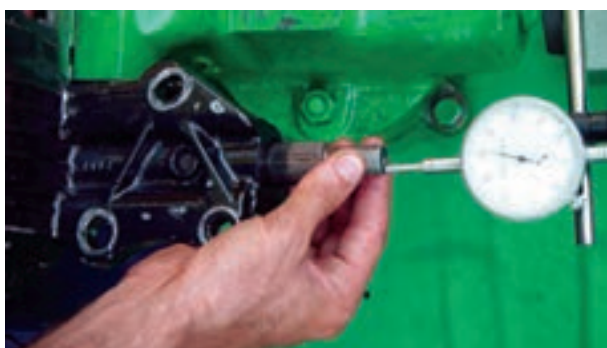
شکل ۷۰-۲ اندازه‌گیری لقی طول محور هزار خار
