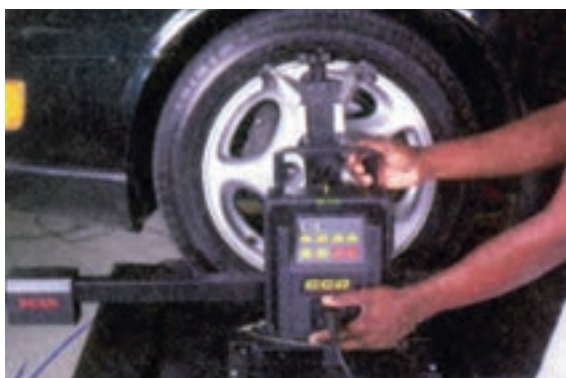
شکل ۳-۲۲۰ - نصب مجموعه حسگر دستگاه اندازه‌گیر رایانه‌ای
