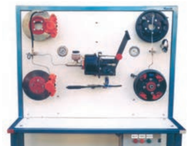
شکل ۱۴-۱- اجزای سیستم ترمز
