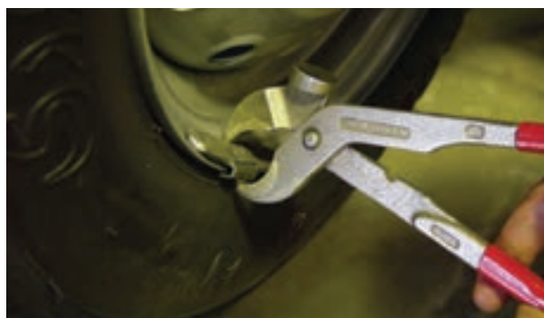
شکل ۲۳۳-۳- تمیز کردن و پیاده کردن سرب‌های قبلی
