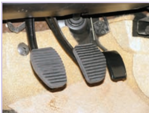
شکل ۱۵-۱- مجموعه پدال‌های ترمز و کلاچ
