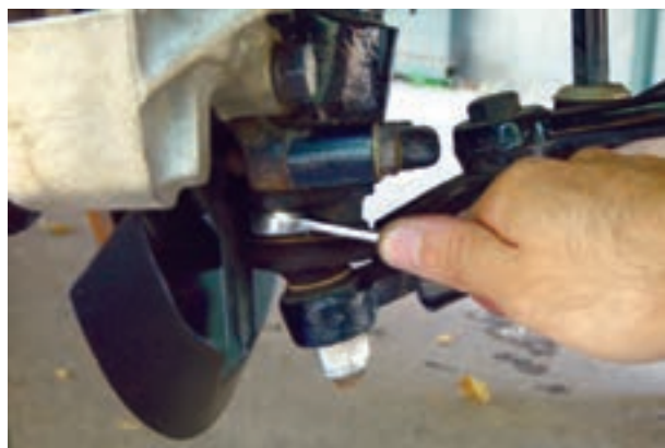
شکل ۳-۷۸- باز کردن سبک زیر کمک فنر
