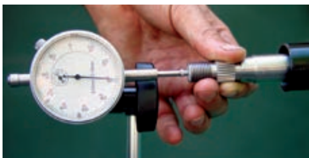
شکل ۶۸-۲ اندازه‌گیری لقی طولی میل فرمان
