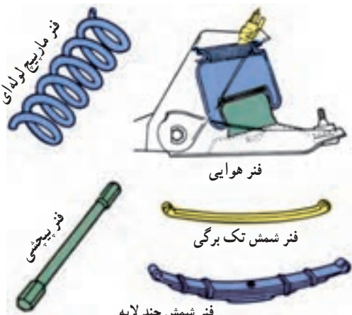
شکل ۳-۲۴ انواع فنرهای مورد استفاده در خودرو
