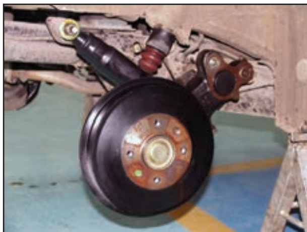
شکل ۳-۵۱- ژامبون و کمک فنر
