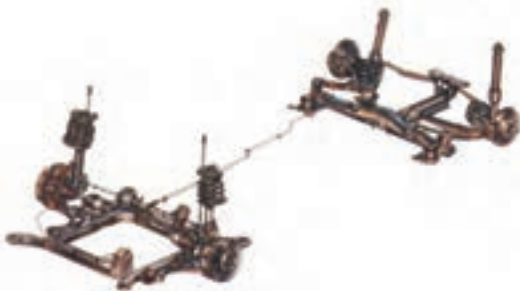
شکل ۴۱-۳ سیستم تعلیق عقب و جلو خودرو
