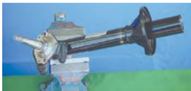
شکل ۳-۹۷- پوسته کمک فنر و محور چرخ
