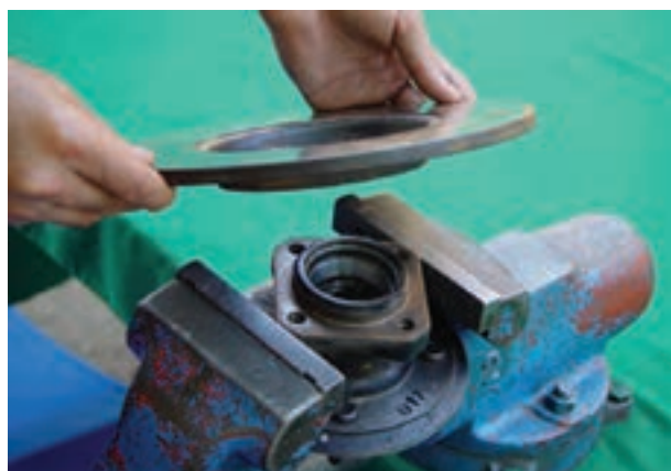
شکل ۳-۹۸- جدا کردن دیسک ترمز از تویی چرخ
