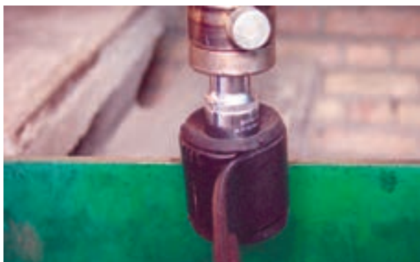
شکل ۳-۶۹- بوش لاستیکی فلزی محل اتصال شاه فنر
