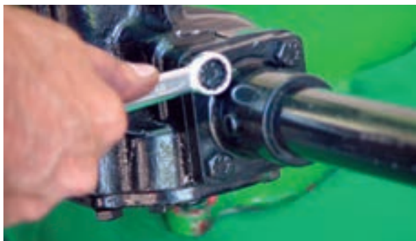
شکل ۲-۶۰ باز کردن پیچ‌های لوله فرمان
