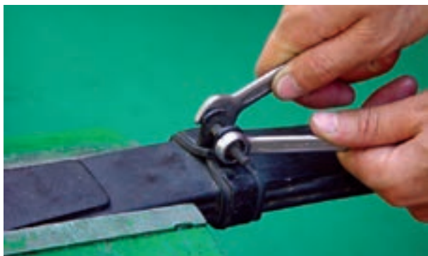
شکل ۳-۶۷- باز کردن بست‌های مجموعه فنر شمش
