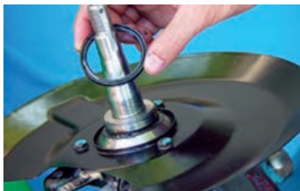
شکل ۳-۹۵- خارج کردن کاسه نمد پشت توپی چرخ
