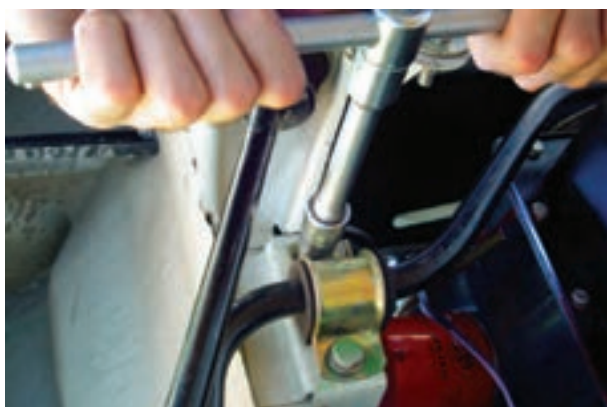
شکل ۳-۸۶ - باز کردن میله ضد غلتش (موج گیر)
