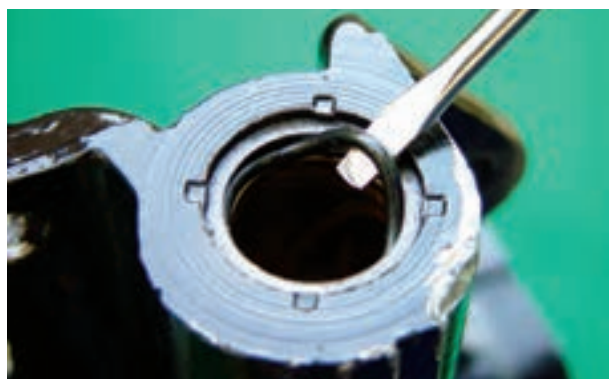
شکل ۶۵-۲- تعویض لاستیک
