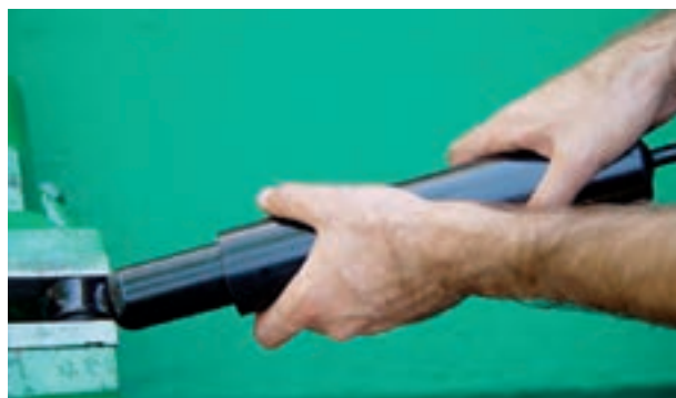
شکل ۳-۷۴- آزمایش کمک فنر
