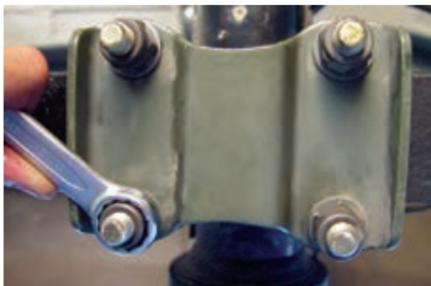
شکل ۳-۶۶- باز کردن مهره‌های کربی‌ها (پیچ‌های U شکل)
