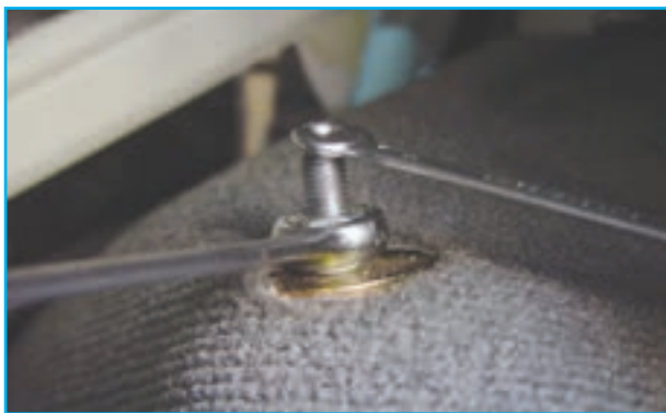
شکل ۳-۶۳- باز کردن مهره اتصال بالای کمک فنر
