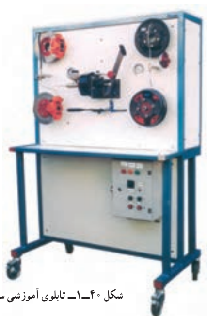
شکل ۱-۳۹- مجموعه ترمز دیسکی
