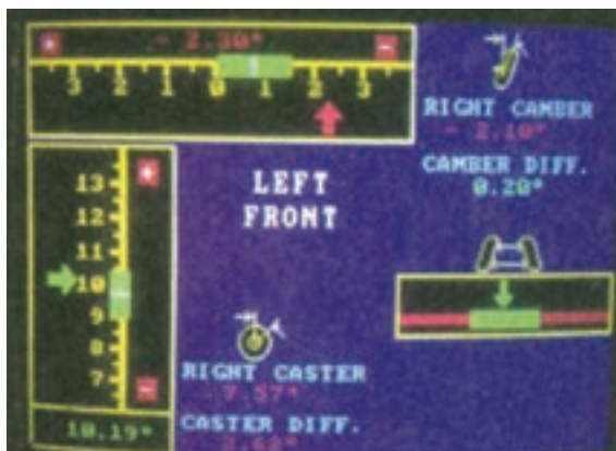
شکل ۳-۲۲۱ - صفحه نشان‌دهنده اندازه‌های په‌دست آمده
