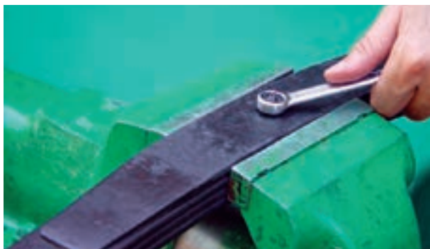
شکل ۳-۶۸- باز کردن پیچ مرکز فنرهای شمش
