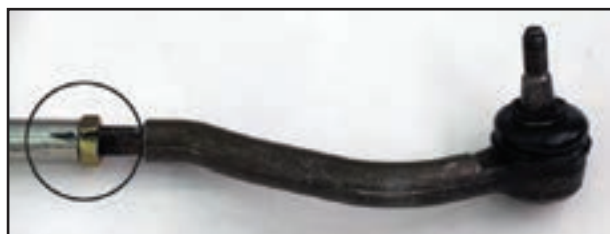
شکل ۲-۷۴- علامت گذاری سیبک و میل رابط
