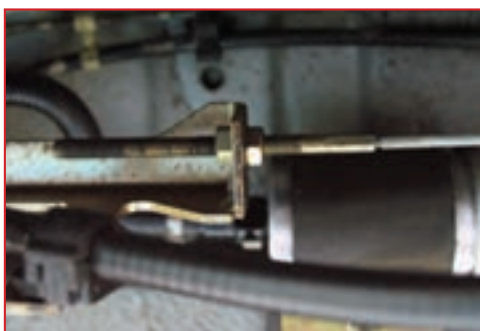
شکل ۴۸-۱- باز کردن مهره تنظیم کننده
