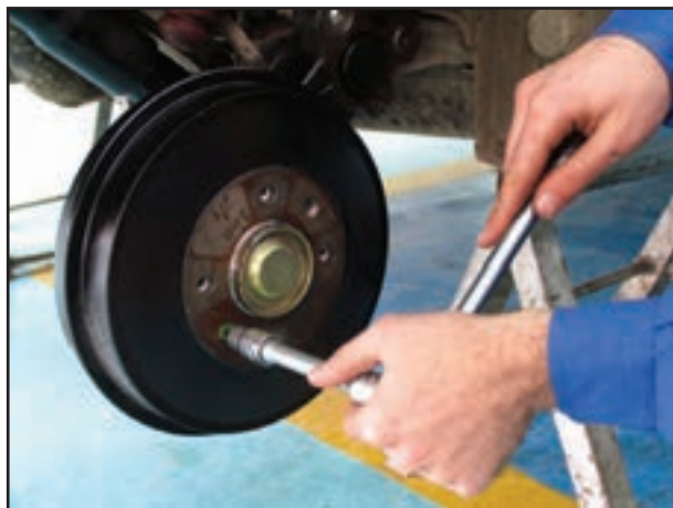
شکل ۱-۱۰۲ - بستن پیچ نگه‌دارنده کاسه چرخ
