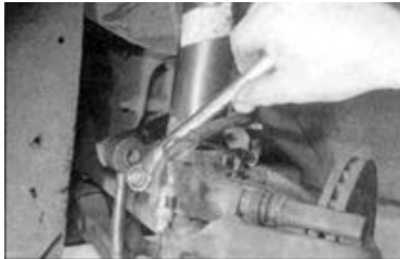
شکل ۱۱۸-۳- بستن پیچ نگه‌دارنده کمک فنر
