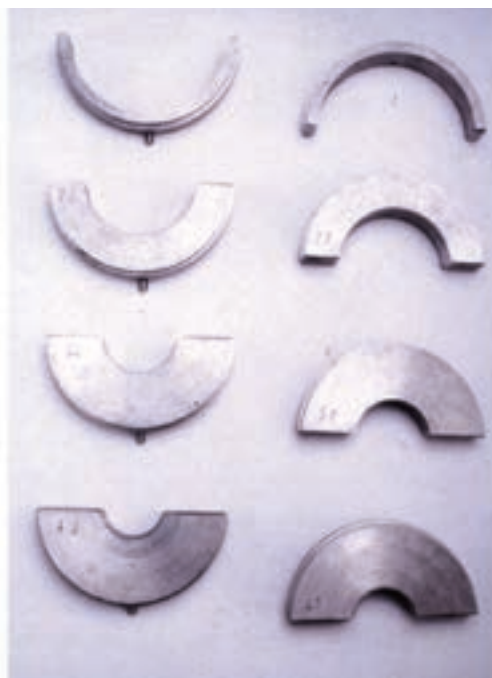
قالب‌های لوله‌بُر و پیخ‌زن پایه‌دار
