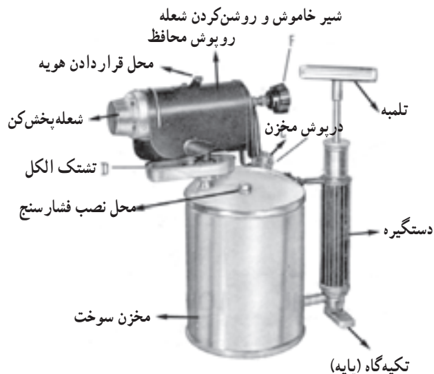
شکل ۱-۲۹ - چراغ کوره‌ای نفت سوز دستی چهارلیتری
