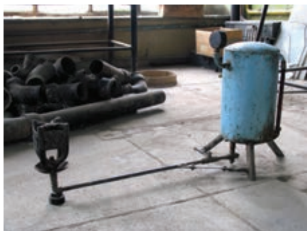
شکل ۱-۳۰ - چراغ کوره‌ای نفت سوز پایه دار
