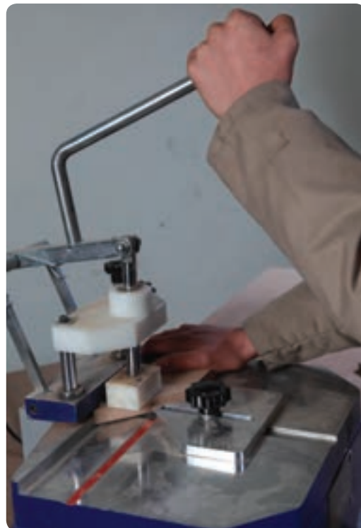
شکل ۲-۱۱۲ برش با زاویه ۴۵ درجه
