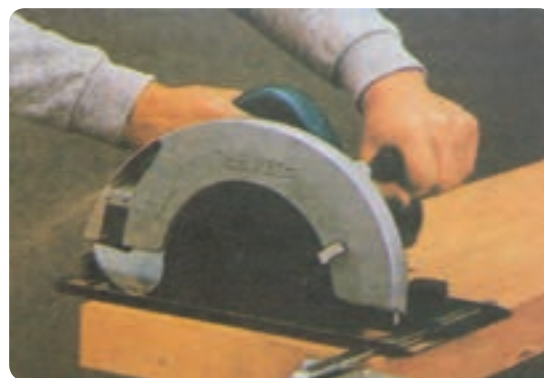
شکل ۳۶-۲ برش به وسیله گونیای دستگاه
