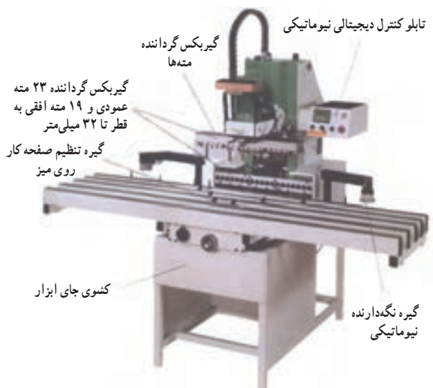
ماشین سوراخ‌زنی و لولازنی دیجیتال نیوماتیک شکل ۲-۱۳۰
