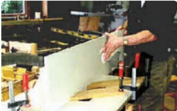
شکل ۳-۲۷ شانه‌های حفاظتی به صورت افقی
