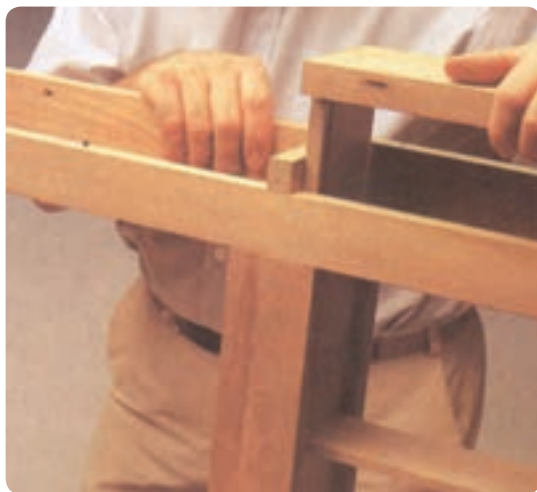
شکل ۶-۱۵۷ اطمینان از گونیی قاب
