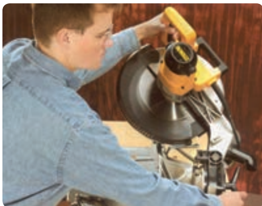
شکل ۲-۹ تنظیم زاویه چرخش اره گرد
