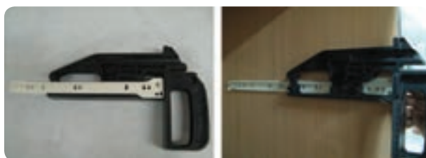
شکل ۷-۲۷ گونیای مخصوص نصب ریل
