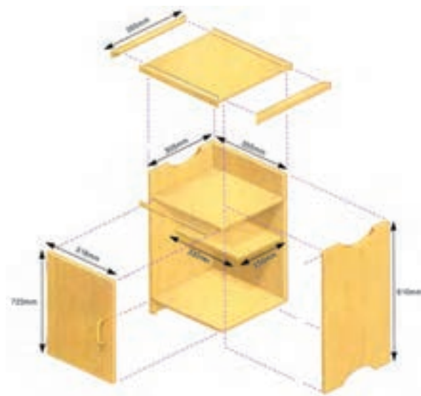
شکل ۸-۳۵ نقشه مونتاز قطعات کابینت
