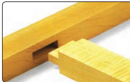
شکل ۴-۳۶ اتصال کُم و زبانه مخفی (یک طرفه)
