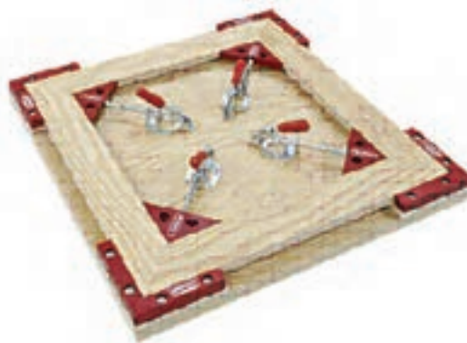
شکل ۳۵-۳ مونتاژ قاب
