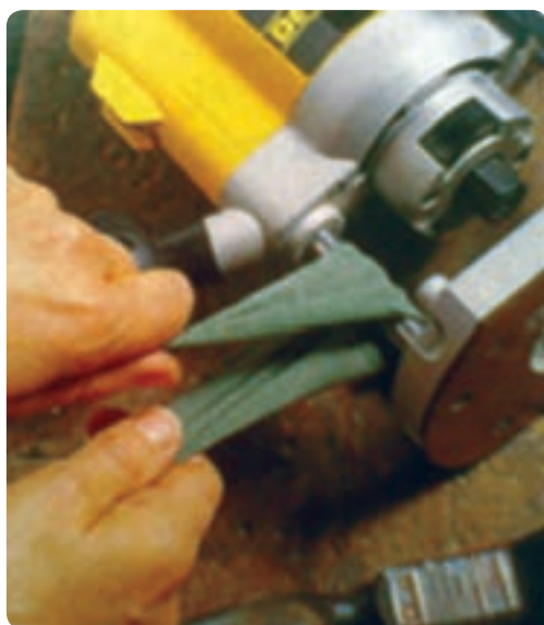
شکل ۶۶-۲ تمیز کردن میله‌های کشویی اورفرز
