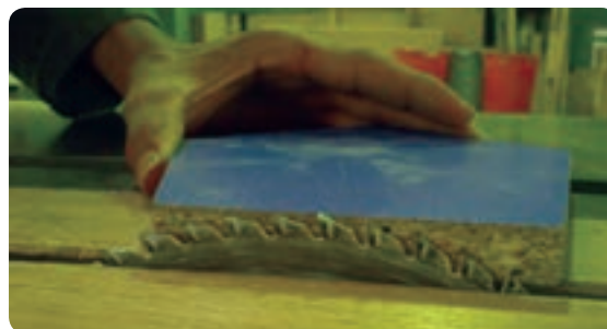
شکل ۳-۳۸ تنظیم ارتفاع تیغه اره
