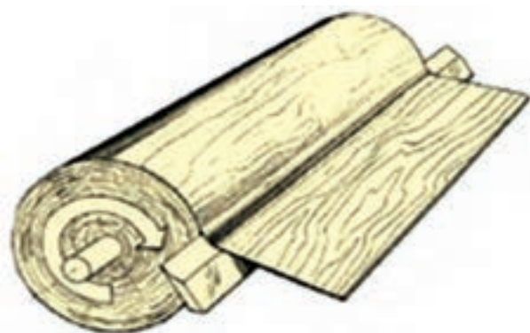
شکل ۲۰-۱ تهیه روکش به روش لوله‌بری
