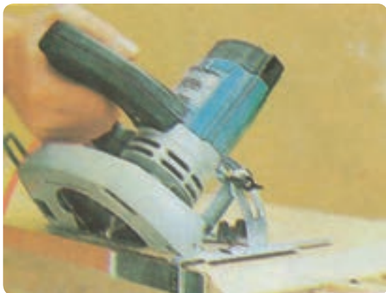
شکل ۳۷-۲ برش تحت زاویه به وسیله گونیای دستگاه
