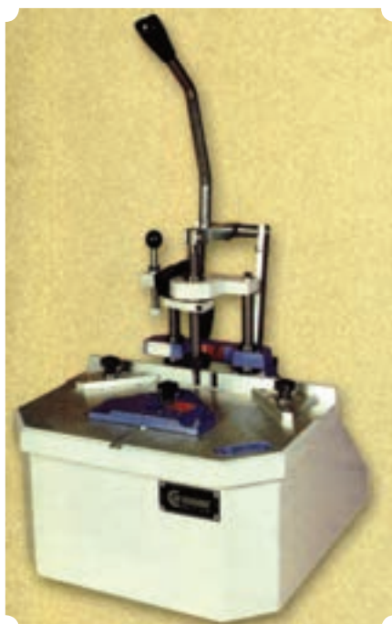
شکل ۲-۱۰۴ ماشین دم چلچله زن پایه بلند
