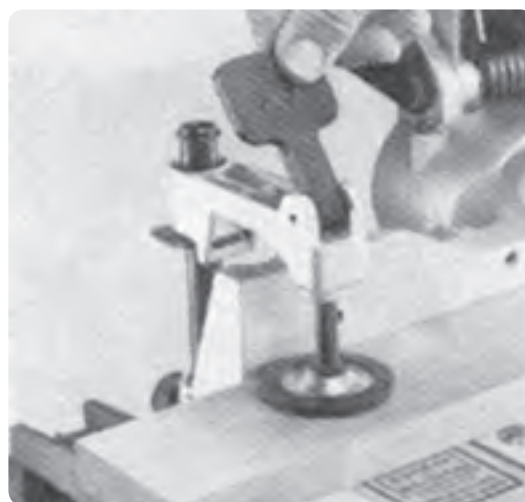
شکل ۲-۱۱- بستن قطعه کار با گیره
