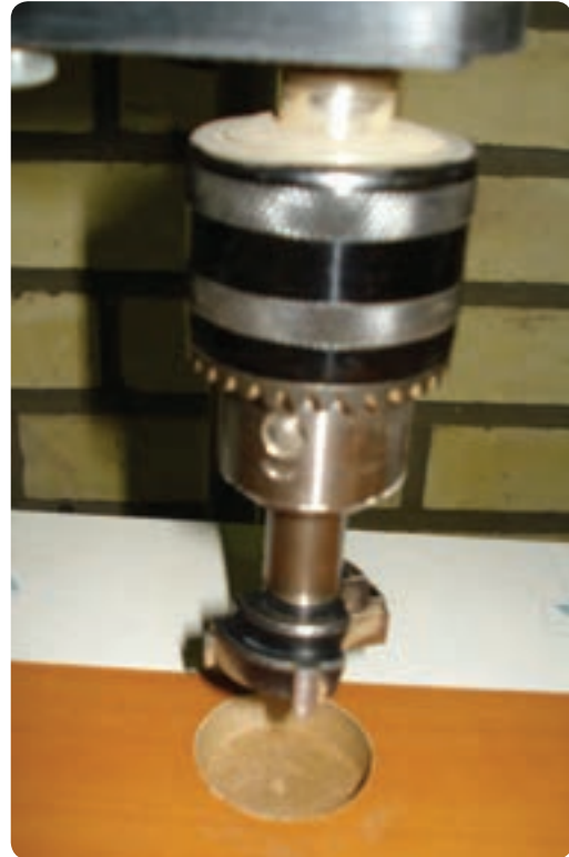
شکل ۶-۷۱ مته کابینت جهت سوراخ کردن جای لولا
