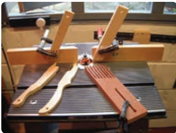
شکل ۳-۲۸ شانه‌های حفاظتی به صورت عمودی
