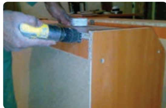
شکل ۶-۱۳۱ نصب لولای محفظه جاواکسی
