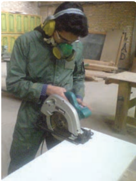
شکل ۲-۳۰ تجهیزات حفاظت فردی به هنگام کار
