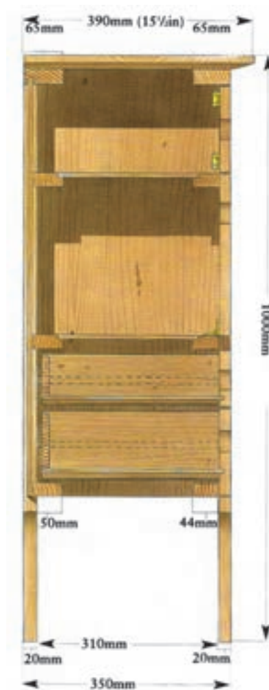
شکل ۵۴ - ۸ برش عمودی از کابینت
