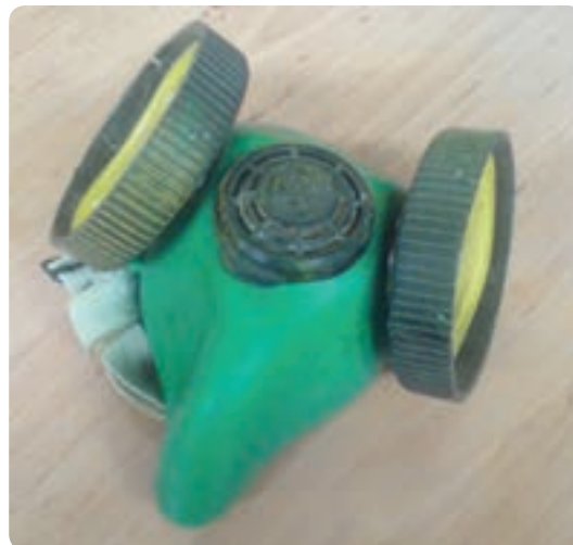
شکل ۲-۱۵ - ماسک تنفسی فیلتردار
