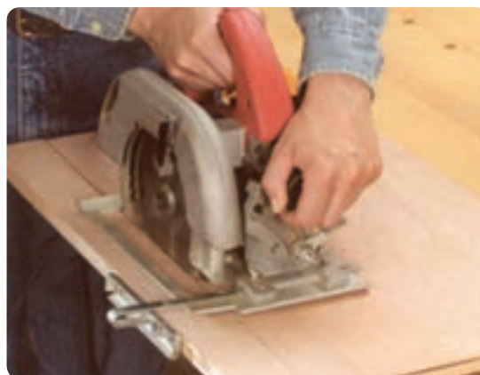
شکل ۲-۲۲ برش عرضی با گونیای ماشین
