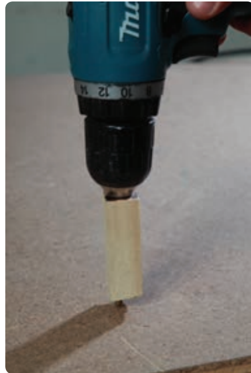
شکل ۳-۳۲ سوراخ دریل قطعه کنترل اندازه عمق
