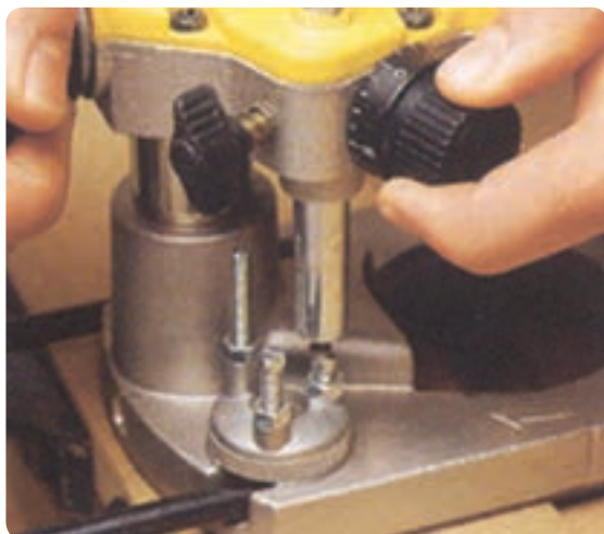
شکل ۲-۷۲ پیچ‌های تنظیم دستگاه
