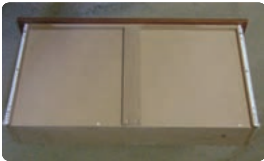
شکل ۶-۱۱۳ نصب قید کمرکش در کشورهای بزرگ
