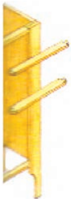
شکل ۶۳- ۸ موقعیت قیدهای عرضی داخلی در کابینت پایه‌دار
