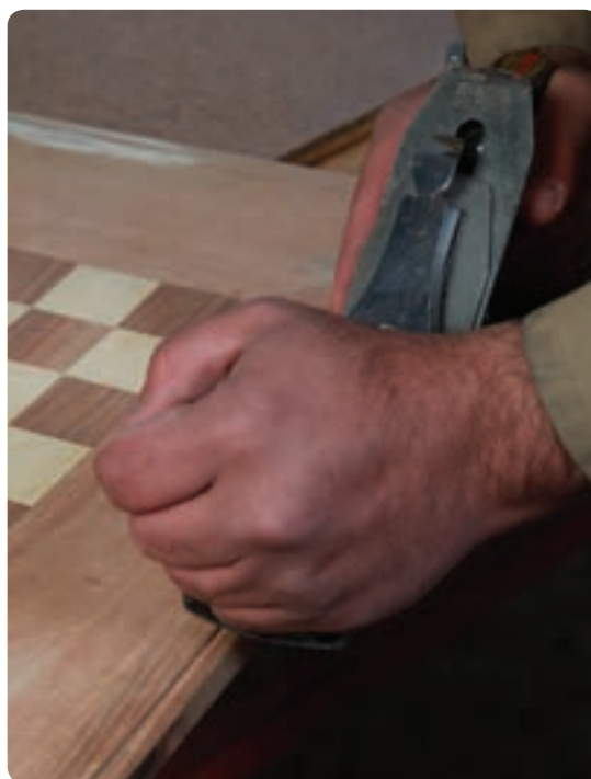
شکل ۷۹-۶ رنده کردن زهوار چوبی
