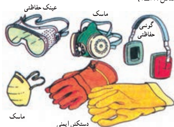
شکل ۳۸-۲ استفاده از وسایل حفاظتی
