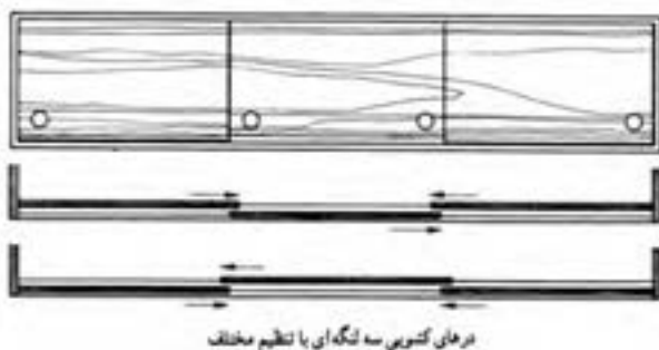
شکل ۶-۲۷ درهای کشویی سه لنگه‌ای با تنظیم مختلف
