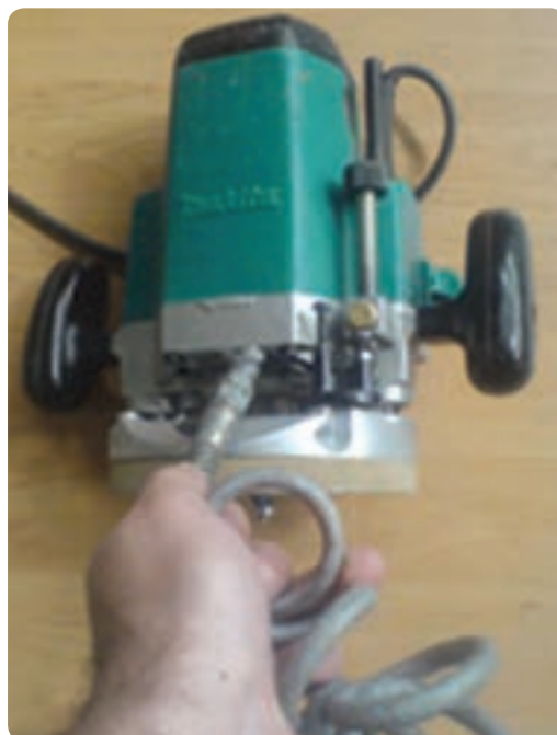
شکل ۲-۷۱ بادگیری دستگاه پس از پایان کار
