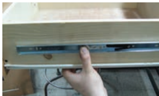
شکل ۷-۳۵ تعیین محل ریل بر روی بدنه کشو
