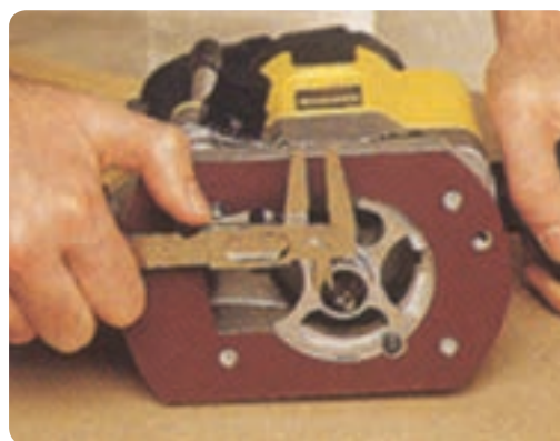
شکل ۲-۶۸ اندازه‌گیری قطر شفت فرز
