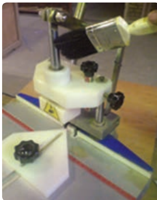
شکل ۱۱۶-۲ تمیز کردن مفصل‌های حرکتی ماشین دم چلچله زن
