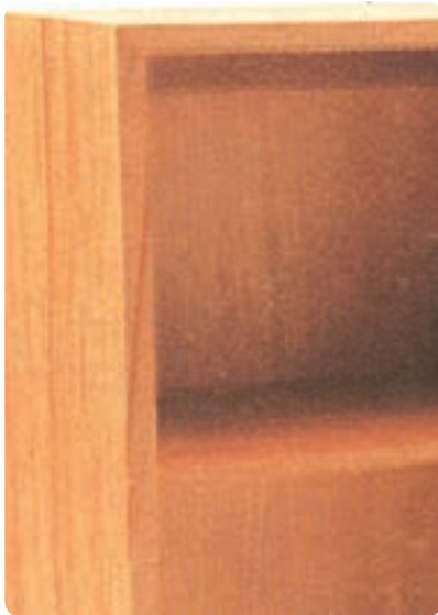
شکل ۶-۷ سقف و کف همرو با بدنه
