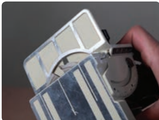
شکل ۲-۹۴ اتصال زن بیسکوییتی بدون گونیا
