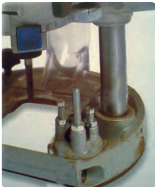
شکل ۲-۴۴ پیچ‌های تنظیم ارتفاع اور فرز دستی برقی
