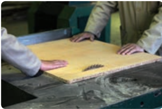
شکل ۶-۷۷- برش در ساده کابینت
