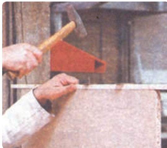
شکل ۷۸-۶ نصب زهوار چوبی لبه چسبان
