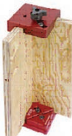
شکل ۳۶-۳ مونتاژ پانل های عمودی
