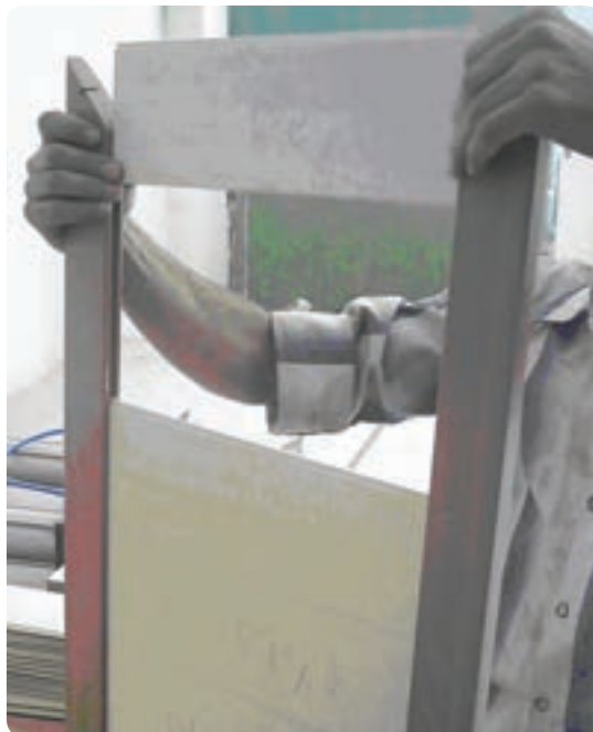
شکل ۶-۹۵ مونتاژ در قابدار با تنگ لته‌ای
