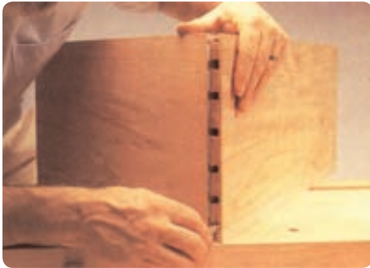
شکل ۶-۱۴۰ مونتاژ آزمایشی قبل از چسب زدن قطعات
