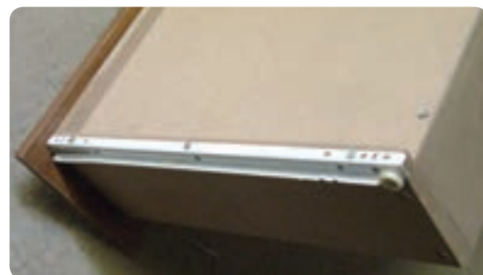
شکل ۶-۱۱۲ نصب ریل مکانیکی در زیر بدنه جعبه
