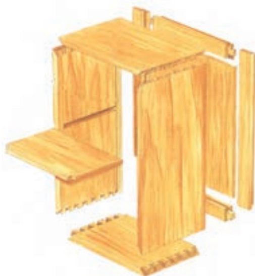
شکل ۶-۱۳۳ پرسپکتیو انفجاری کابینت
