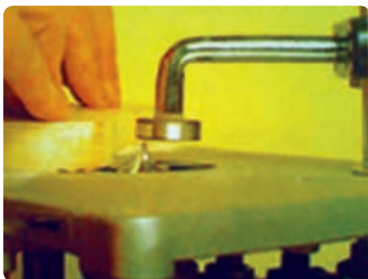
شکل ۶۵-۲ بلبرینگ هدایت برای قطعات قوس‌دار
