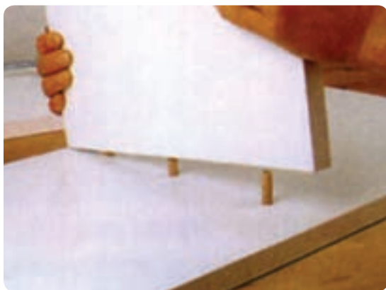
شکل ۶-۷۴ اتصال دوبل جهت مونتاژ کابینت
