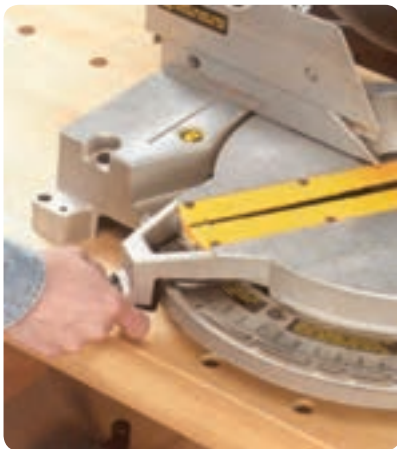
شکل ۲-۸ تنظیم زوایای مختلف برش
