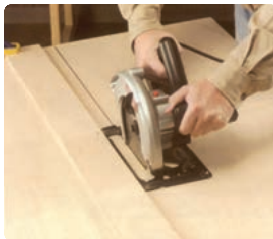
شکل ۲-۲۳ برش طولی با گونیای برراستی
