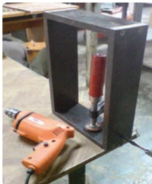
شکل ۶-۱۰۸ مونتاژ دستی جعبه کشو
