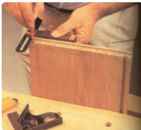
شکل ۶-۱۳۶ خط‌کشی اتصال دم‌چلچله دورو مخفی
