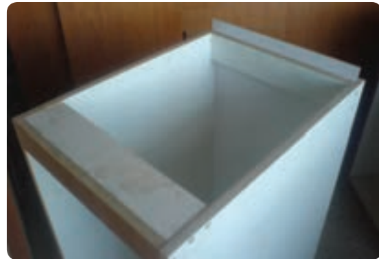
شکل ۶-۷۵- مونتاژ کابینت با قرارگیری پشت‌بند
