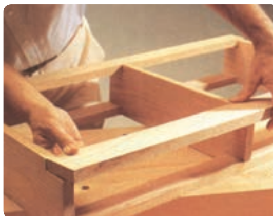
شکل ۶-۱۵۵ مونتاژ کلاف قاب دراور
