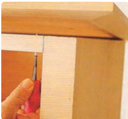
شکل ۶۹-۸ بستن صفحه روی کابینت
