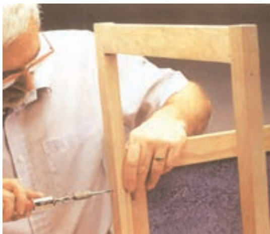
شکل ۶-۱۶۰ مونتاژ قاب پشت با قاب کناری
