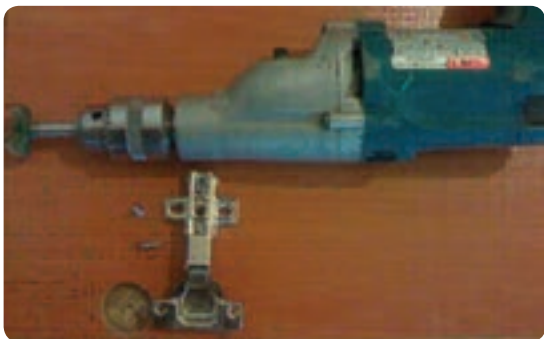
شکل ۱۲۸-۶ نصب لولای کابینت فدردار روی در کابینت
