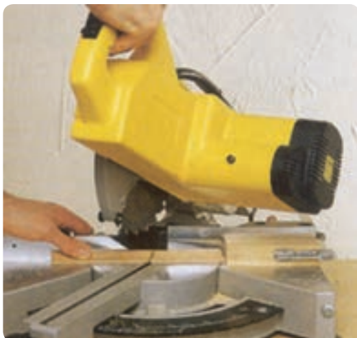
شکل ۲-۱۲- برش قائم با اره گرد فارسی بر
