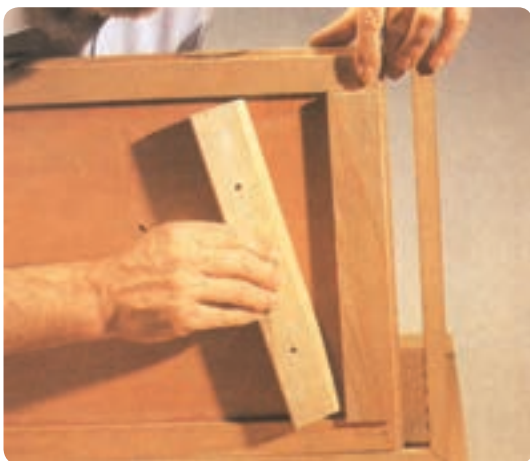
شکل ۱۴۴-۶ اتصال قید کمکی جهت نصب روی دیوار
