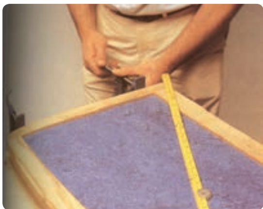
شکل ۶-۱۵۳ تنگ بستن صفحه میز
