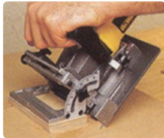
شکل ۹۰-۲ شیارزنی با زاویه ۴۵ درجه
