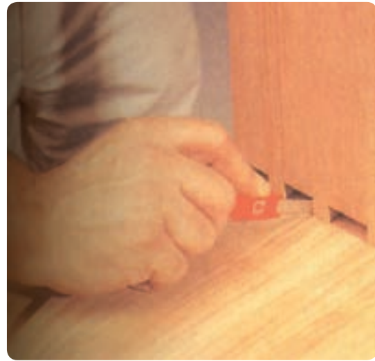
شکل ۶-۱۳۸ خط‌کشی جای فاق روی قطعه دیگر
