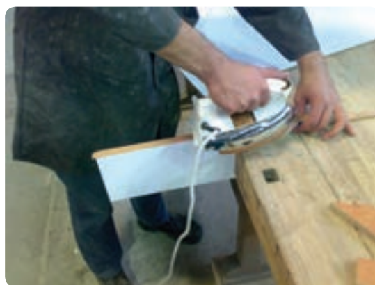
شکل ۱۴۷-۲ اتوکشی نوار روکش لبه چسبان
