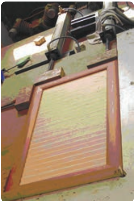
شکل ۶-۹۷ تنگ نیوماتیکی جهت مونتاژ در قابدار کابینت
