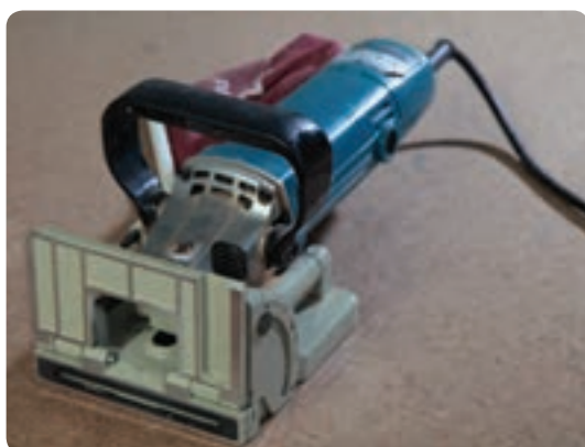
شکل ۲-۹۵ اتصال زن بیسکوییتی با گونیا و موقعیت شاخص روی گونیا
