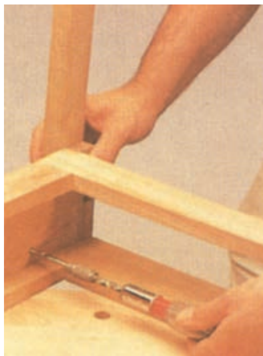
شکل ۶-۱۵۹ اتصال قاب دراور به قاب کناری
