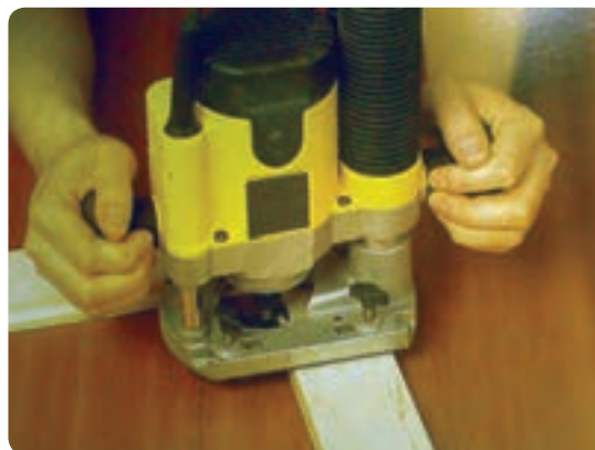
شکل ۵۹-۲ فرزکاری داخل قاب
