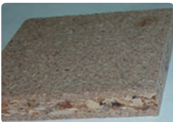
شکل ۱-۳۳ تخته خرده چوب سه لایه
