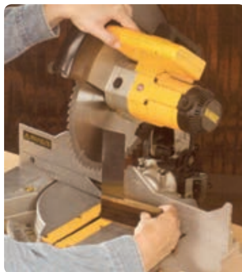
شکل ۲-۷ تنظیم عمود بودن تیغه پشت به صفحه
