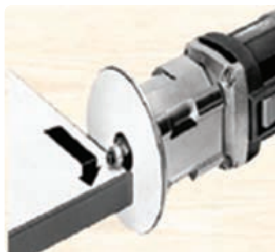
شکل ۱۵۵-۲ پرداخت لبه‌های اضافی روکش مصنوعی
