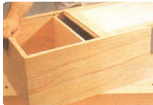
شکل ۱۴۳-۶ قرارگیری پشت بند در کنشکاف بدنه کابینت
