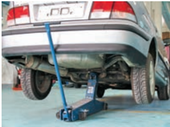
شکل (۱-۵۶) بالابر خودرو (جک سوسماری)
