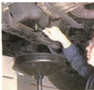
شکل (۲-۵۷) بستن پیچ تخلیه با گشتاور مناسب
