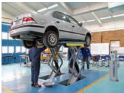
شکل ( ۷۲-۲ ) خودرو روی بالابر در ارتفاع مناسب
