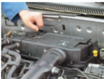
شکل (۲-۶۳) بازکردن در هواکش
