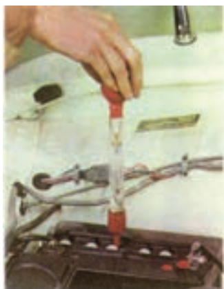
شکل (۲-۸۸) اندازه گیری غلظت مایع باتری
