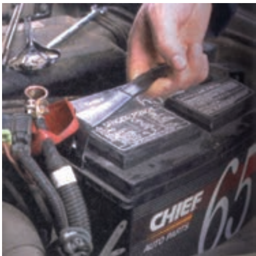
شکل (۲-۸۳) خارج کردن باتری
