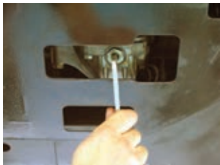
شکل ( ۷۰-۲ ) پیچ تخلیه ی روغن جعبه دنده
