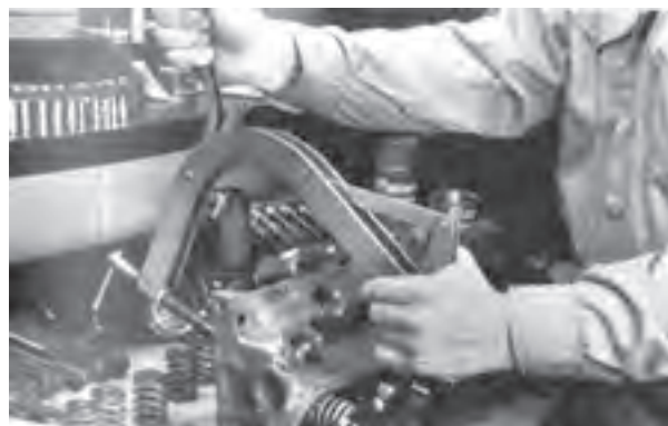
شکل (۱-۵۲) استفاده از فنر جمع کن سوپاپ
