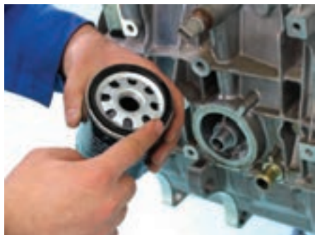
شکل (۲-۵۳) کنترل دندانه و واشر لاستیکی فیلتر
