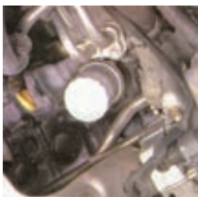
شکل (۲-۶۰) کنترل فیلتر از نظر نشتی
