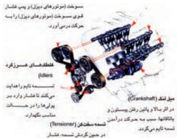
شکل (۲-۱۳) الف) تسمه تایمینگ موتور
