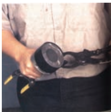
شکل (۱-۵۱) استفاده از رینگ جمع کن
