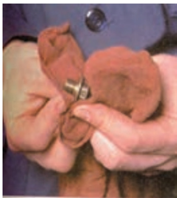
شکل (۲-۵۶) کنترل پیچ تخلیه ی روغن موتور
