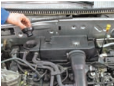
شکل (۲-۵۰) باز کردن درب قالباق موتور
