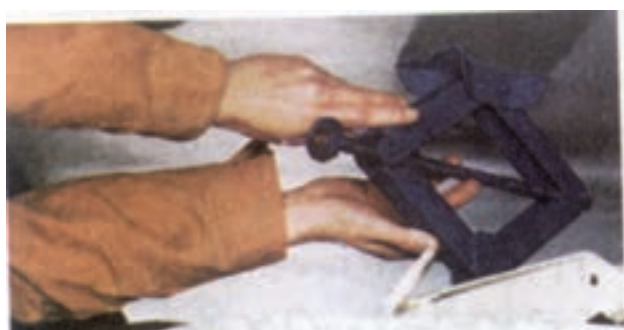
(شکل ۲-۳۸) بالابر مکانیکی قابل حمل
