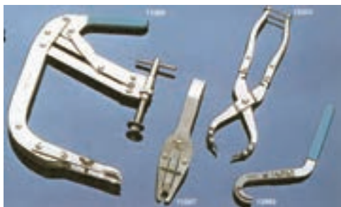
شکل (۱-۷) فنر جمع کن سوپاپ
