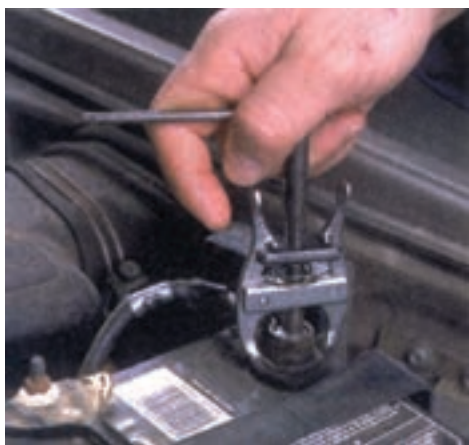
شکل (۸۲ - ۲) باز کردن بست باتری
