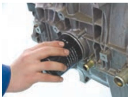
شکل (۲-۵۴) نصب و محکم کردن فیلتر
