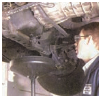
شکل (۲-۵۵) کنترل تخلیه شدن کامل روغن
