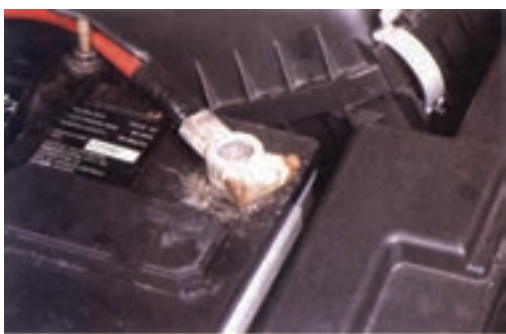
شکل (۸۱ - ۲) سولفاته شدن بست باتری
