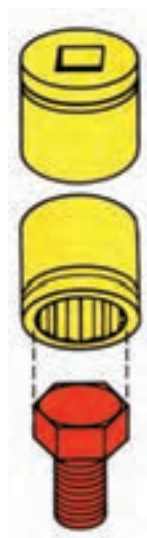
شکل (۱-۱۷) نحوه درگیری آچار بوکس
