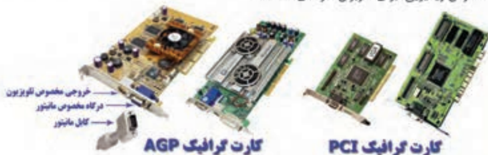
شکل (۶-۱) انواع کارت گرافیک PCI و AGP
