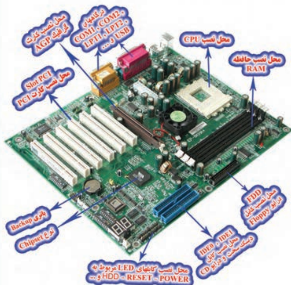
شکل (۵-۱) برد اصلی (Mainboard)
