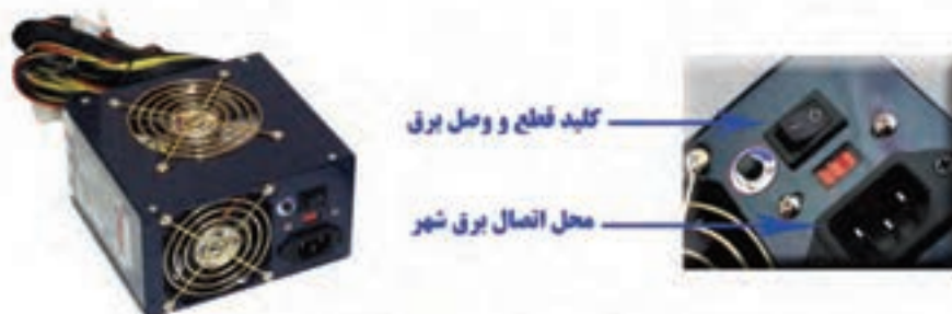
شکل (۲۲-۵) منبع تغذیه یا Power Supply
