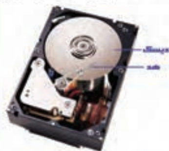
شکل (۴-۷) نمای داخلی دیسک سخت
