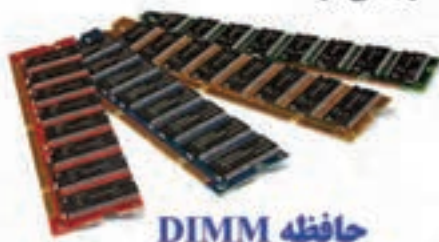
شکل (۵-۴) حافظه DIMM - فن‌آوری SDRAM
