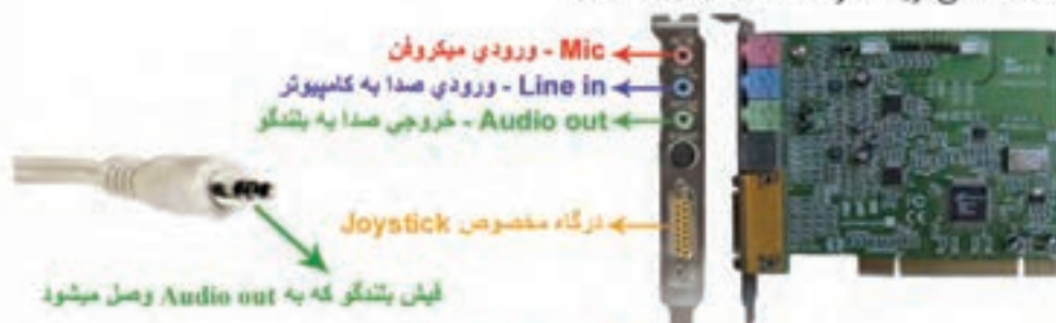
شکل (۴-۵) کارت صدا و اجزای آن
