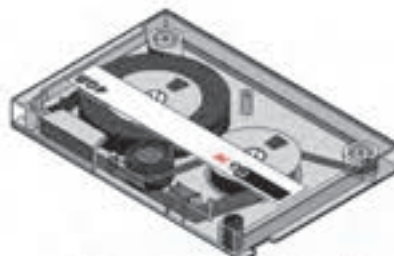
شکل (۴-۱۵) Data Cartridge با ظرفیت ۴ گیگابایت
