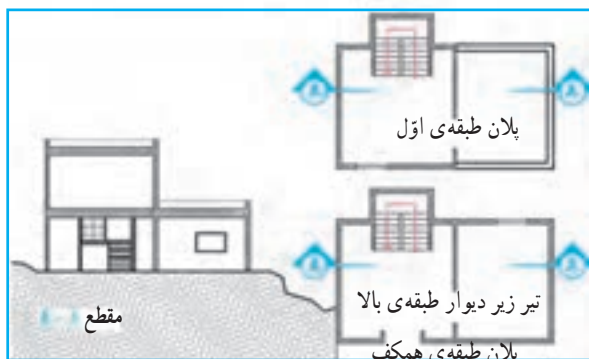
شکل ۱۶-۴- روش ترسیم پلان های طبقات
