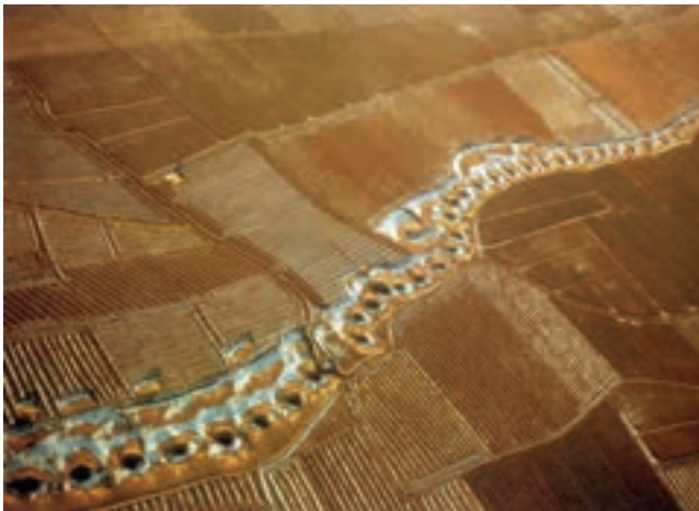
تصویر شماره ۴۸-۲- نمایی از مسیرهای قنات
