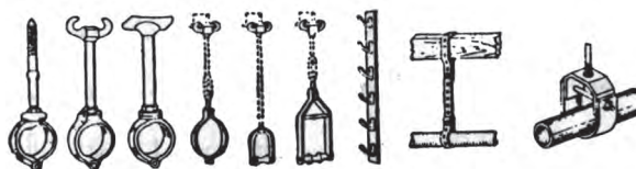
▲ شکل ۱۸-۸ - انواع بست لوله
