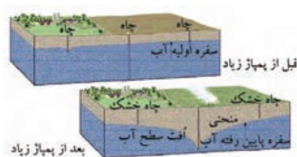
▲ شکل ۳-۵- چاه قبل از پمپاژ زیاد و بعد از پمپاژ زیاد
