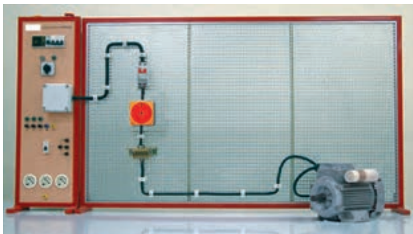
شکل ۲۸-۵- کابل‌کشی و برق‌رسانی به یک موتور تک فاز آسنکرون توسط کلید زبانه‌ای (۱-۵)
