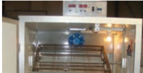
الف) هواکش دستگاه جوجه‌کشی
