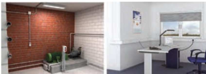
(ب) سیم کشی داخل لوله
