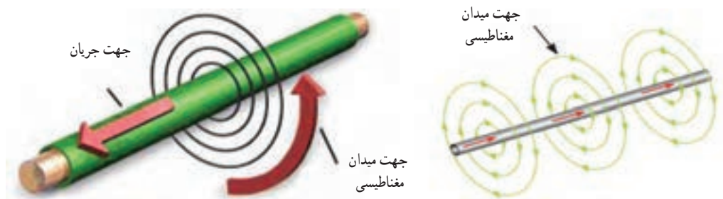
شکل ۴-۴- خاصیت مغناطیسی اطراف سیم حامل جریان
