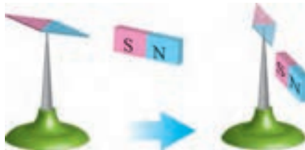
شکل ۲۲-۴- ورق آهنی حرکت آهنربا را دنبال می‌کند.
