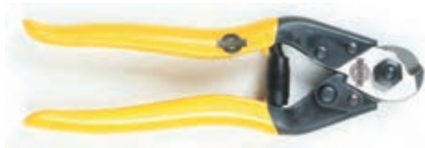
شکل ۳-۳۲- قیچی کابل بری
