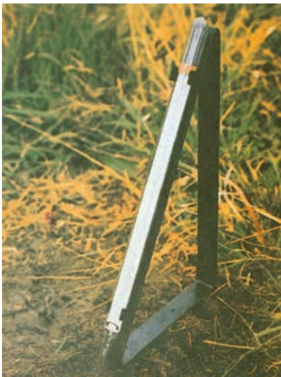
شکل ۱۱-۲- دماسنج برای اندازه‌گیری دمای سطح خاک
