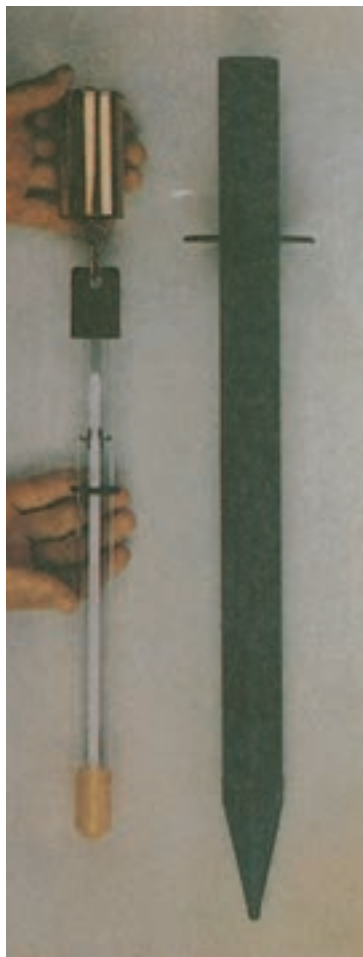
شکل ۱۰-۲- دماسنج برای اندازه‌گیری دمای عمق خاک
