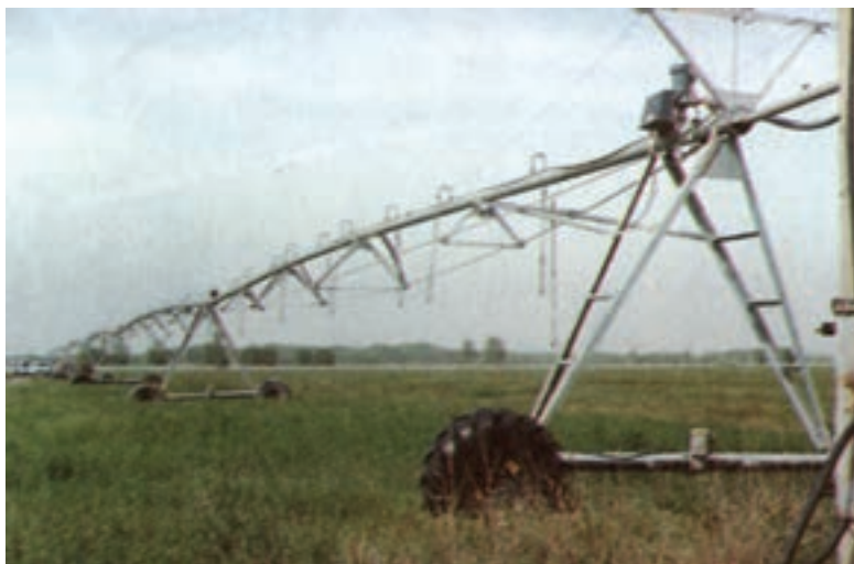
شکل ۹-۲۱- لوله جانبی سیستم سنتریوت
