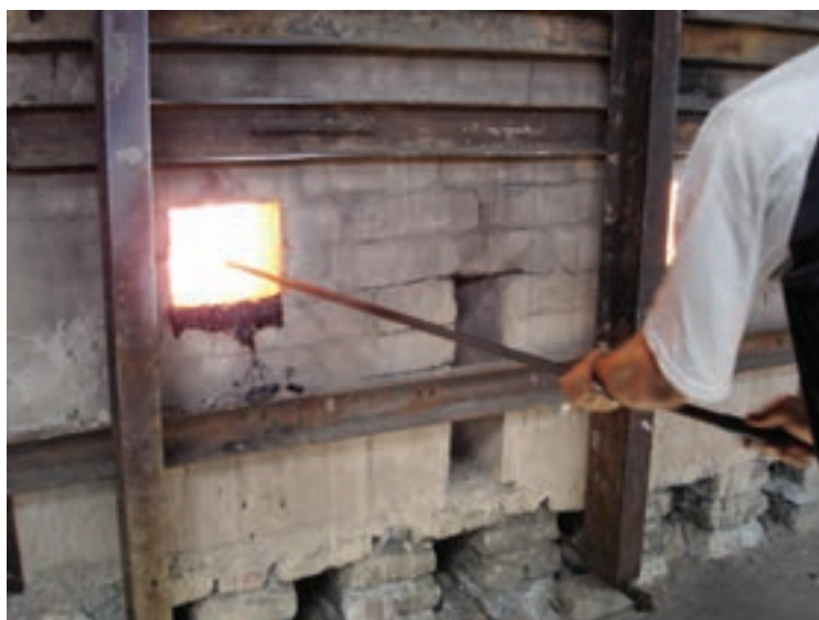
شکل ۷-۶ - مذاب شیشه در کوره (بارگیری)
