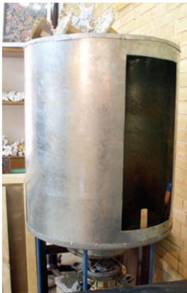
شکل ۹-۱۵- ب- منبع حرارتی و مخزن روغن کلاقی‌ای
