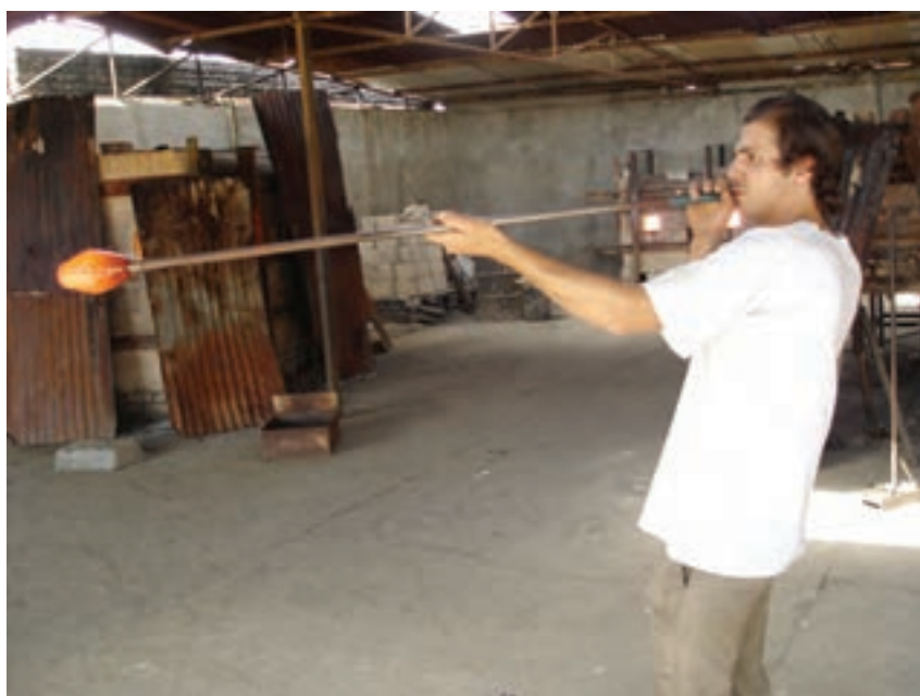
شکل ۹-۷- دمیدن در لوله‌ی دم
