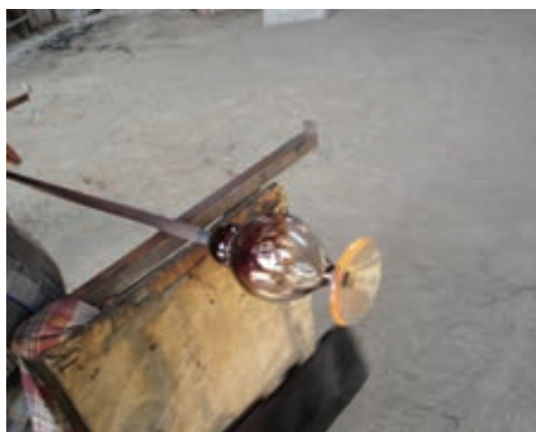
شکل ۱۱-۷- مراحل شکل‌دهی پایه شیء
