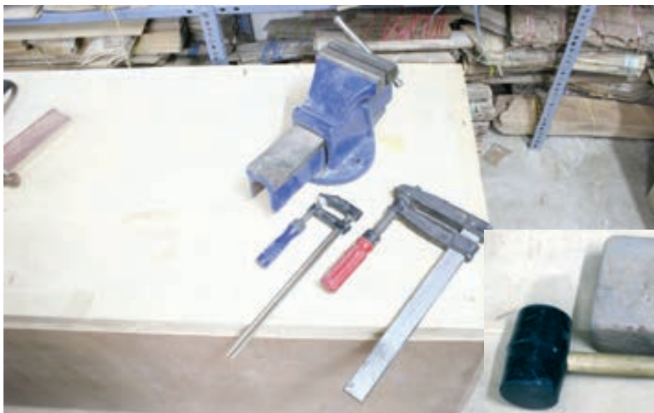
شکل ۸-۸- ابزار و وسایل منبت کاری
