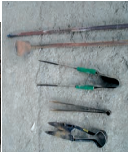
شکل ۷-۴- الف- ابزار و وسایل و تجهیزات شیشه‌گری سنتی - ب کوره شیشه‌گری سنتی
