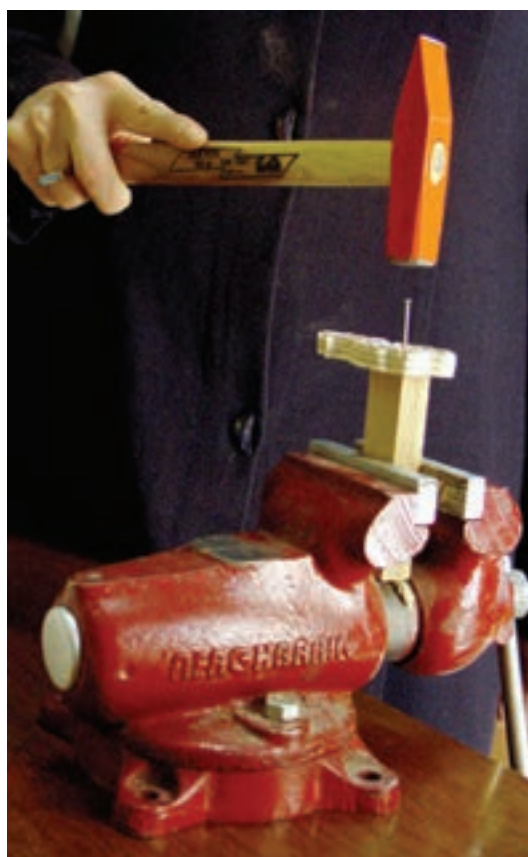
شکل ۱۸-۹- ب - اتصال سر قالب به دسته
