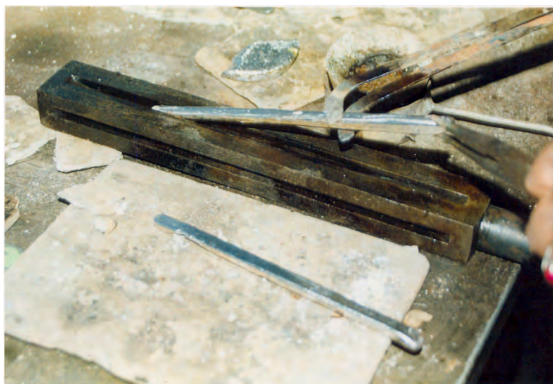
شکل ۱۱-۶-ب - تهیه‌ی شمش از مذاب نقره
