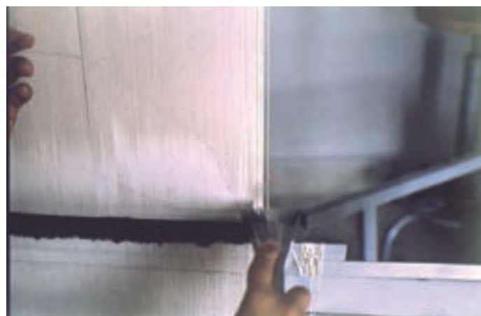
تصویر ۵- ۱۸- عبور پود نازک و شانه
