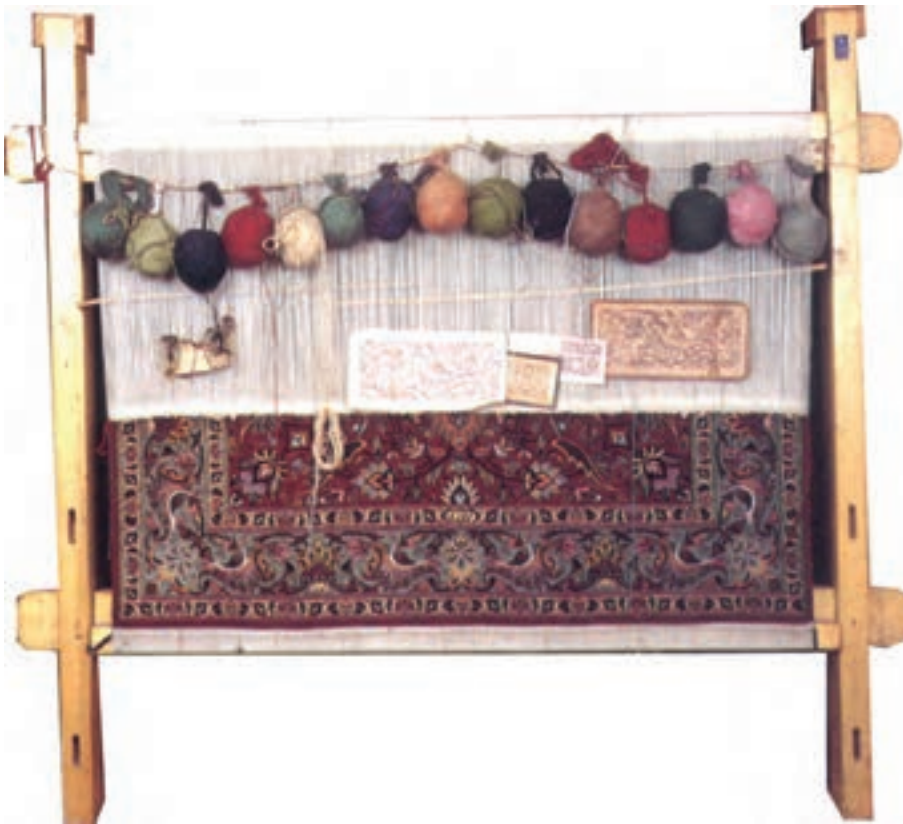
تصویر ۴-۱۲- دستگاه قالی بافی عمودی تبریزی
