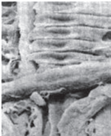
شکل ۱-۳- خمیر چوب آسیا شده با بزرگ‌نمایی ۴۲۰ برابر
