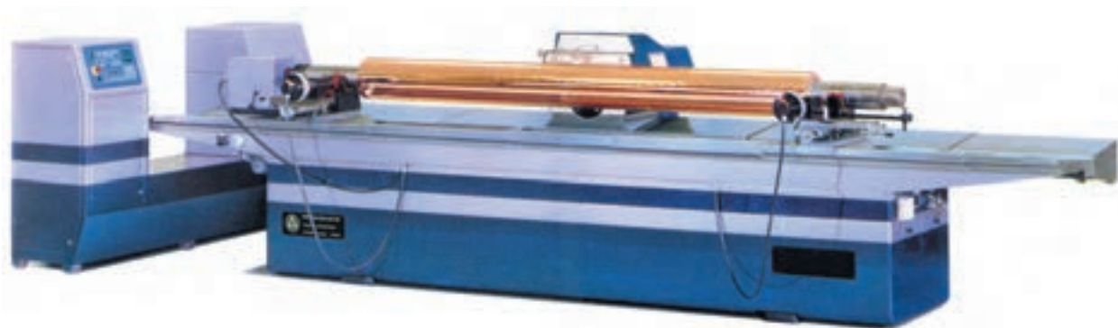
شکل ۵-۸ - دستگاه کپی مستقیم سیلندر
