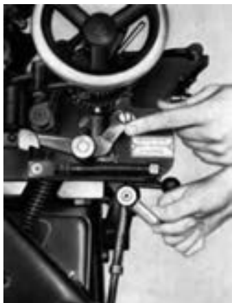
شکل ۴-۷- وصل کردن سیستم مرکب‌دهی
