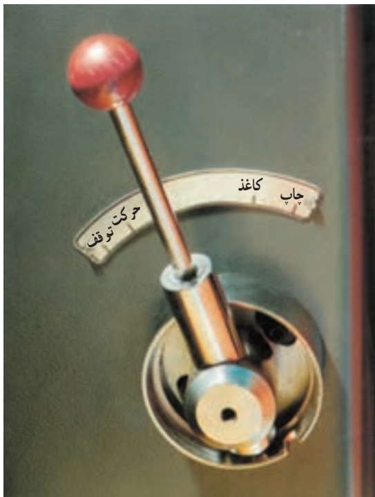
شکل ۱۶-۴- اهرم اصلی راه اندازی ماشین از چپ توقف، حرکت، کاغذ، چاپ
