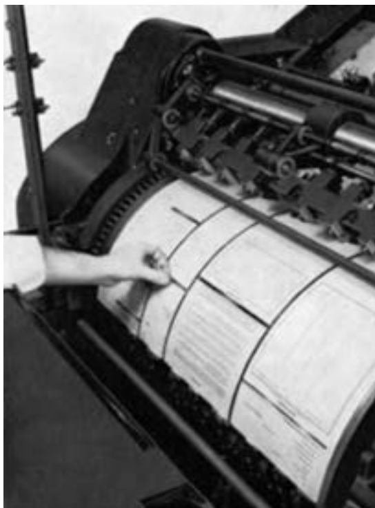
شکل ۴-۴۲- پرفراژ طولی و عرضی در یک مرحله
