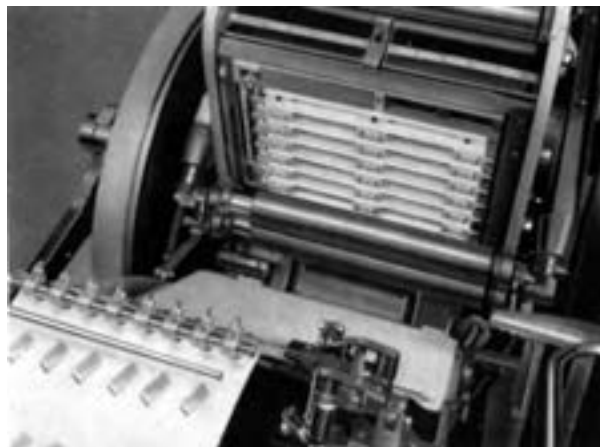
شکل ۳۴-۴- دستگاه شماره‌زنی با کلید غلتکی سمت چپ؛ طول لاستیک نوردها در سمت چپ کوچک‌تر است.
