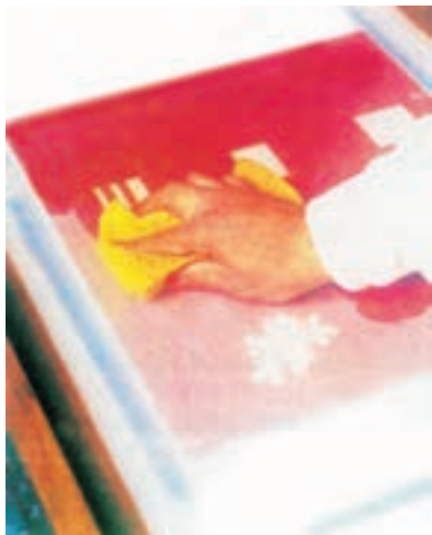
شکل ۸ - ۱۱- عمل آغشته کردن سطح توری با مایع شل کننده ژلاتین
