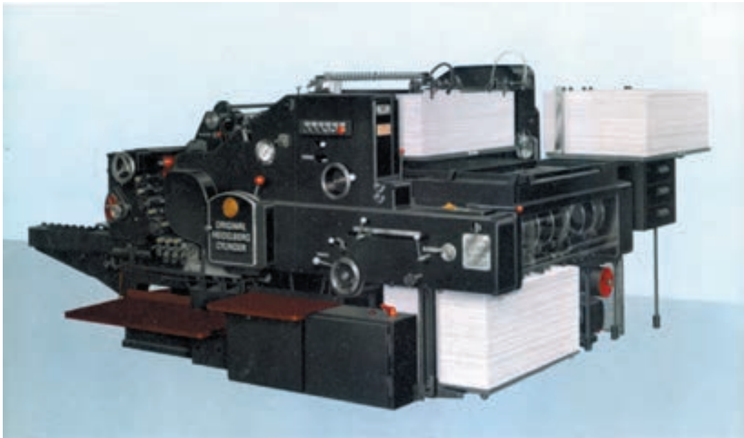
شکل ۹-۲. ماشین سیلندری دو رنگ (گرد و تخت)
