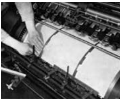
شکل ۴-۴۱- پرفراژ منقطع با نوارهای بریده شده؛ نصفه سمت چپ برُس سیلندر به منظور تنظیم نوار برداشته شده است.
