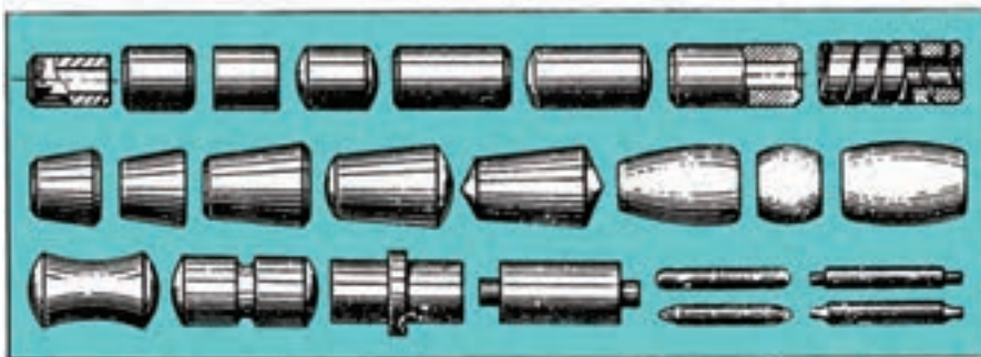
شکل ۲۹-۷- گروهی از غلتک‌های به کار برده شده در رولربرینگ‌ها
