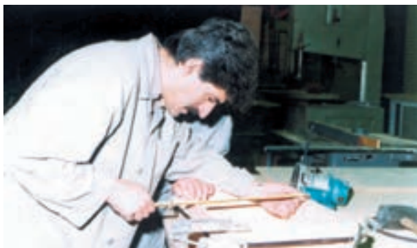
شکل ۲۹- سرهم کردن جعبه و گونیایی کردن آن
