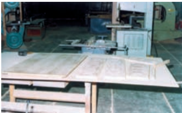
شکل ۱۱- مونتاژ کلاف بدنه
