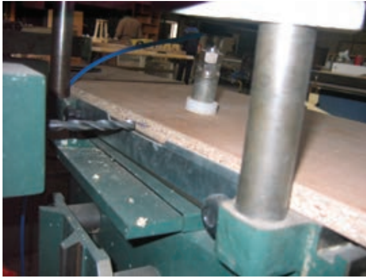
شکل ۱۹- سوراخ نمودن نر نئوپان با ماشین کم کن مته‌ای
