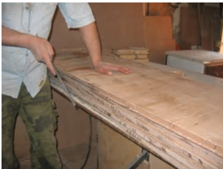
شکل ۲۲- برطرف کردن لبه های اضافی روکش
