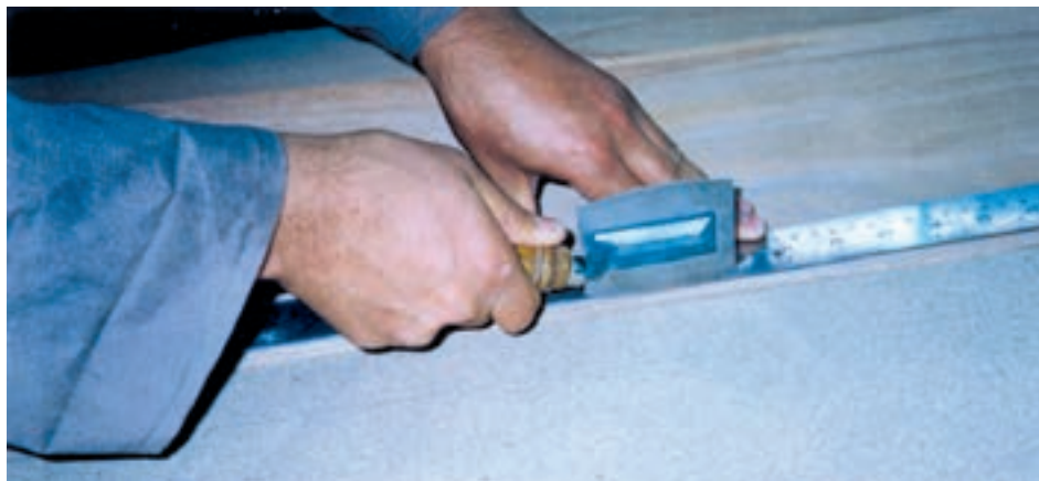
شکل ۱۷- قطع روکش به وسیله‌ی اره‌ی روکش‌بری
