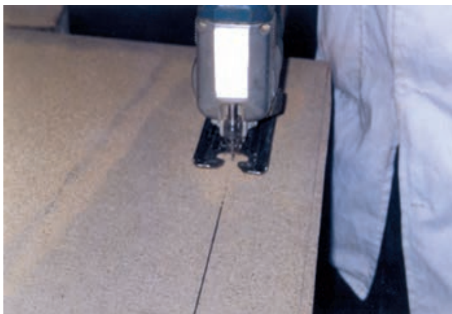
شکل ۲- بریدن نئوپان با اره‌ی عمودبر
