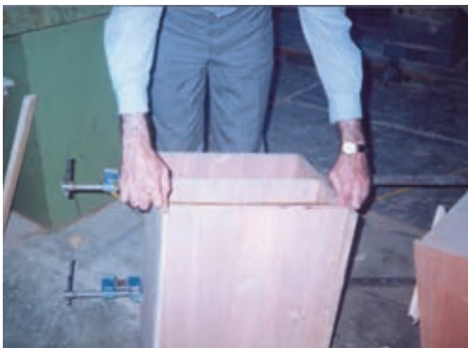
شکل ۲۸- اندازه‌زدن فاصله بین دو بدنه برای به دست آوردن طول در جعبه
