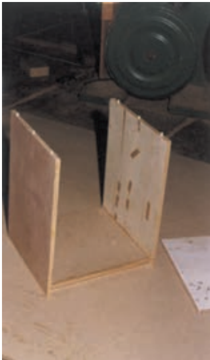
شکل ۲۰- مونتاژ کف و بدنه
