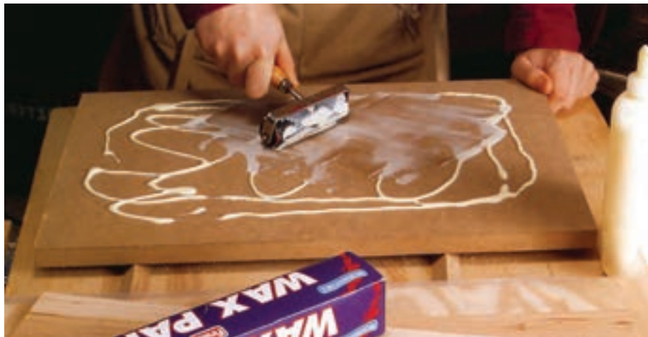
شکل ۷- عملیات چسب‌زنی نئوپان برای روکش‌کاری
