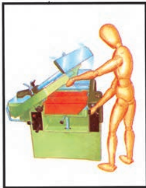
شکل ۷-۵- تنظیم دستگاه گندگی
