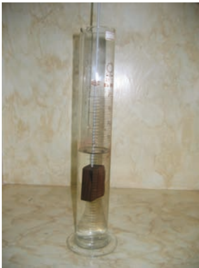
شکل ۳-۴- روش تعیین حجم با اندازه‌گیری اختلاف سطح آب در استوانه مدرج
