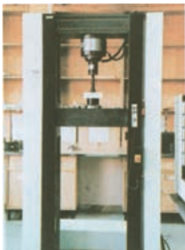
شکل ۲-۱۱- نحوه آزمایش سختی در دستگاه
