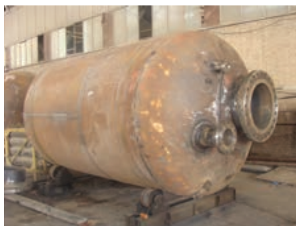
شکل ۳-۳ ساخت مخزن تحت فشار
