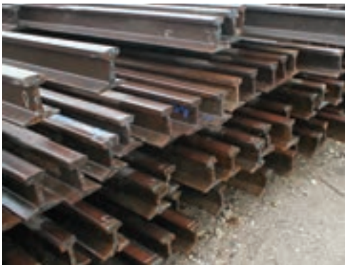
شکل ۸-۲۳- بعضی از محصولات فولادی تولید شده به وسیله عملیات نورد
