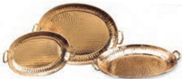
شکل ۱۳-۳- ظروف مسی ساخته شده به وسیله چکش کاری
