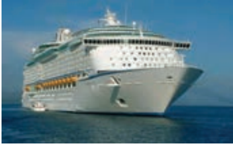
شکل ۹-۲- کشتی مسافربری ساخته شده از آلیاژهای آلومینیومی
