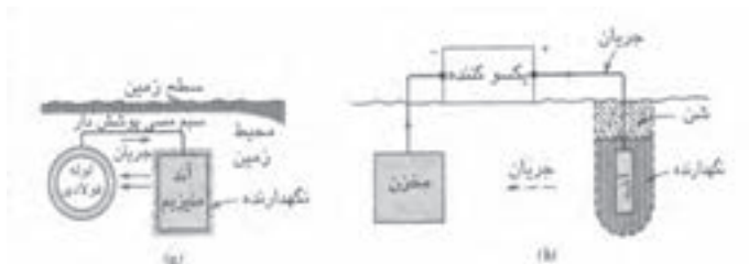
شکل ۷-۲۹- سیستم حفاظت کاتدی برای حفاظت سازه‌های مدفون در خاک (b- حفاظت مخزن از طریق اعمال جریان مستقیم (DC) a- حفاظت خطوط لوله از طریق کار گذاشتن آند جداشونده منیزیمی در مجاورت آن
