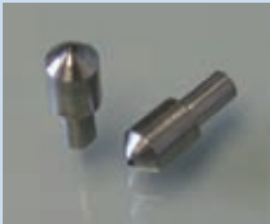
شکل ۲۱-۳- نمونه‌ای ابزار فرورونده جهت اندازه‌گیری سختی
