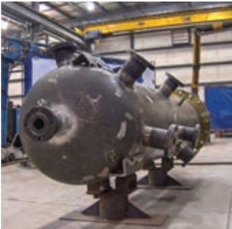
شکل ۷-۲۴- مخزن تحت فشار که ممکن است برای انجام فعل و انفعال شیمیایی در دمای بالا به کار گرفته شود.
