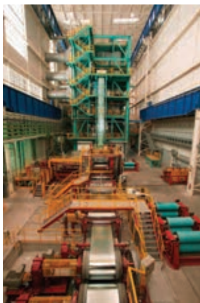
شکل ۸-۶. خط گالوانیزه کردن ورق و قوطی‌های فولادی
