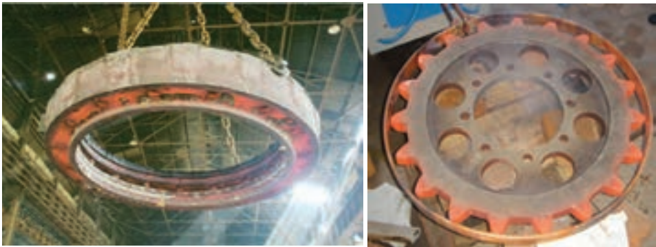
شکل ۳-۴- عملیات حرارتی سخت‌کاری سطح چرخ‌دنده بزرگ فولادی
