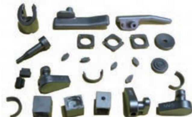
شکل ۸-۲۸- نمونه‌هایی از قطعات صنعتی تولید شده به روش متالورژی پودر
