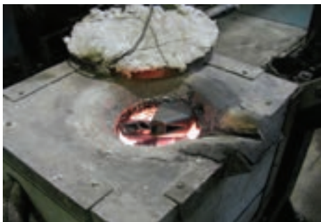
شکل ۸-۱- کوره ذوب و فولادسازی در یک واحد ریخته‌گری کوچک
