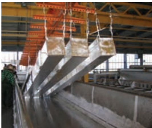
شکل ۸-۶. خط گالوانیزه کردن ورق و قوطی‌های فولادی
