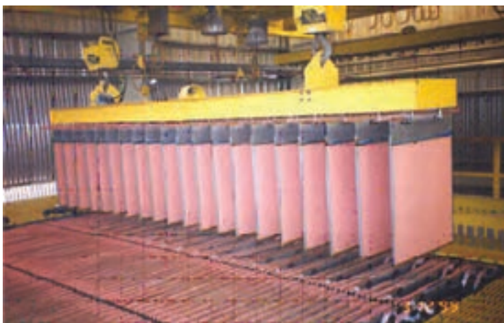
شکل ۱۷-۲. ورق های مسی تولید شده در کارخانه الکترووینینگ مجتمع مس سرچشمه
