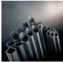
شکل ۲۷-۸- پروفیل‌های مختلف فلزی تولید شده به روش اکستروژن
