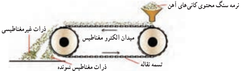
شکل ۲-۵- جداسازی کانی‌های فرومغناطیس آهن از مواد باطله
