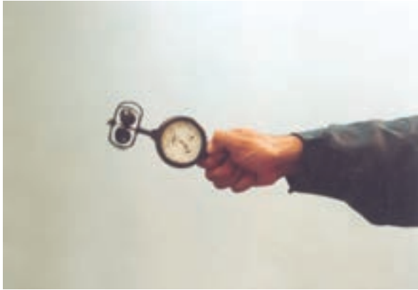
شکل ۸-۹ - طرز گرفتن هواسنج در مسیر جریان هوا
