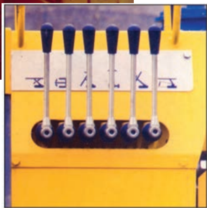
شکل ۱۳-۳- اهرم های کنترل کننده
