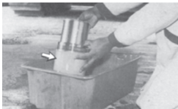
شکل ۸۰-۶- بستن واشر آب‌بندی فیلتر نو
