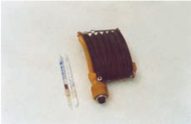
شکل ۱۱-۷- اجزای دستگاه گازسنج
