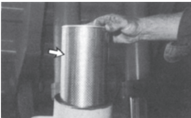
شکل ۶-۷۸- قرار دادن صافی تمیز در مخزن
