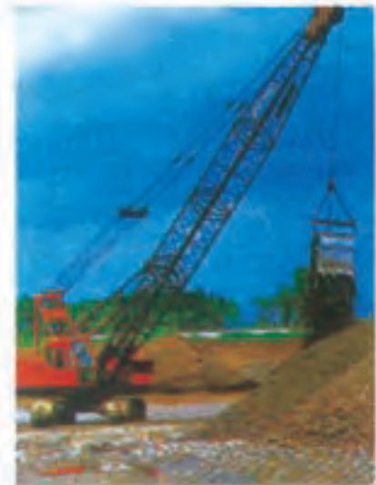
شکل ۲-۲: اسکاواتور چرخ زنجیری KHT۳۰۰ هیتاچی با موتور دیزلی
