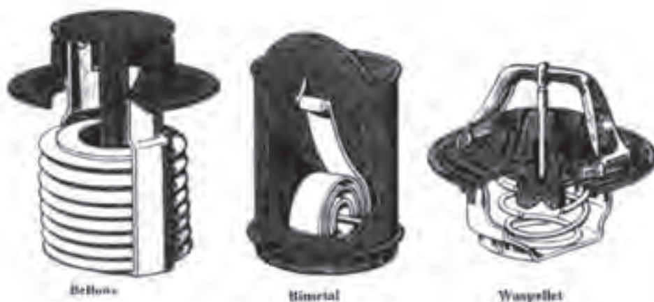
شکل ۶-۵ ساختمان انواع ترموستات (موتور شورولت)
