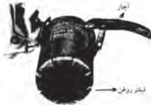
نحوه باز کردن فیلتر روغن
