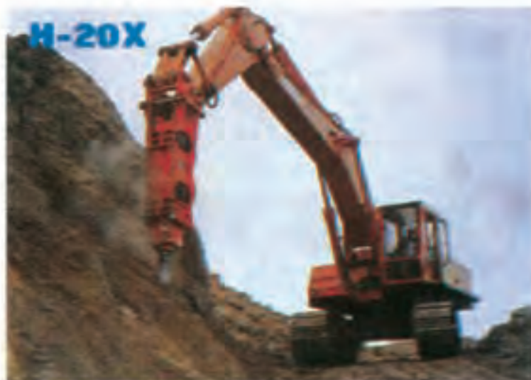
نوع سنگ خردکن هیدرولیک با نیروی حرکتی موتور دیزلی قابل استفاده در معادن
