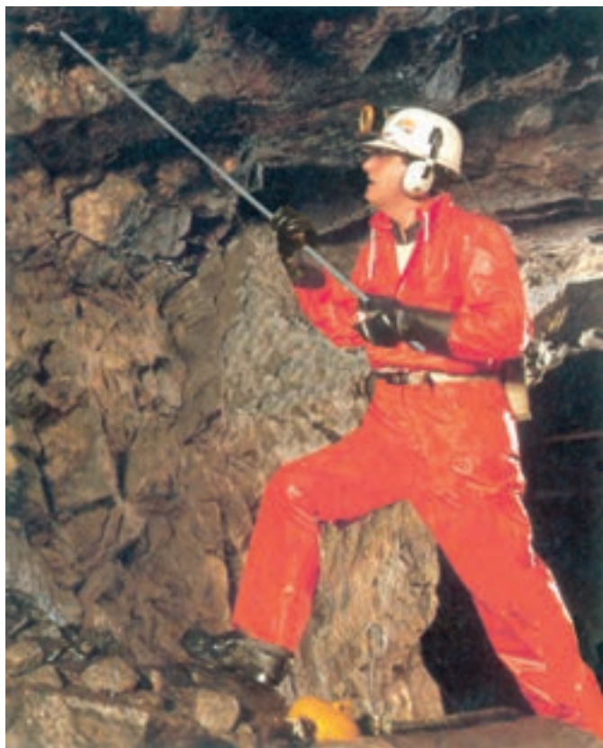
شکل ۲-۱۷- انجام لق‌گیری توسط کارگر
