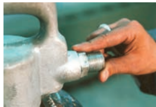
شکل ۱۱-۳- نحوه‌ی جا زدن فنر و ساچمه و بستن بوشن صافی‌دار
