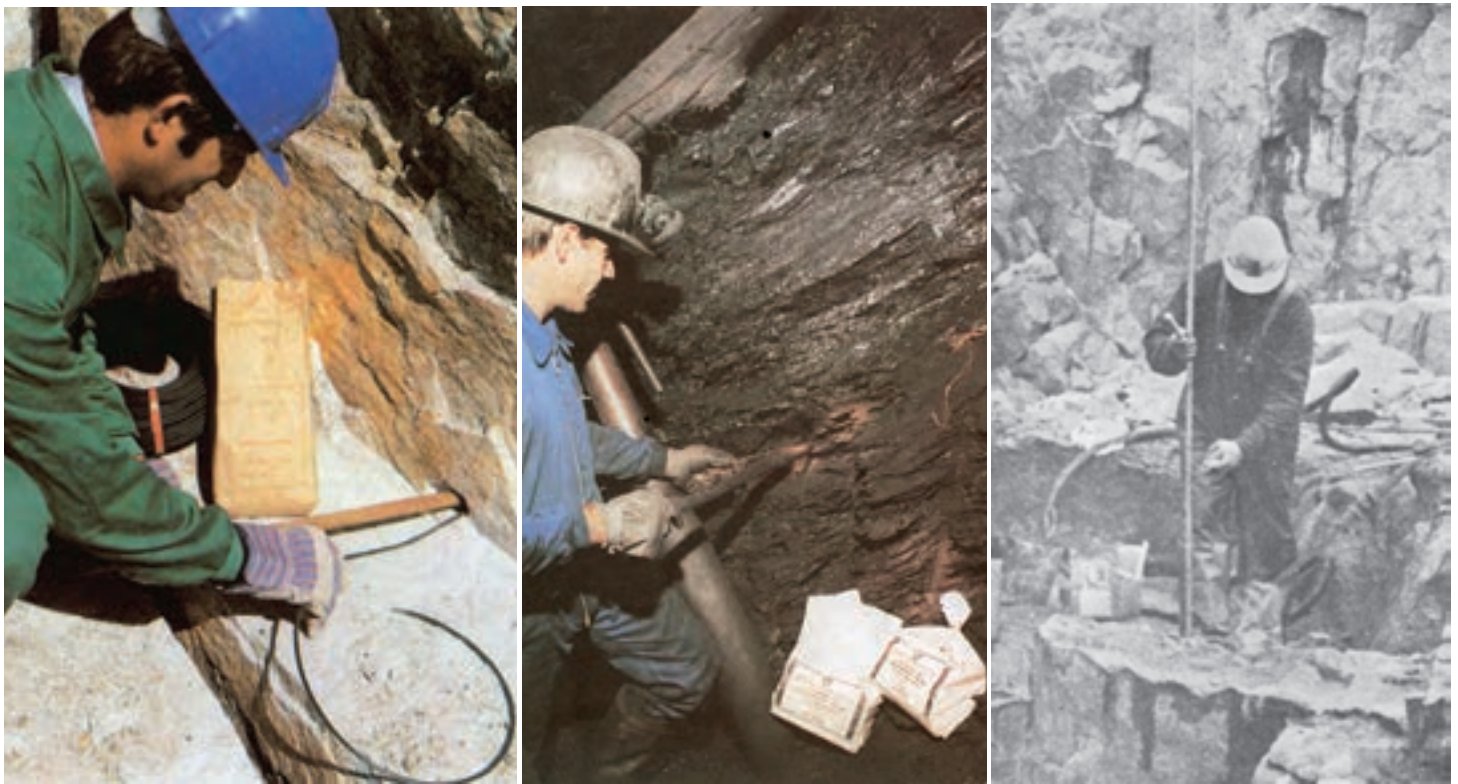
شکل ۱-۱۶- نحوه‌ی کار کردن با سنبه‌ی چوبی و پلاستیکی
