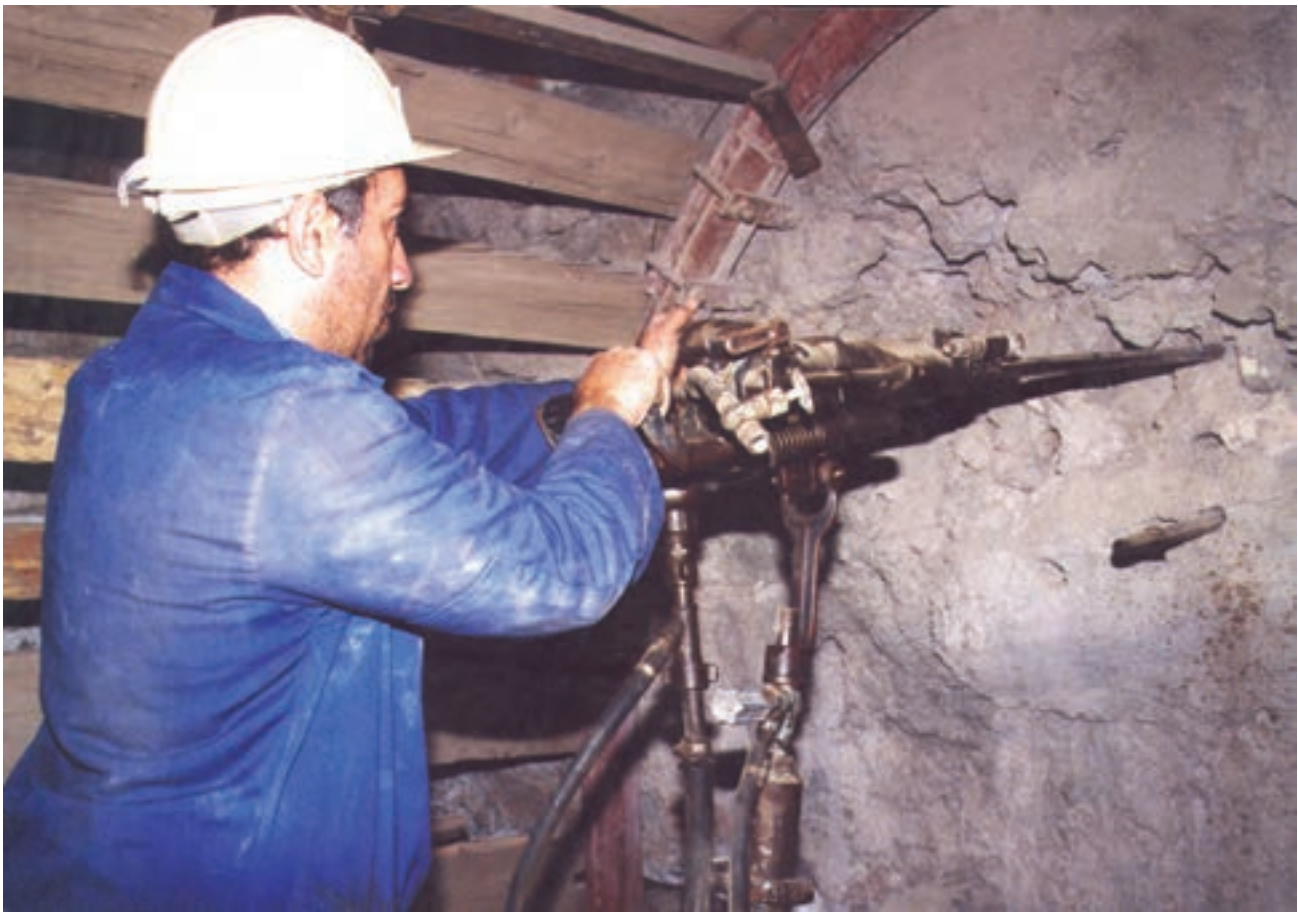
شکل ۲۷-۲- نحوه‌ی به‌کارگیری پرفوراتور
