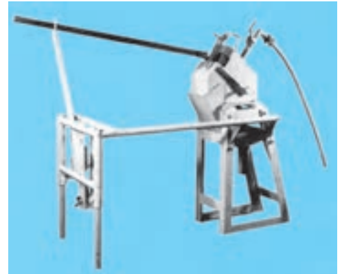
شکل ۸-۱۳- نحوه تیز کردن دکمه‌های سر مته
