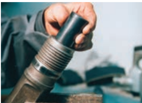
شکل ۱۸-۳- نحوه ی جازدن بیستون
