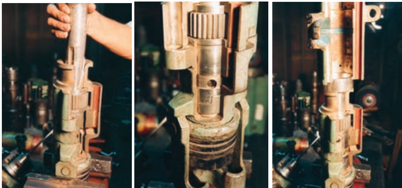
شکل ۱۸-۴- نحوه‌ی جازدن پیستون و پوسته آن
