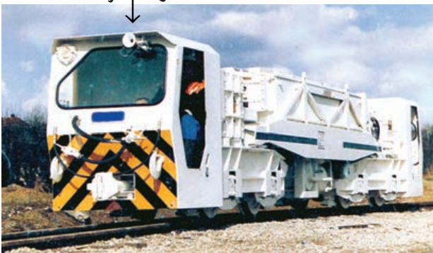
شکل ۶-۳۲- لوکوموتیو معدنی قسمت علامت‌دار زنگ خطر
