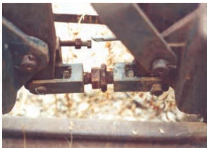
شکل ۲-۳۲- نحوه‌ی عملکرد ترمز لوکوموتیو
