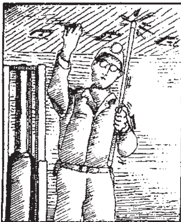
شکل ۷-۱۷- یک معدن‌چی در حین آزمایش سقف
