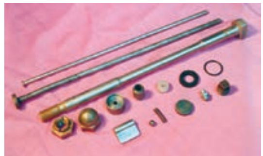
شکل ۴-۴- متعلقات پرفوراتور (اجزای پیچ و مهره و پاول و...)
