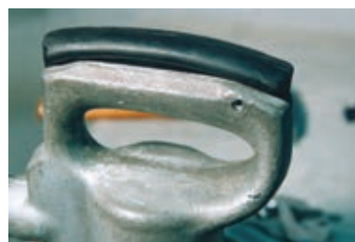
شکل ۱۳-۳- نحوه‌ی جازدن سوزن هوا و دستگیره‌ی لاستیکی
