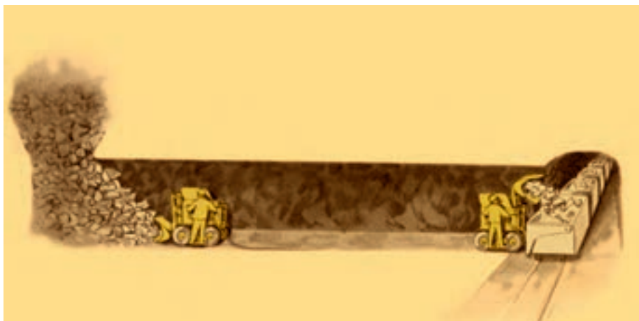
شکل ۶-۳- مراحل کارکرد لودر تونلی (خاک بر سر)
