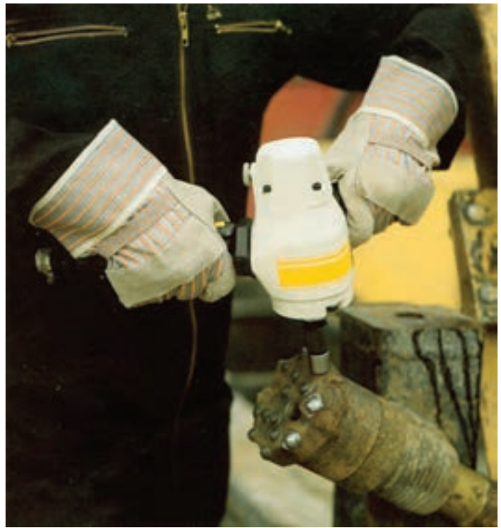
شکل ۸-۱۳- نحوه تیز کردن دکمه‌های سر مته
