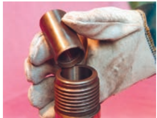
شکل ۱۶-۳- نحوه ی جازدن بوشن قلم گیر پیکور
