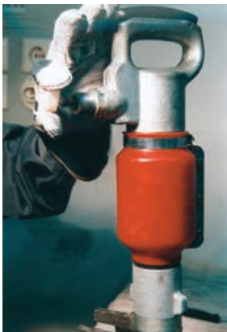
شکل ۲۹-۳- نحوه‌ی جا زدن درپوش جلوگیری از ورود گرد و غبار به دستگاه
