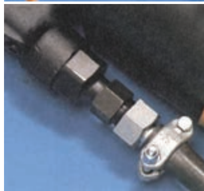
شکل ۴۳-۳- نحوه‌ی بستن پیچ و مهره بست شیلنگ
