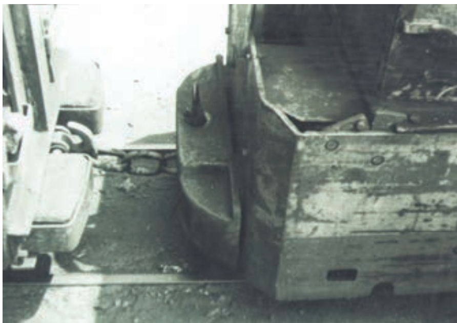
شکل ۱۶-۳۲- زنجیر و قلاب اتصال لوکوموتیو و واگن
