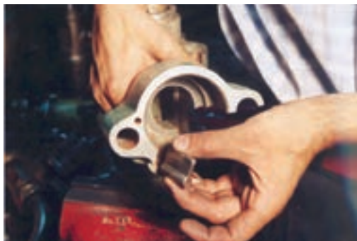
شکل ۱۶-۴- نحوه‌ی جازدن پاول و فنر و ساچمه
