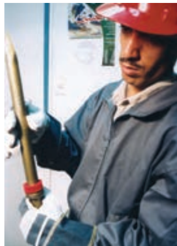
شکل ۲۵-۳- چگونه‌ی جازدن لاستیک ضربه‌گیر و عبور دادن قلم از سریک
