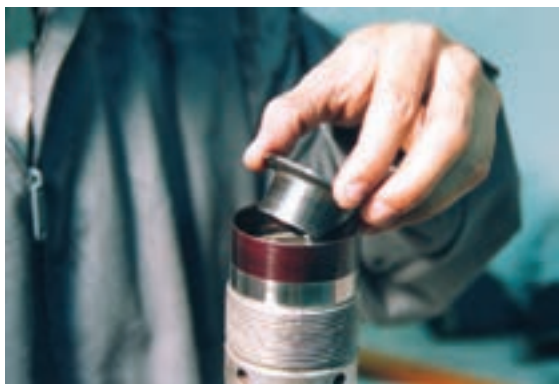
شکل ۳-۲۲- نحوه‌ی جا زدن سوپاپ
