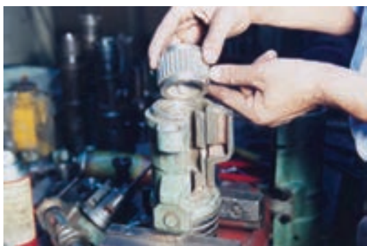
شکل ۱۷-۴- نحوه‌ی جازدن جفجغه
