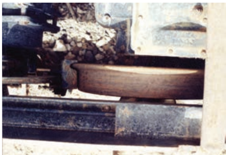
شکل ۳-۳۲- نحوه‌ی عملکرد کفشک‌های ترمز بر روی چرخ
