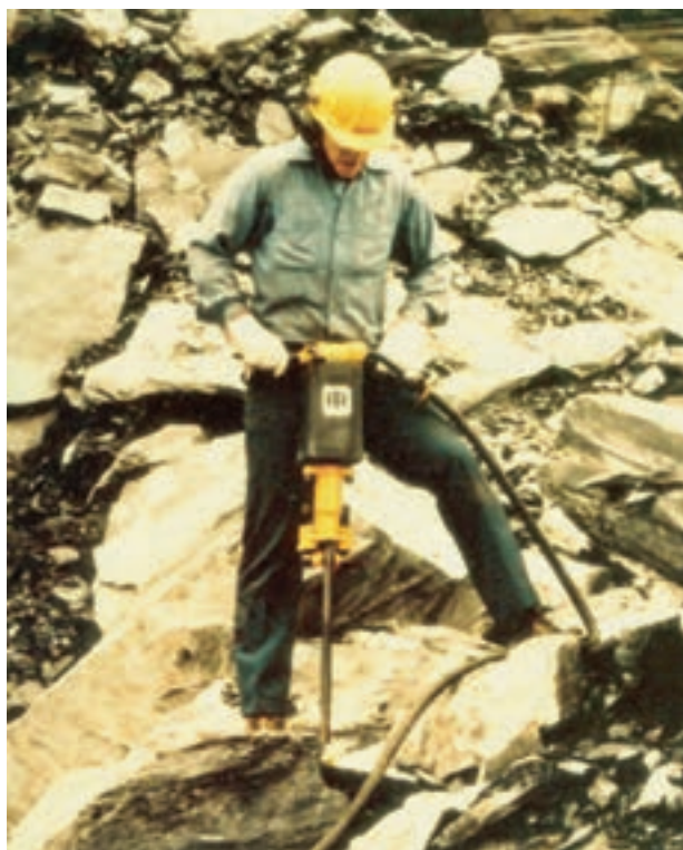
شکل ۵۳-۳- نحوه‌ی پیکور کاری
