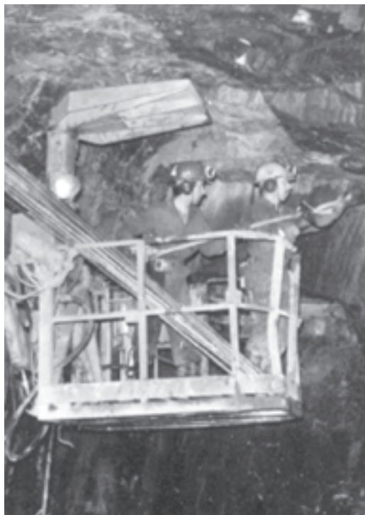
شکل ۲-۲۸- طریقه‌ی نصب پیچ سنگ
