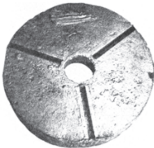
شکل ۲-۶- نمونه از قطعه‌ای با عیوب آخال و مک‌های میکروسکوپی
