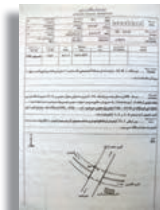
شکل ۹ - ۶. بنچ مارک ترازایی و شناسنامه‌ی آن
