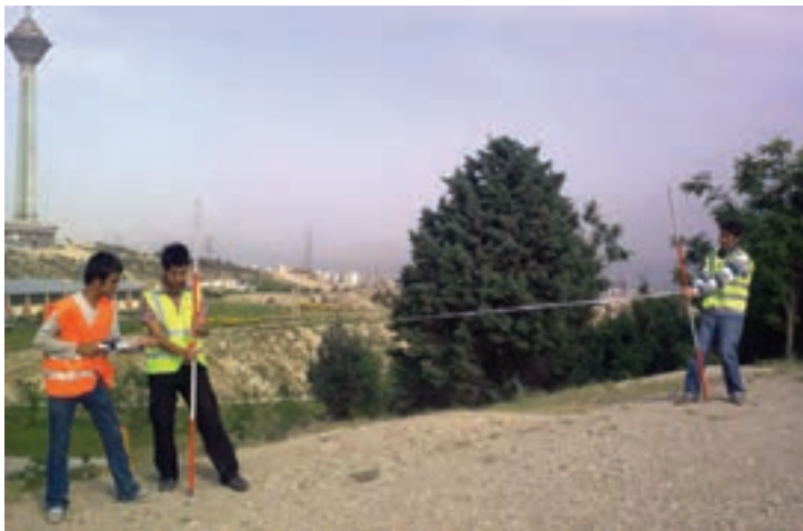
شکل ۲- ۱۱. کشش نامناسب متر
