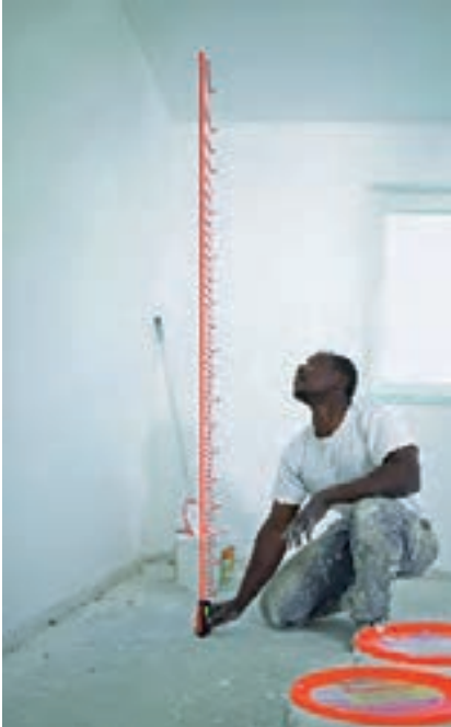
شکل ۱- ۱۰. دیستومتر و کاربرد آن
