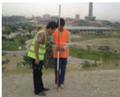
شکل ۲ - ۱۴. زاویه صحیح قرائت متر
