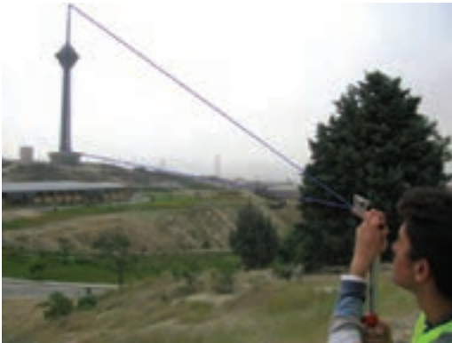
شکل ۱ - ۱۵. شیب سنج و کاربرد آن
