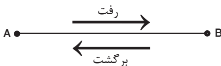
شکل ۲ - ۱۳. مترکشی به صورت رفت و برگشت
