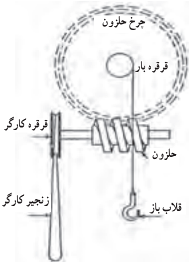
شکل ۲۱-۵- میله حلزون و چرخ حلزون بالابر
