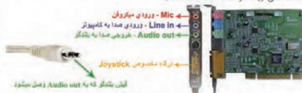
شکل (۴-۵) کارت صدا و اجزای آن
