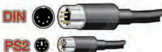
شکل (۱۴-۵) درگاه DIN و PS2
