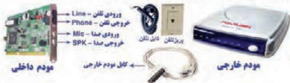
شکل (۴-۶) مودم داخلی و خارجی و اجزای آن
