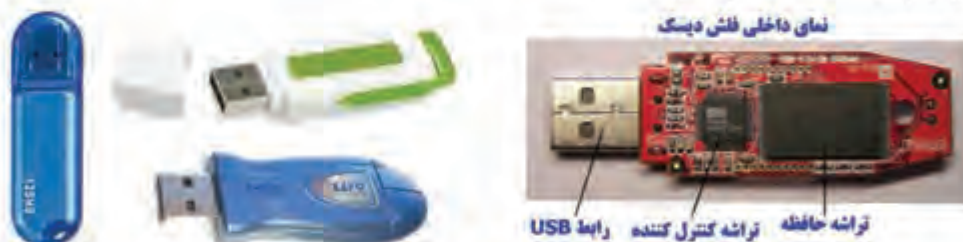
شکل (۴-۱۶) نمونه های از Flash Disk و نمای داخلی آن
