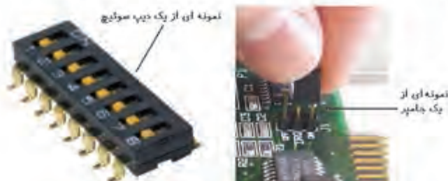
شکل (۵-۱۹) جامپر و دیپ سوئیچ
