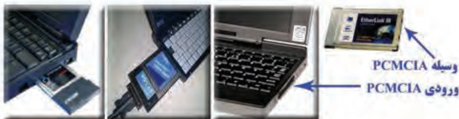
شکل (۵-۱۷) ورودی PCMCIA و کارت شبکه PCMCIA
