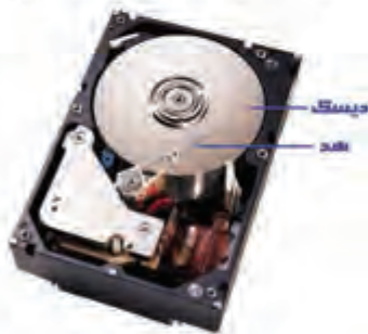
شکل (۴-۷) نمای داخلی دیسک سخت
