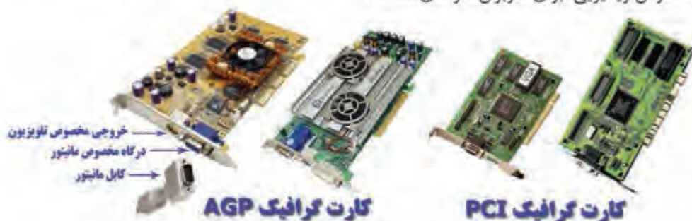
شکل (۶-۱) انواع کارت گرافیک PCI و AGP
